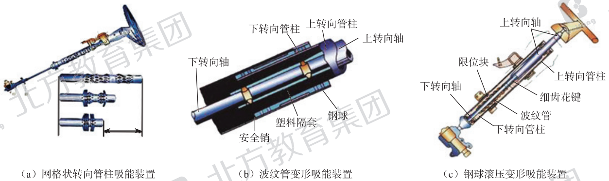
图4 缓冲吸能式转向操纵机构结构示意图
