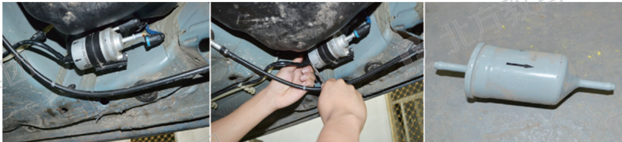
图 1 拆下与燃油滤清器相连接的进、回油管，拆下燃油滤清器
