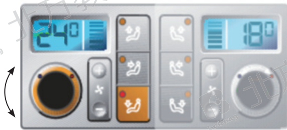
图 38 左后乘员空气调节区的设定温度为 24℃ (启用了自动空气调节功能)
