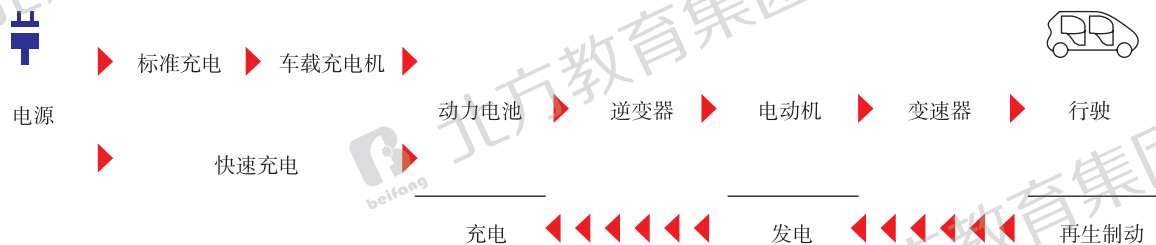
图 1 电动汽车能量转换图
