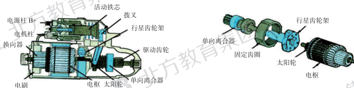
图 3 行星齿轮减速起动机剖面图
