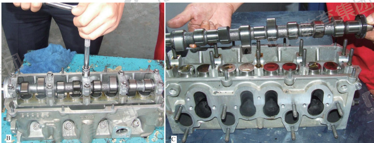
图 5 凸轮轴的拆卸
