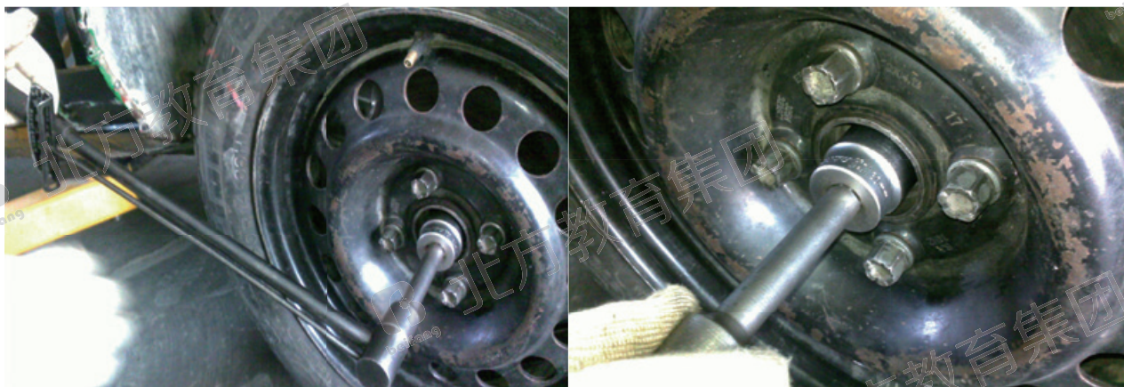
图1 拧松外球笼紧固大螺母
