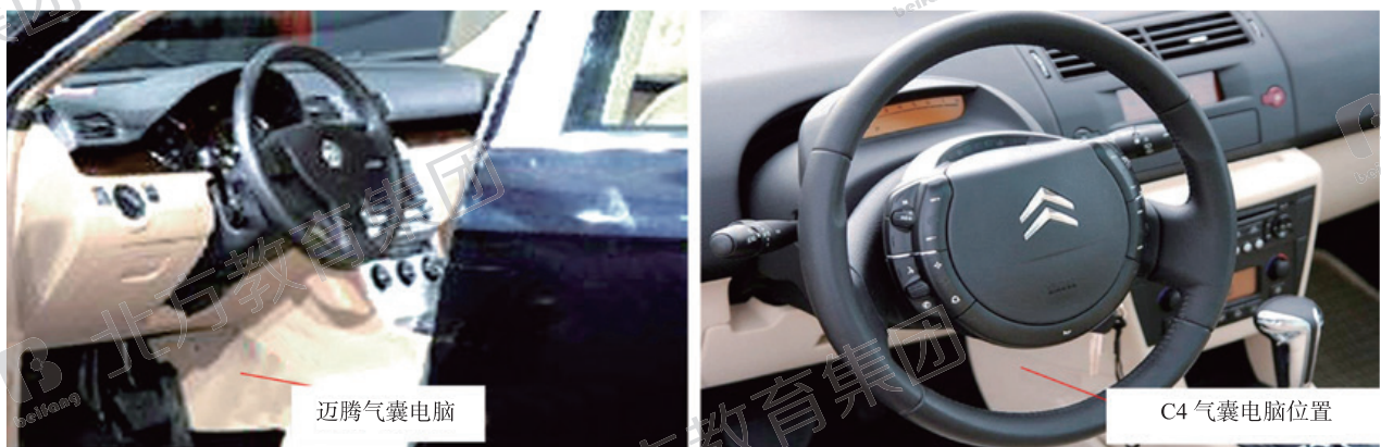
图 15 迈腾和雪铁龙 C4 气囊电脑位置
