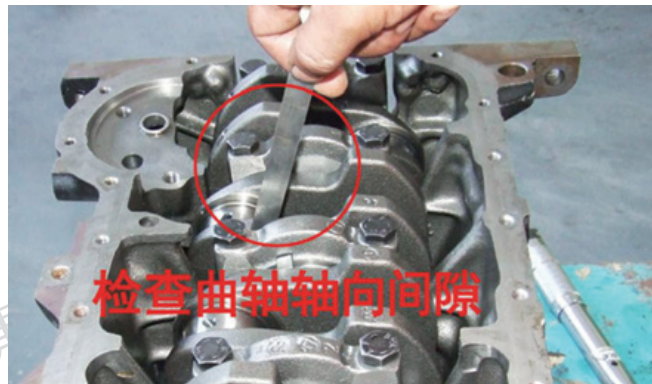
图 4 曲轴轴向间隙的检测
