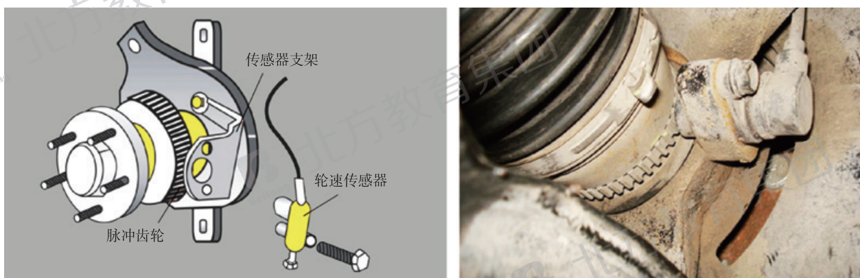
图 4 径向安装示意图
