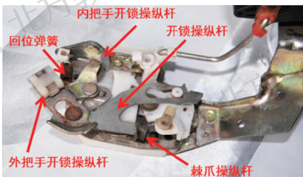
图 3 车门锁构造示意图
