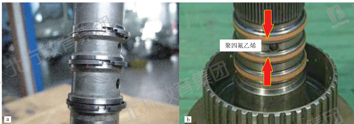
图 11 离合器的进油和进油口两侧的密封圈
