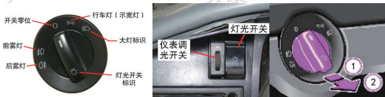
图5 与变光开关分体的灯光开关
