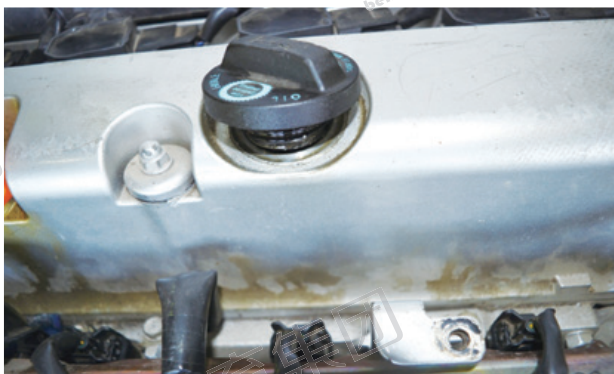
图 2 拧下润滑油加油螺塞
