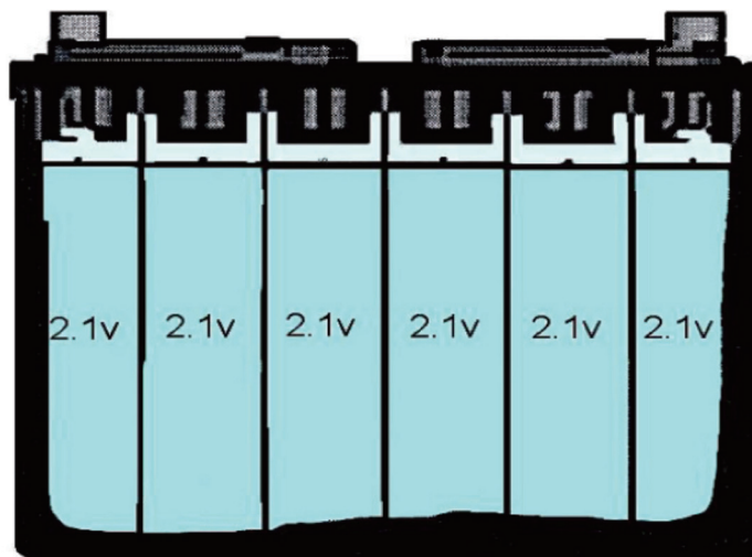
图 2-2-7 单格铅酸电池的结构
