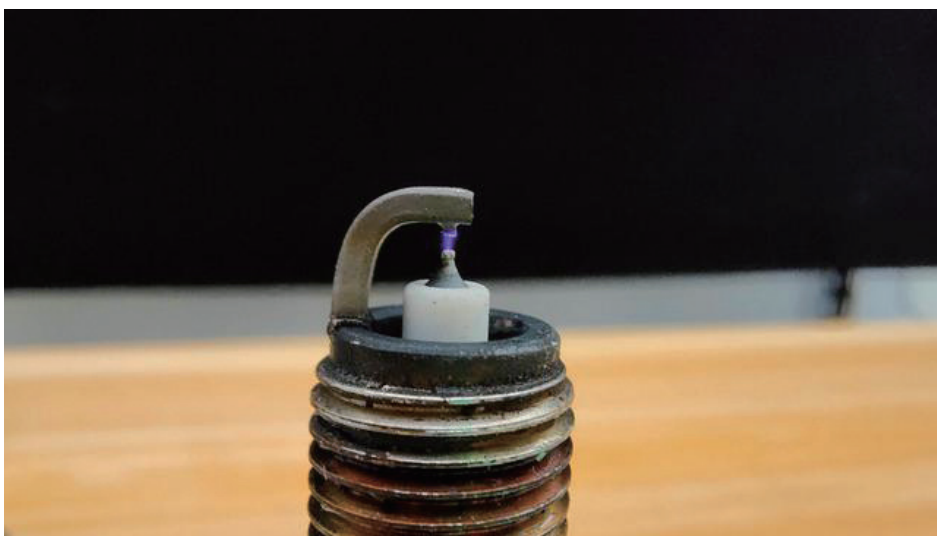
图 5-1-7 火花塞产生电弧
