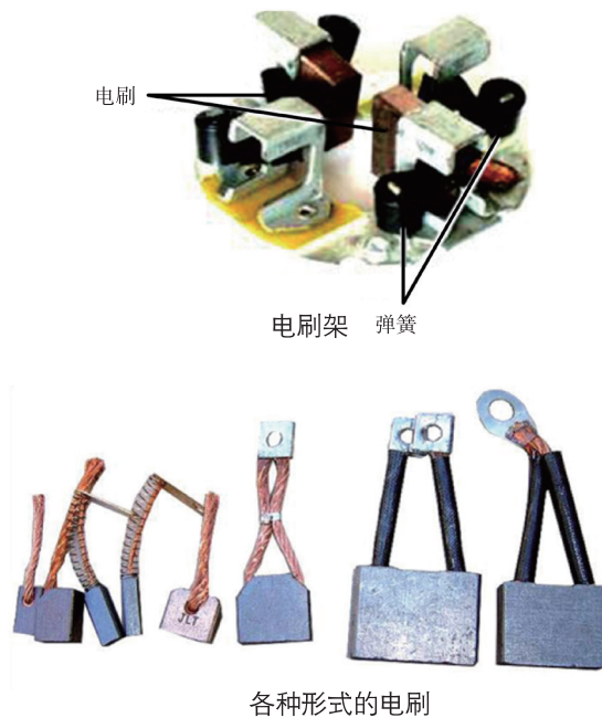
图 4-1-10 电刷与电刷架
