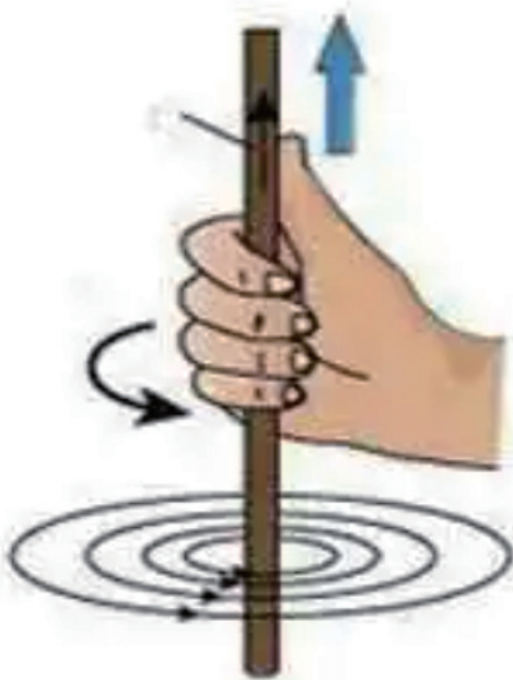
图 3-1-2 通电直导体周围磁场方向的判断
