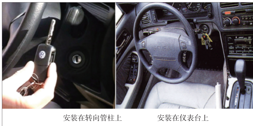
图 4-1-21 点火开关安装位置
