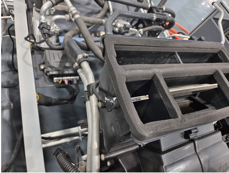
图 7-2-12 空调压力传感器
