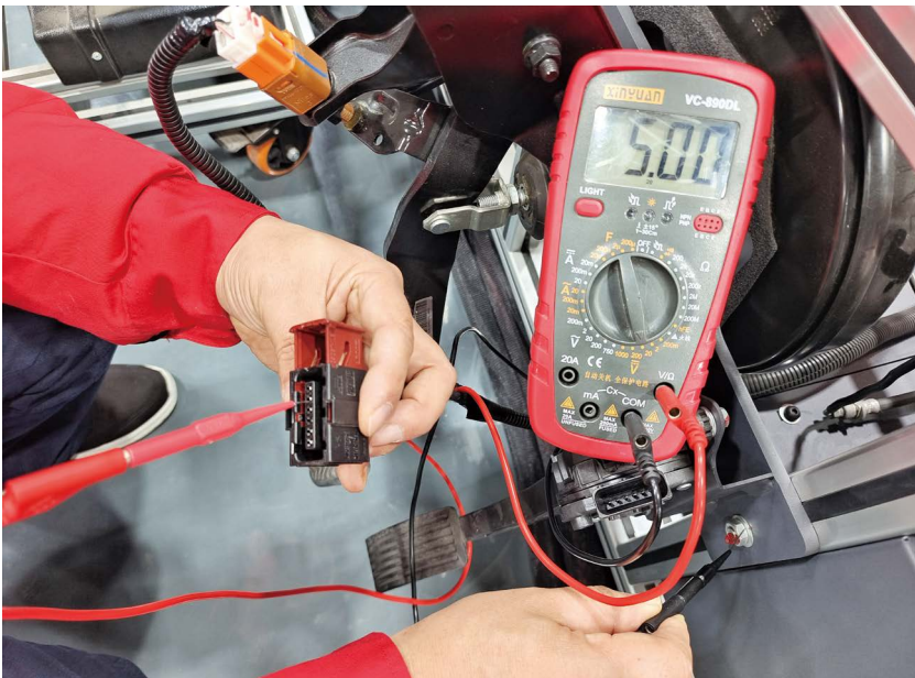
图 1-2-20 G44 插头的 2 号端子测量
