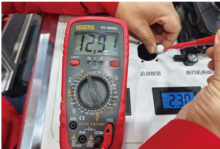
图 1-1-16 G16 插头的 4 号端子测量
