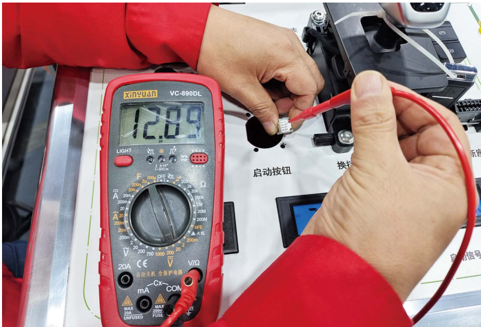
图 1-1-15 G16 插头的 2 号端子测量
