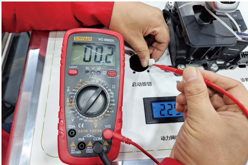
图 1-1-18 G16 插头 8 号端子测量
