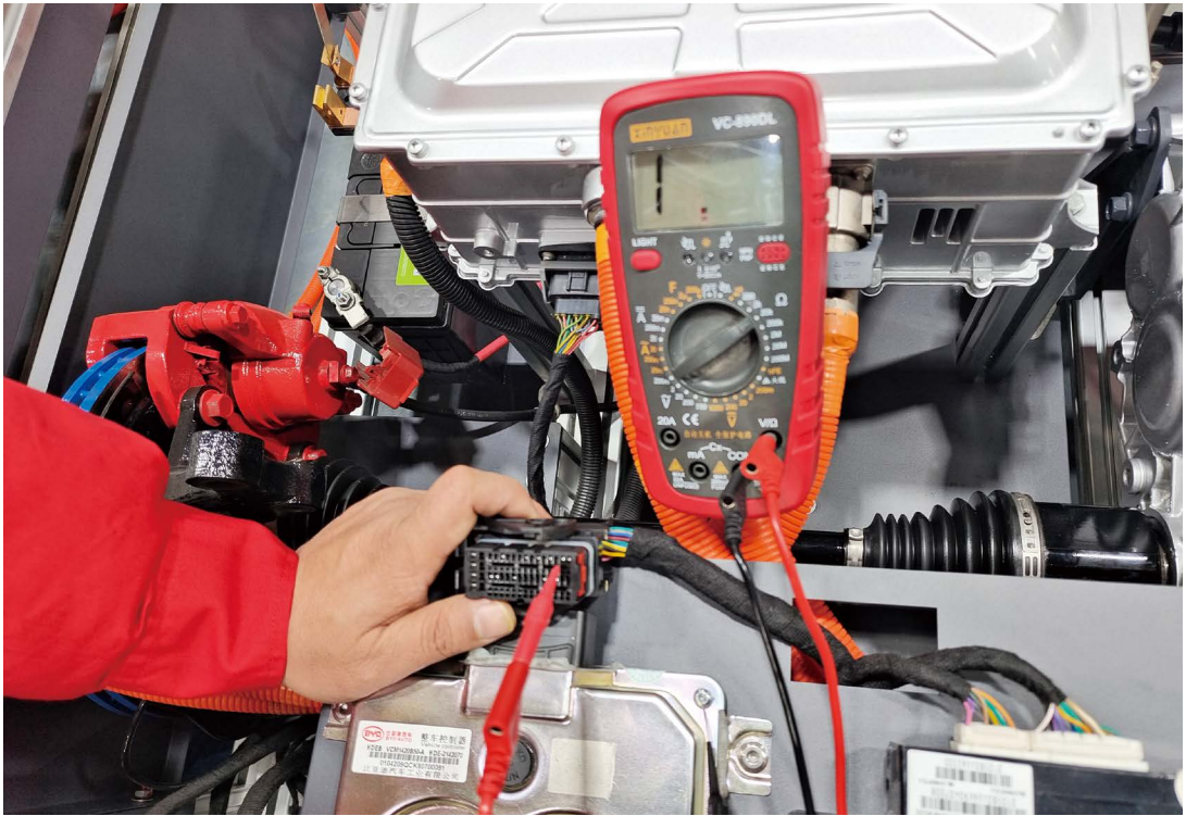
图 1-1-28 GK49 插头的 21 号端子对地阻值的测量
