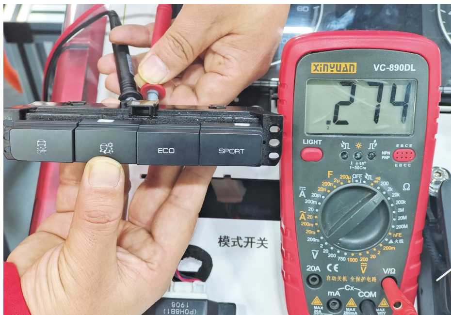
图 1-2-28 G73 的 2、3 号端子之间的电阻（雪地模式）
