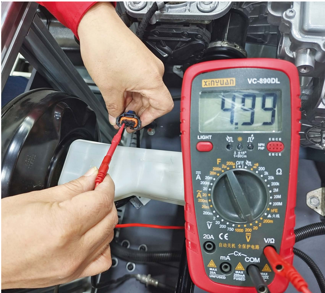
图 1-2-45 BA31 插头的 1 号端子测量
