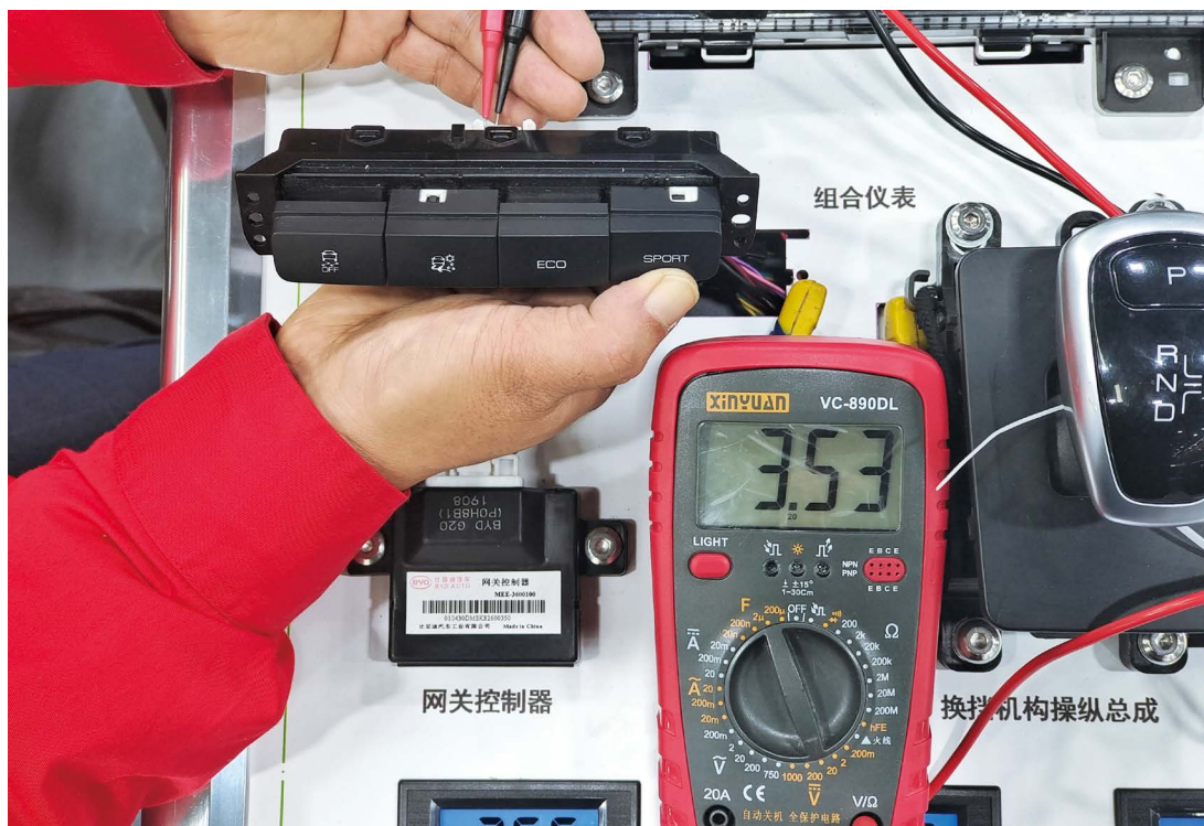
图 1-2-33 G73 的 2、3 号端子之间的电压（动力模式）
