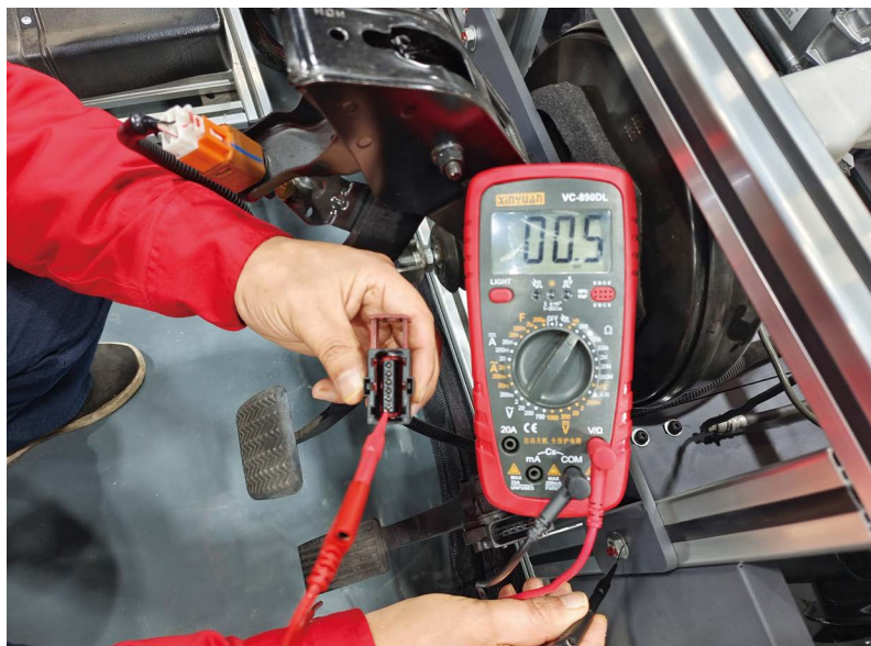
图 1-2-22 G44 插头的 6 号端子测量
