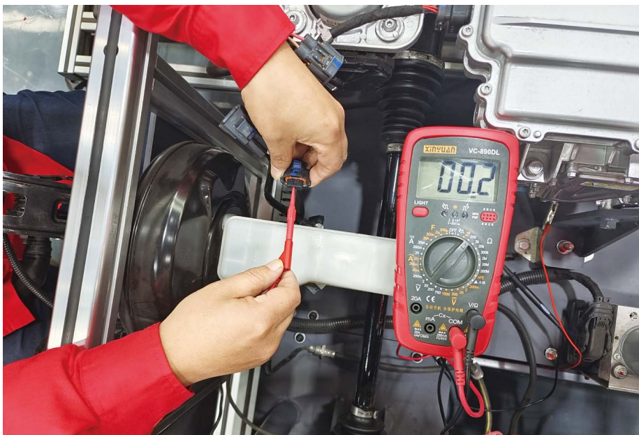
图 1-2-46 BA31 插头的 2 号端子测量
