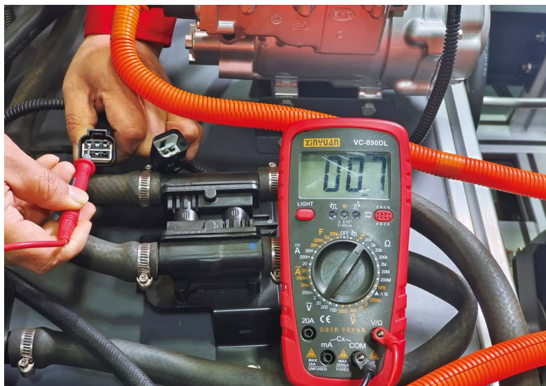
图 2-41 B56 插头的 1 号端子测量
