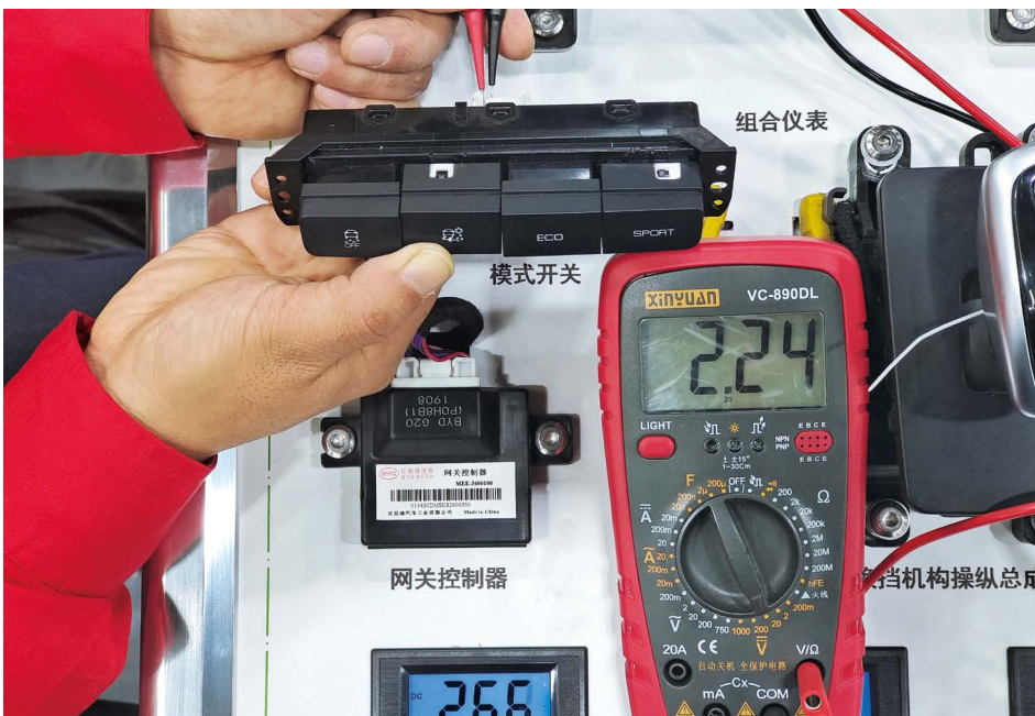
图 1-2-31 G73 的 2、3 号端子之间的电压（雪地模式）
