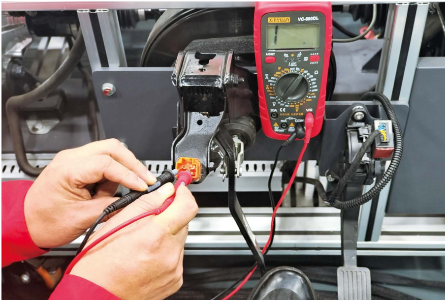
图 1-2-35 G28 插头的 1、2 端子测量（踩下时）
