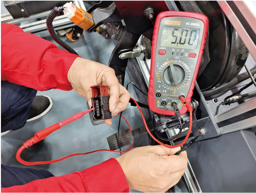
图 1-2-19 G44 插头的 3 号端子测量
