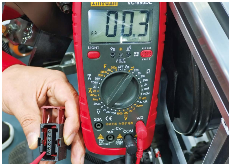
图 1-2-21 G44 插头的 5 号端子测量
