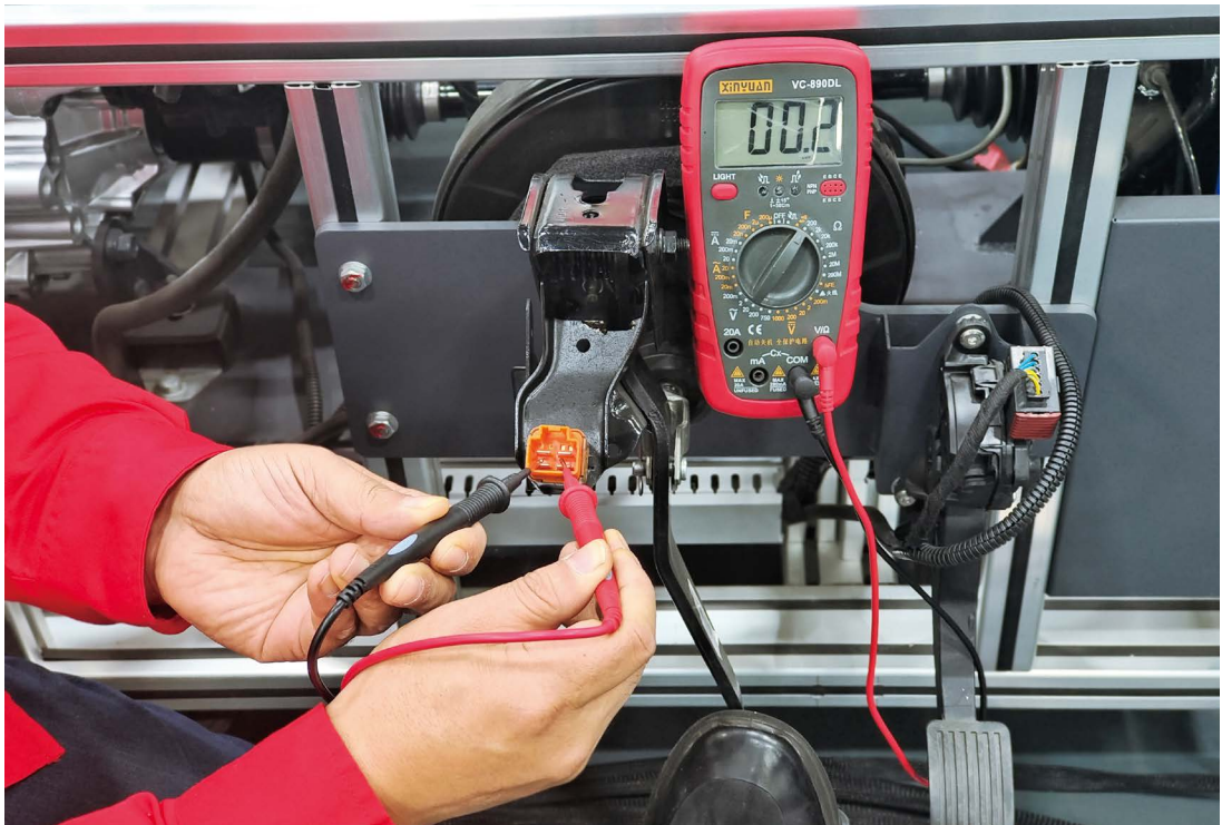
图 1-2-37 G28 插头的 3、4 端子测量（踩下时）
