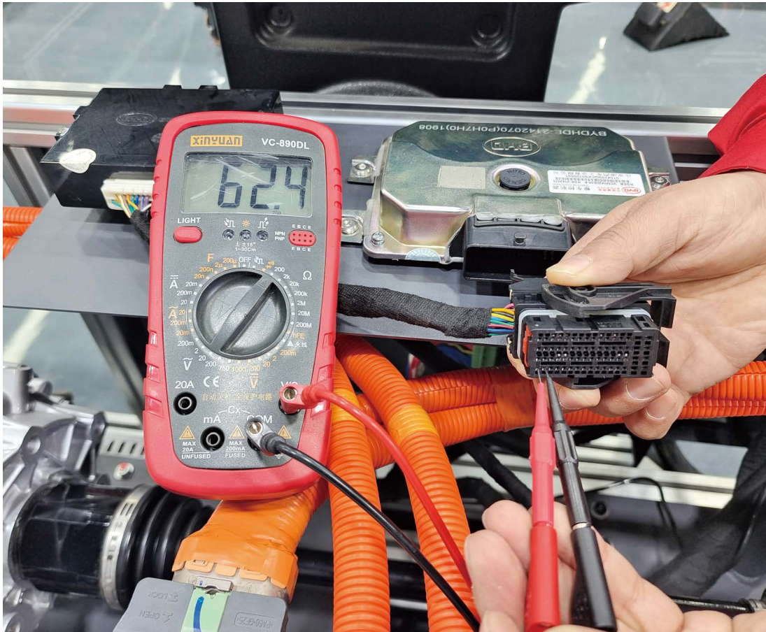
图 4-19 秦 EV VCU 模块总线端子端子的阻值测量
