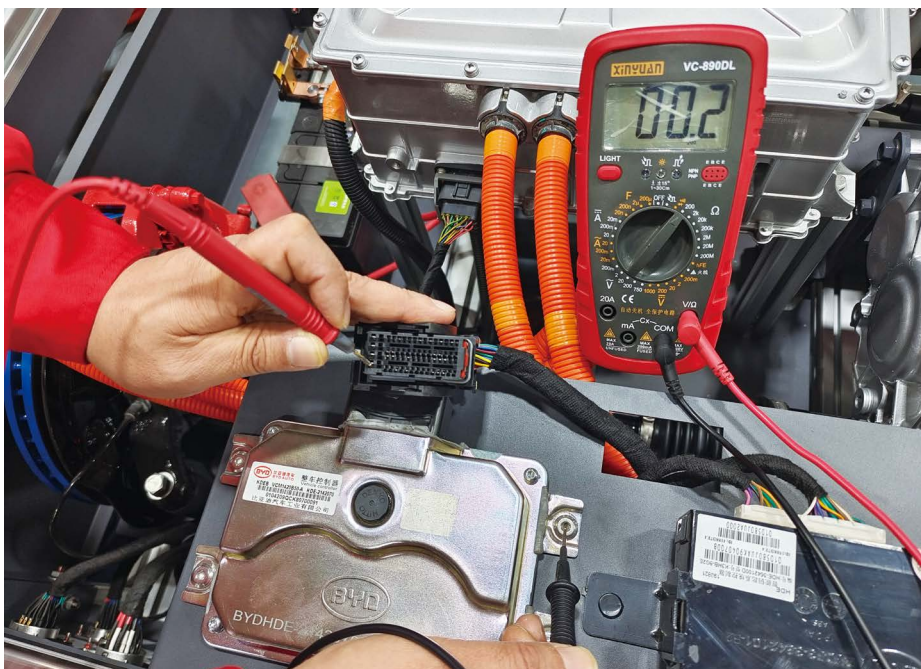
图 1-1-25 GK49 插头 7 号端子测量
