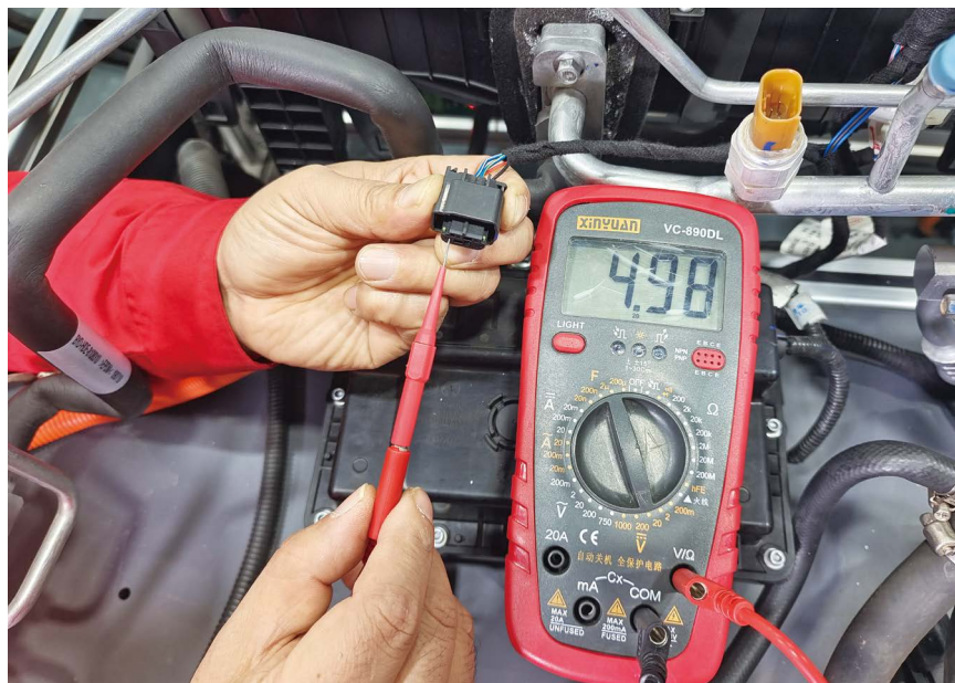
图 2-32 B55 插头的 4 号端子测量
