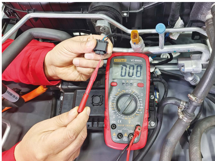
图 2-33 B55 插头的 1 号端子测量
