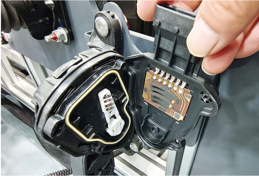
图 1-2-4 接触式加速踏板位置传感器结构
