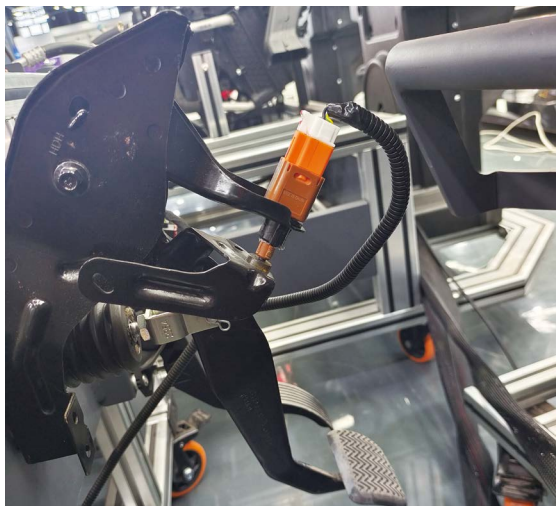
图 1-2-10 秦 EV 制动开关
