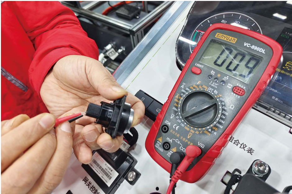
图 1-1-14 启动按钮测量（按下按钮时）
