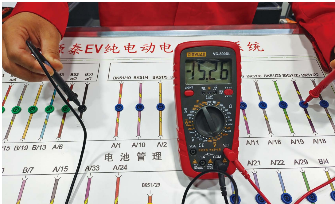
图 3-11 BK45 (A) 插头 18 号端子测量
