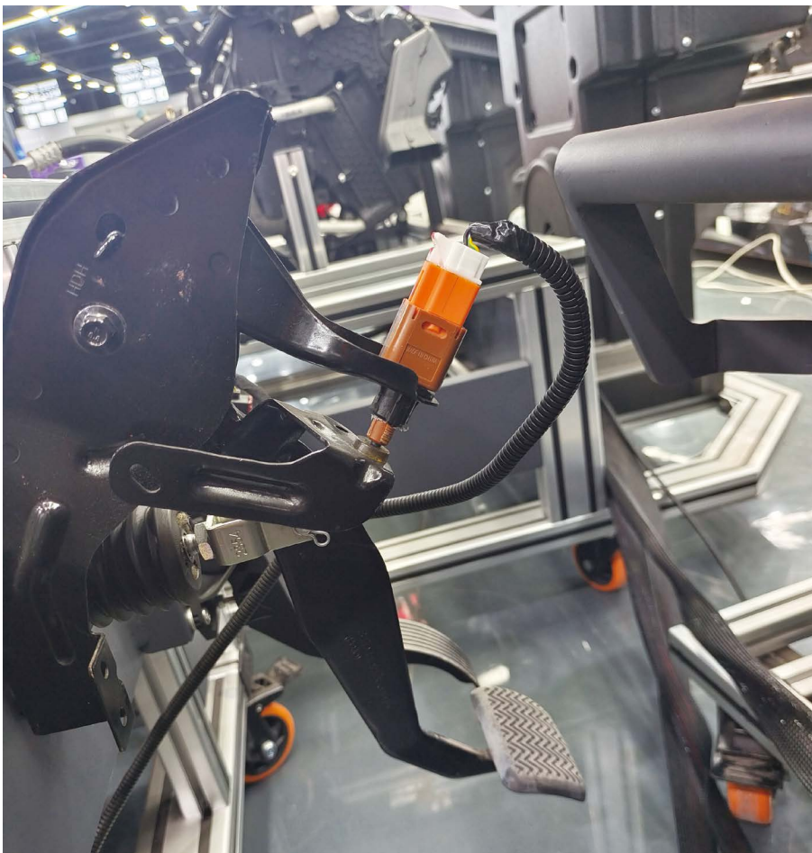
图 3-5 秦 EV 没有制动踏板深度传感器
