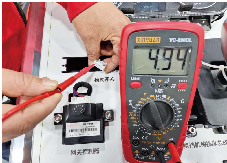
图 1-2-26 G73 的 2 号端子检测
