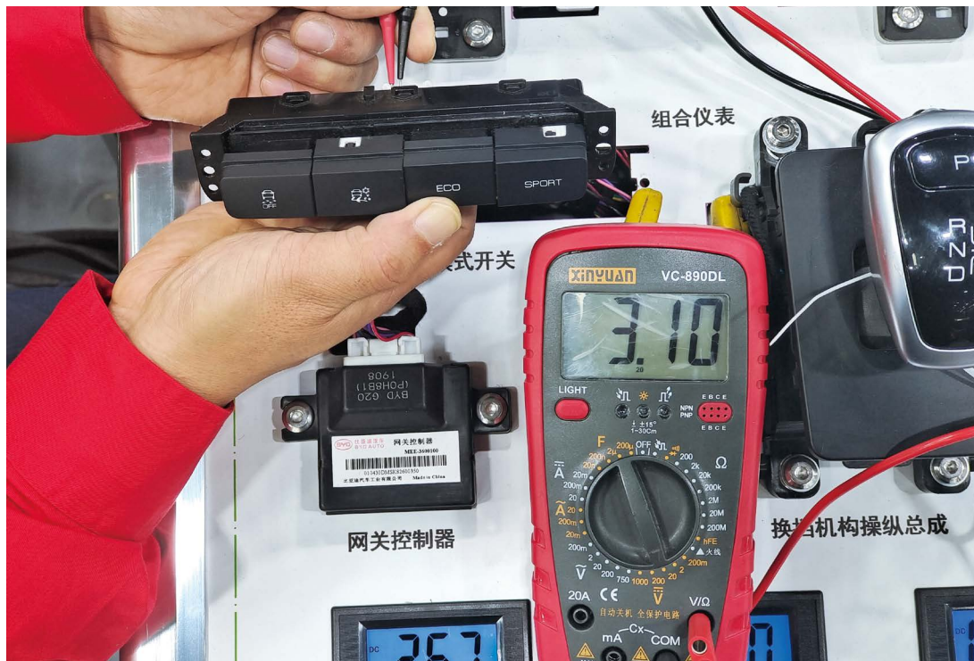
图 1-2-32 G73 的 2、3 号端子之间的电压（经济模式）
