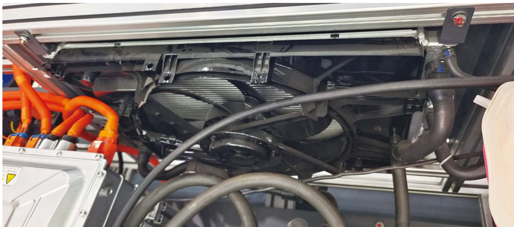
图 1-3-4 秦 EV 散热风扇
