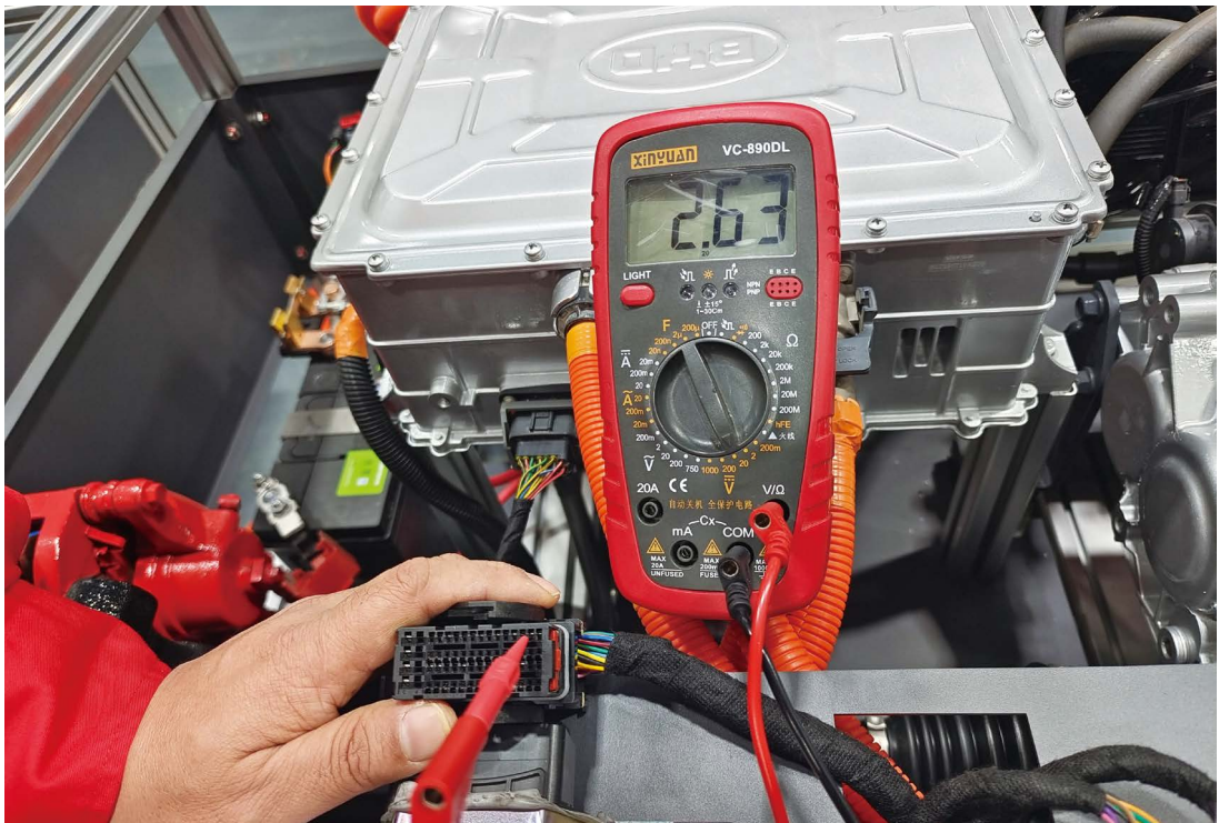
图 1-1-27 GK49 插头的 21 号端子电压的测量
