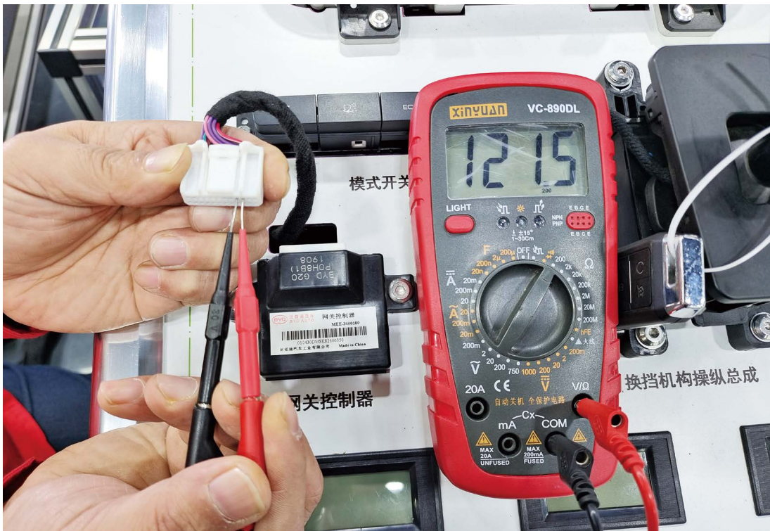
图 4-28 插头 G19 插头 9、10 号端子之间阻值测量
