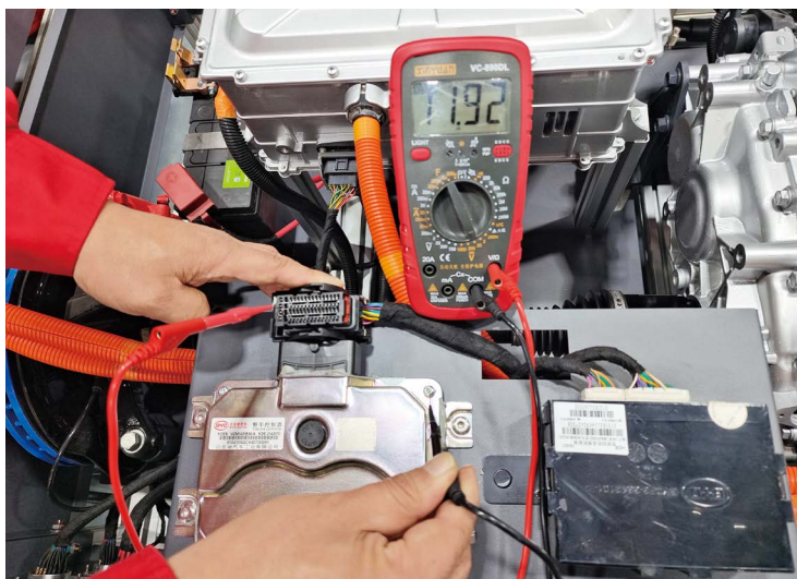
图 1-1-23 GK49 插头的 3 号端子电压测量
