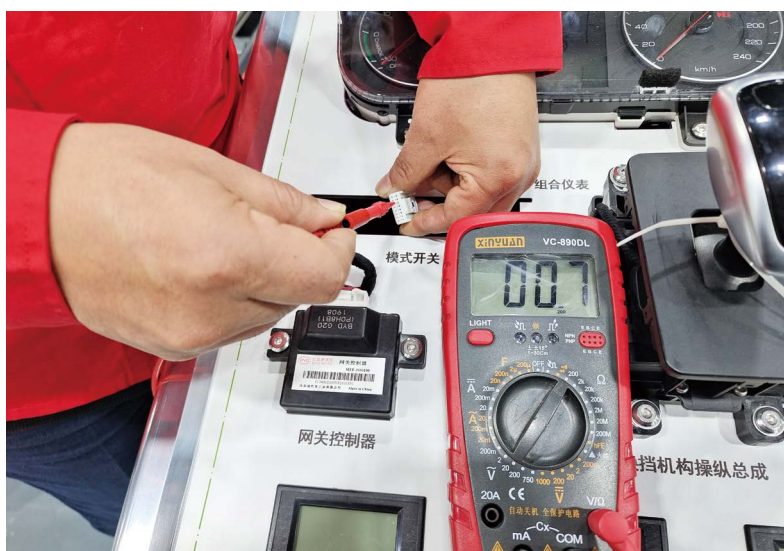
图 1-2-27 G73 的 3 号端子检测
