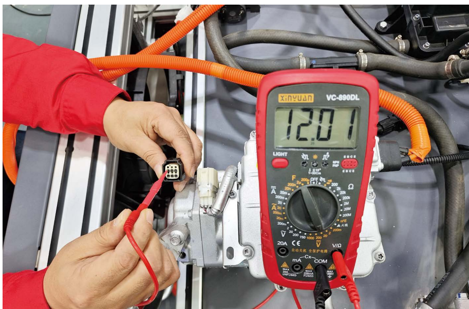
图 1-3-25 电动压缩机 BA17 插头的 1 号端子测量
