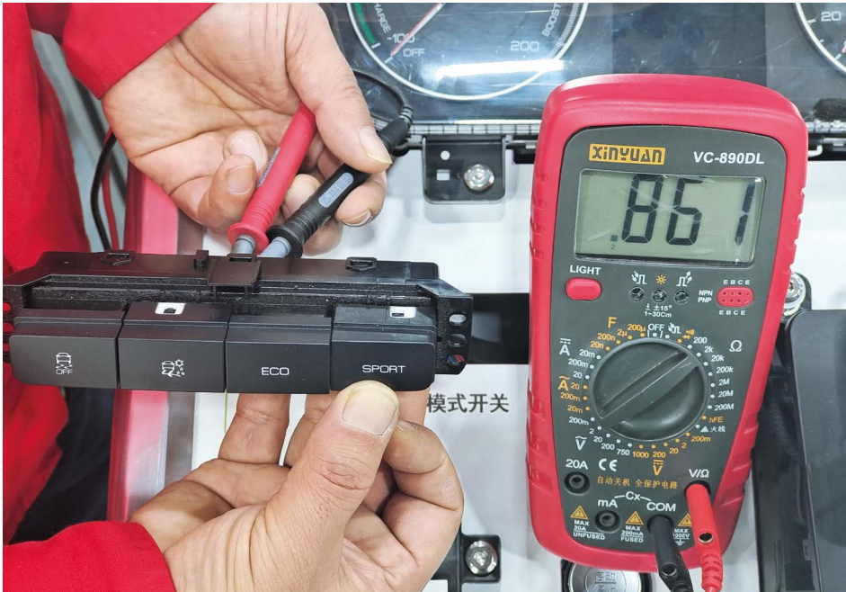
图 1-2-30 G73 的 2、3 号端子之间的电阻（动力模式）
