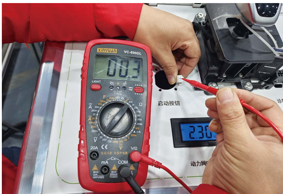
图 1-1-17 G16 插头 6 号端子测量
