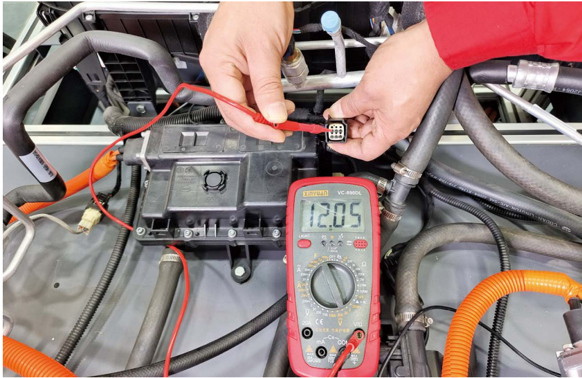
图 1-3-30 PTC 的 B34 插头的 1 号端子测量
