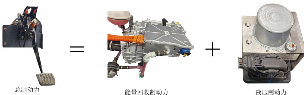
图 3-3 电动汽车制动力的组成
