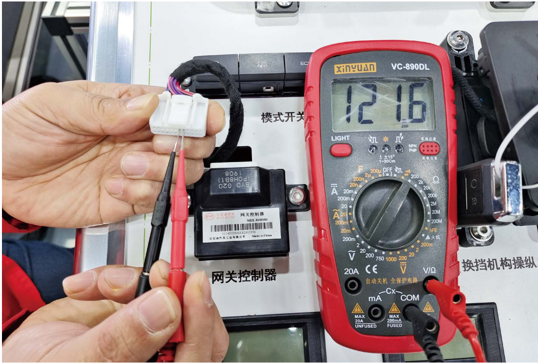
图 4-27 插头 G19 插头 7、8 号端子之间阻值测量
