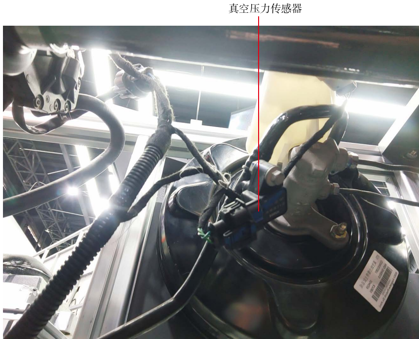
图 1-2-18 真空压力传感器
