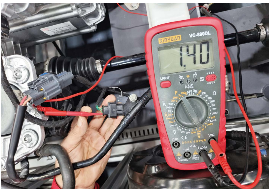
图 1-2-47 BA31 插头的 3 号端子测量
