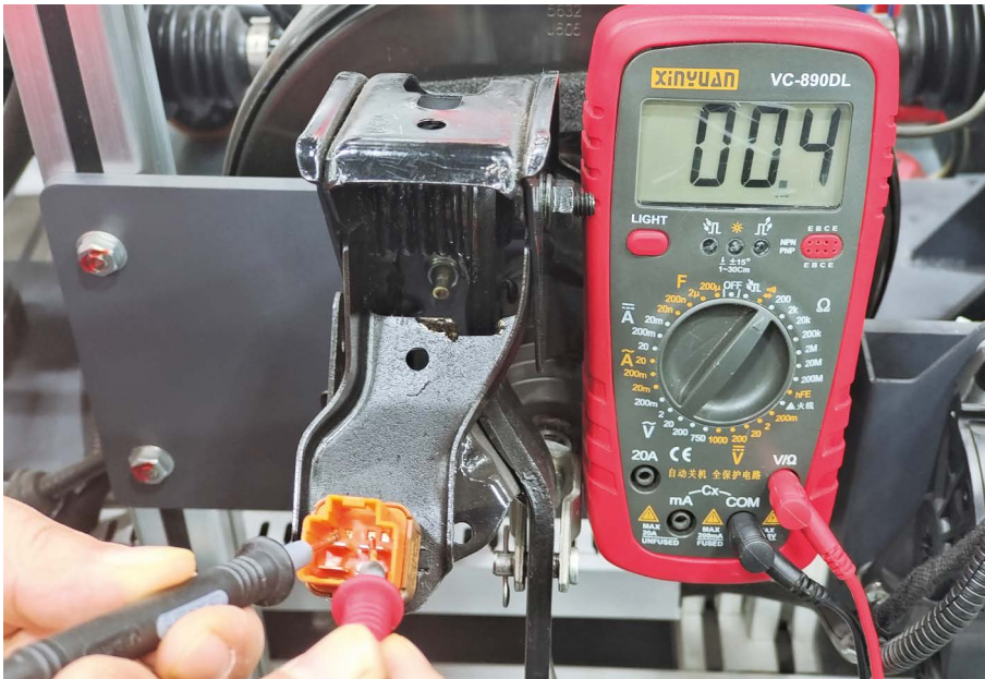
图 1-2-34 G28 插头的 1、2 端子测量（常态时）
