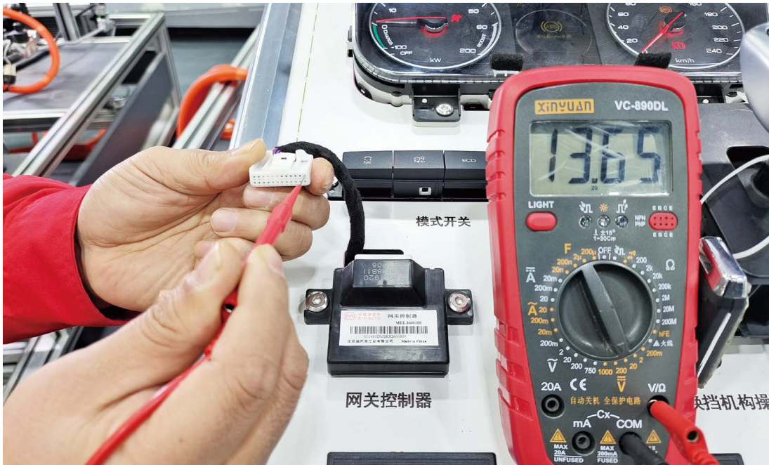
图 4-31 插头 G19 的 12 号端子电压测量
