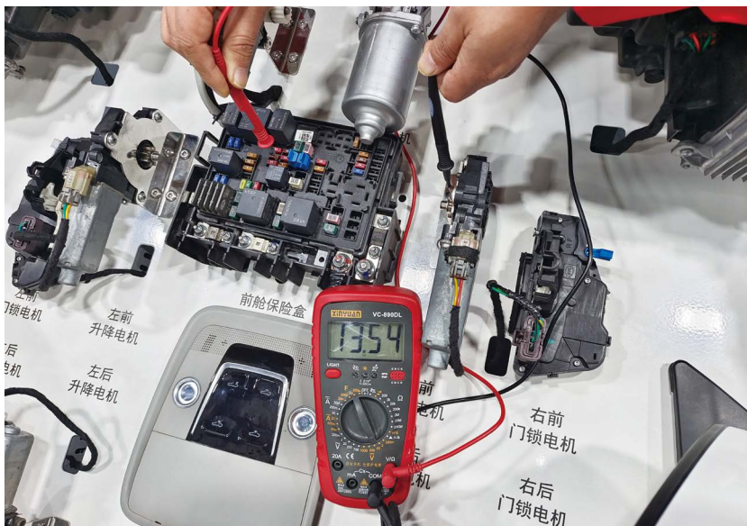
图 1-1-19 F1/12 保险丝电压测量
