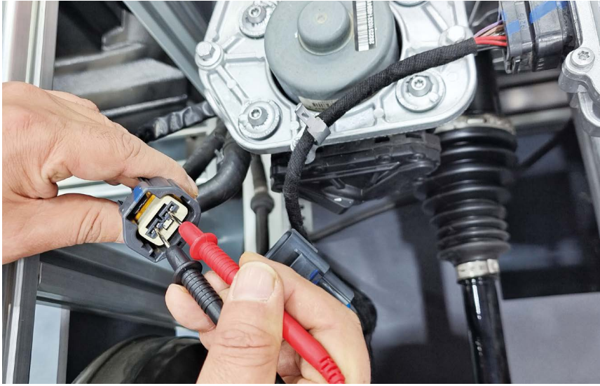
图 1-3-22 真空泵供电检测
