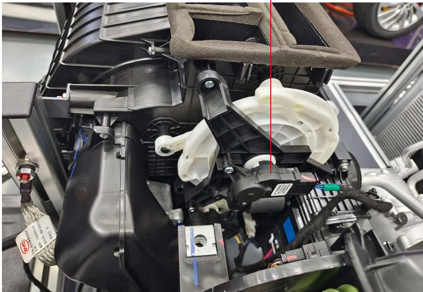
图 2-8-25 秦 PLUS DM-i 主驾冷暖模式控制
