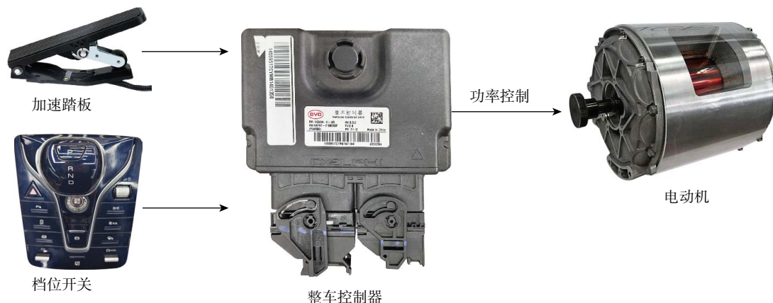
图 2-9-6 秦 PLUS DM-i 电动机功率控制
