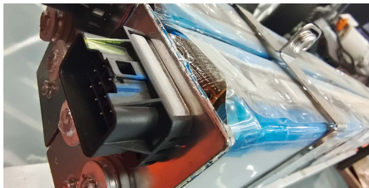
图 2-2-5 刀片电池信息采集插头
