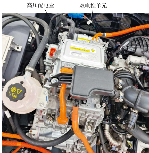
图 2-4-26 秦 PLUS DM-i 双电控高压连接
