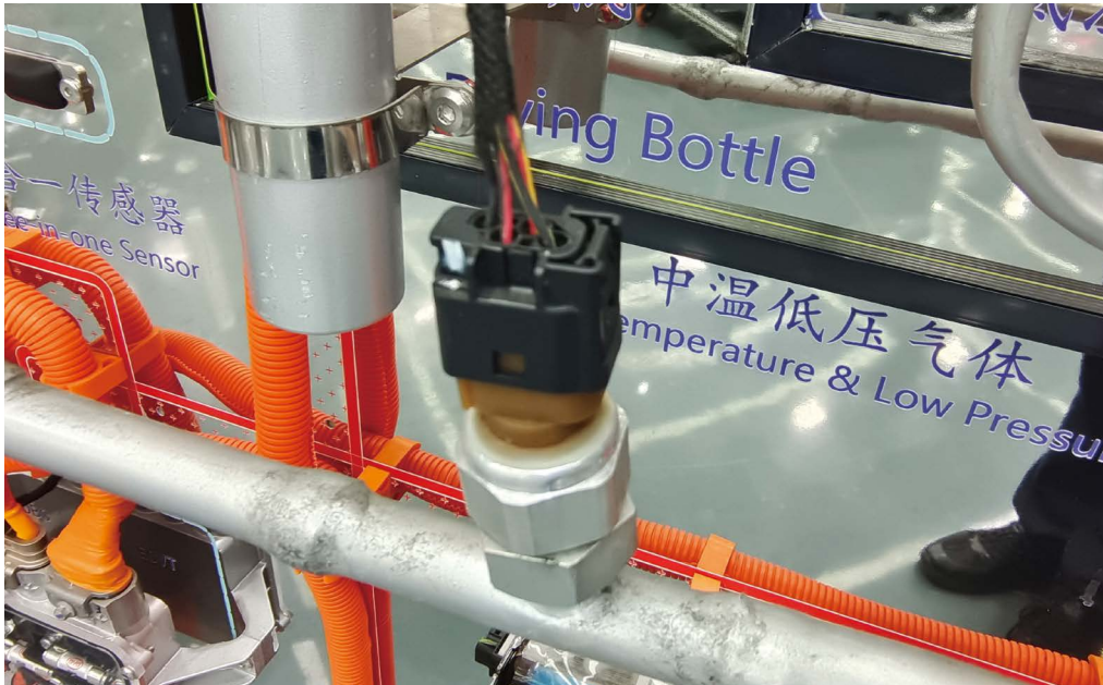
图 2-8-12 秦 PLUS DM-i 空调压力传感器
