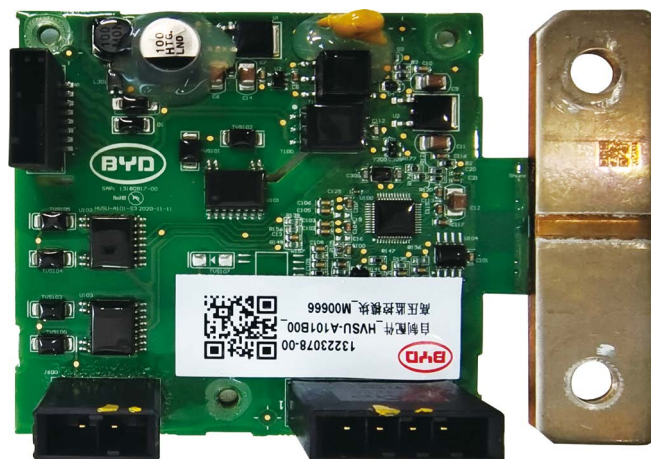
图 2-2-11 秦 PLUS DM-i 分流式电流传感器
