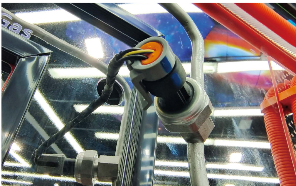
图 2-8-15 秦 PLUS DM-i 的 PT 传感器
