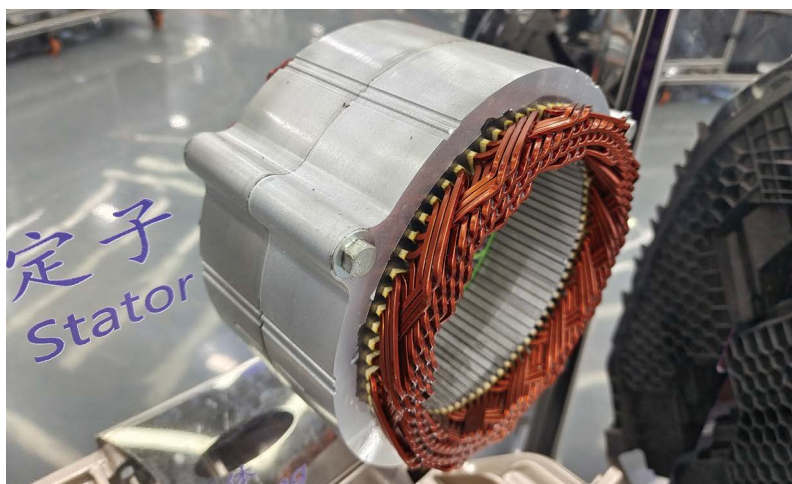
图 2-4-6 秦 PLUS DM-i 驱动电机定子
