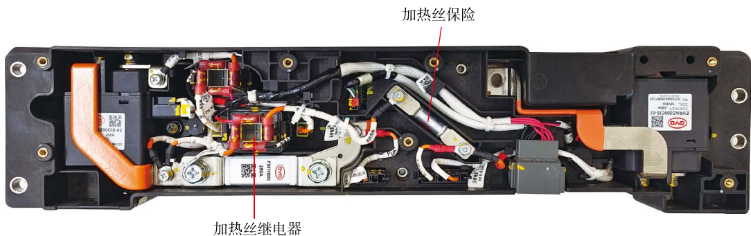
图 2-2-16 秦 PLUS DM-i 高压电池加热继电器
