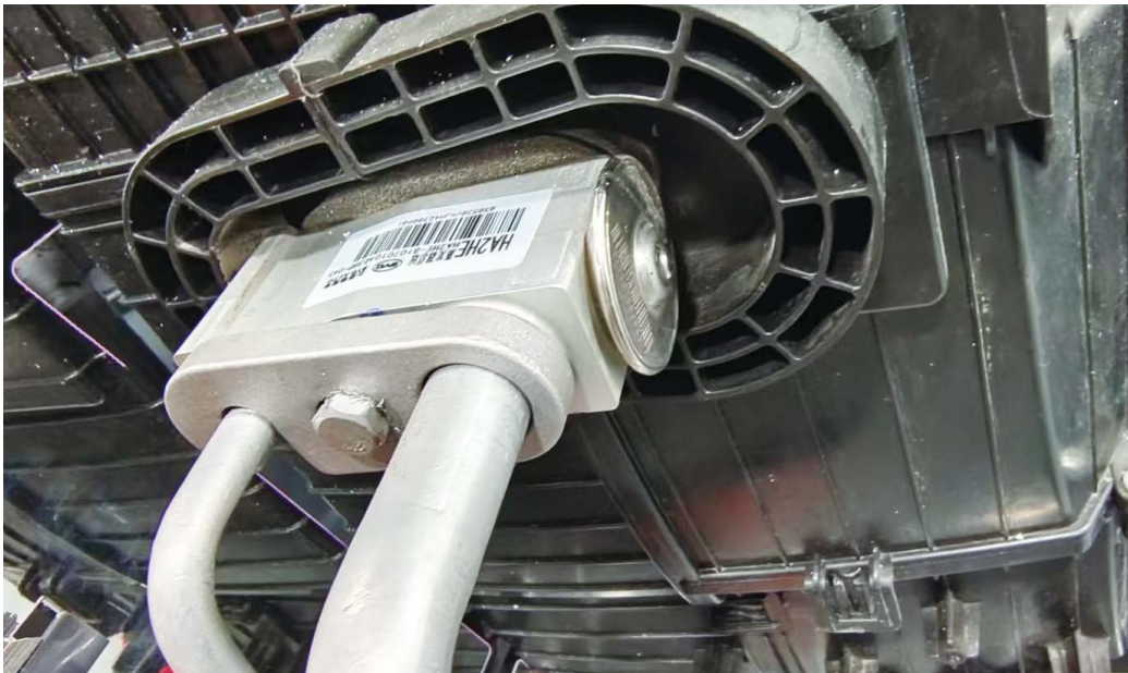
图 2-8-5 秦 PLUS DM-i H 型膨胀阀
