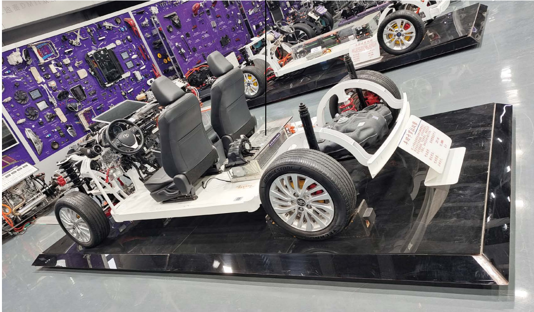
图 1-1-13 非插电式混合动力汽车
