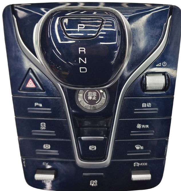
图 2-9-9 秦 PLUS DM-i 换挡操纵机构和换挡操纵机构面板总成
