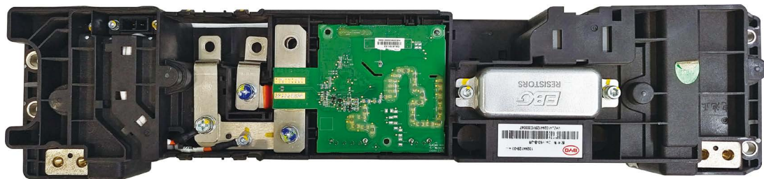
图 2-2-10 秦 PLUS DM-i 高压监控模块 (HVSU)
