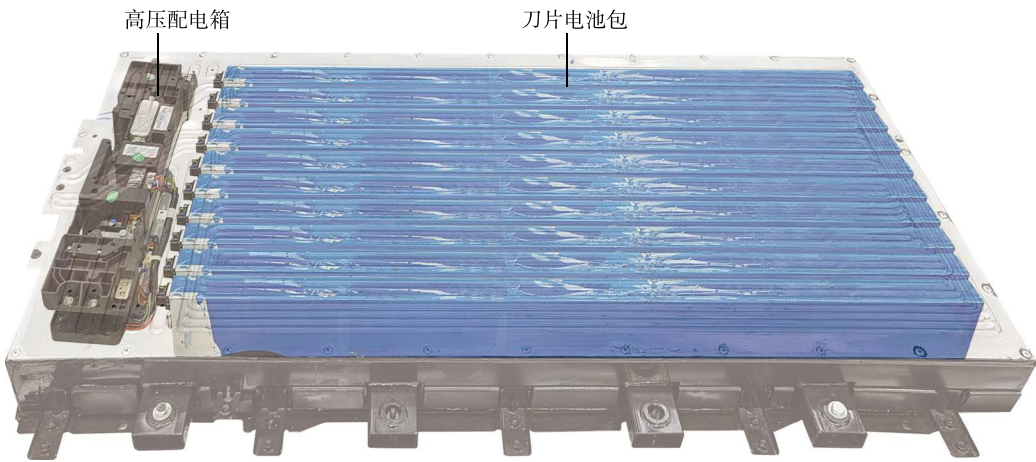
图 2-2-1 秦 PLUS DM-i 刀片电池及电池包
