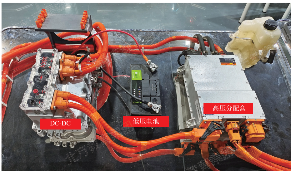
图 11 电动汽车低压供电方式
