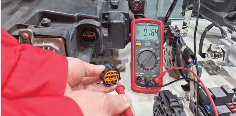
图 6-1-8 小灯线测量 (关闭时)
