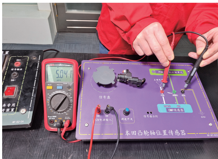
图 5-3-5 霍尔传感器电源的测量
