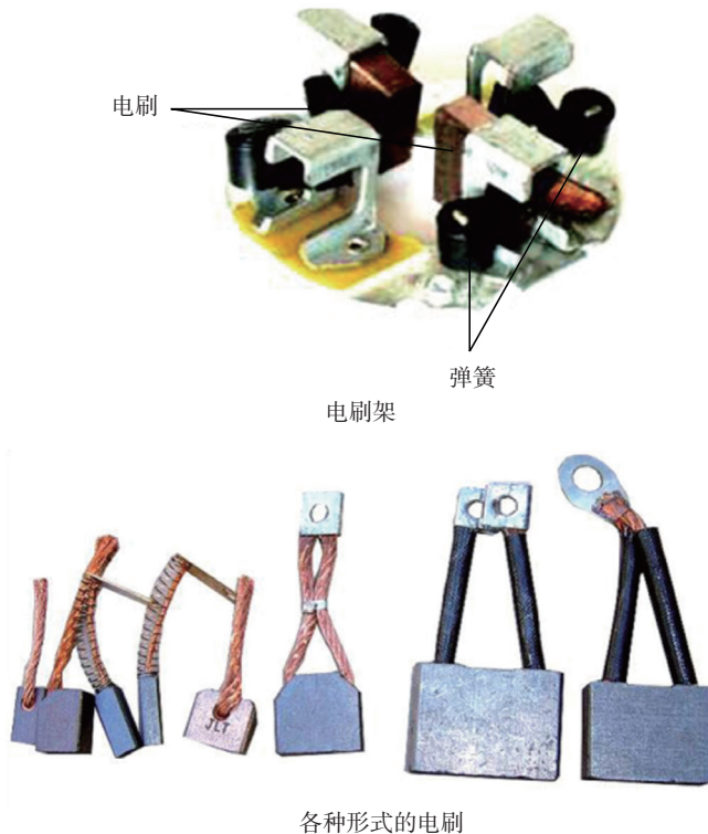
图 4-1-11 电刷与电刷架
