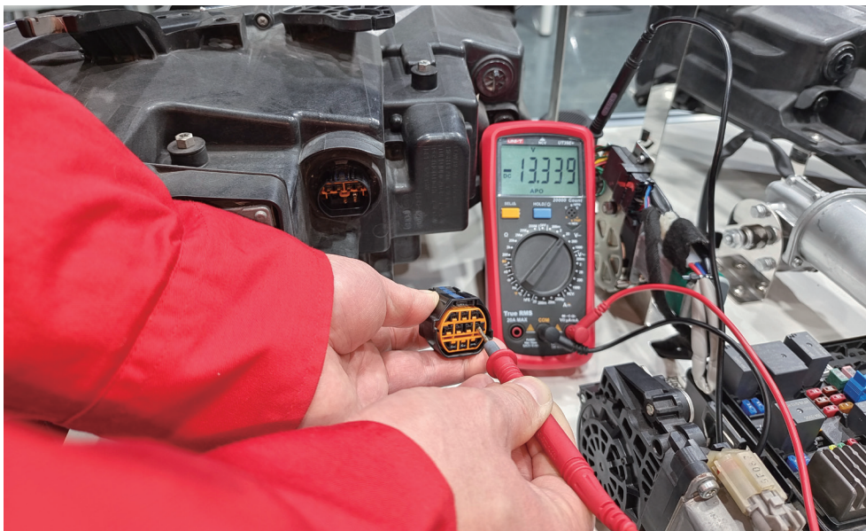
图 6-1-7 小灯线测量（开启时）
