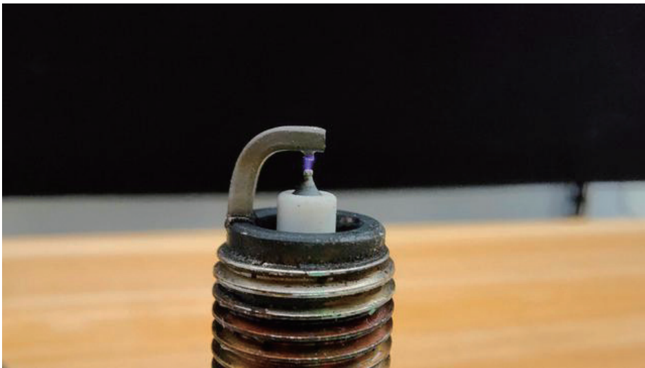
图 5-1-7 火花塞产生电弧
