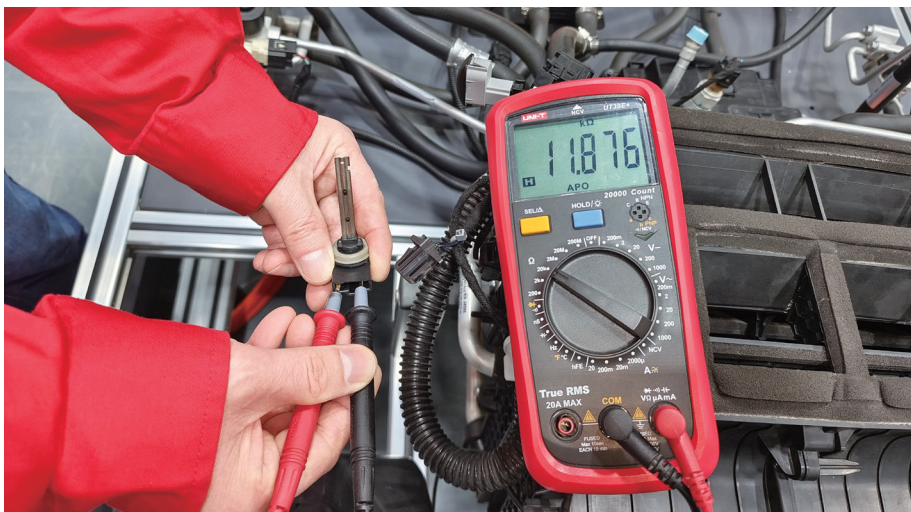
图 7-2-13 温度传感器测量
