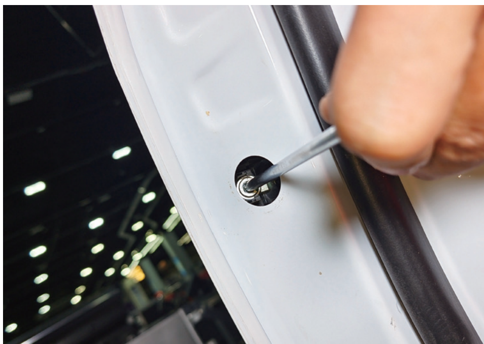
图 4-1-18 拆下左前门把手固定螺丝
