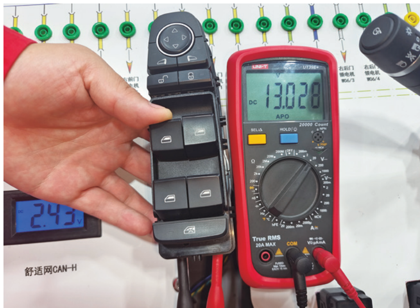
图 3-2-19 测量 T05 (A) 插头 23、11 号端子电压 (按上升按键时)
