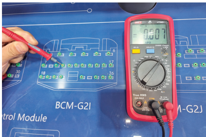
图 2-2-28 测量 BCM 的 G2I 插头 10 号端子电压（开启雨刷开关时）
