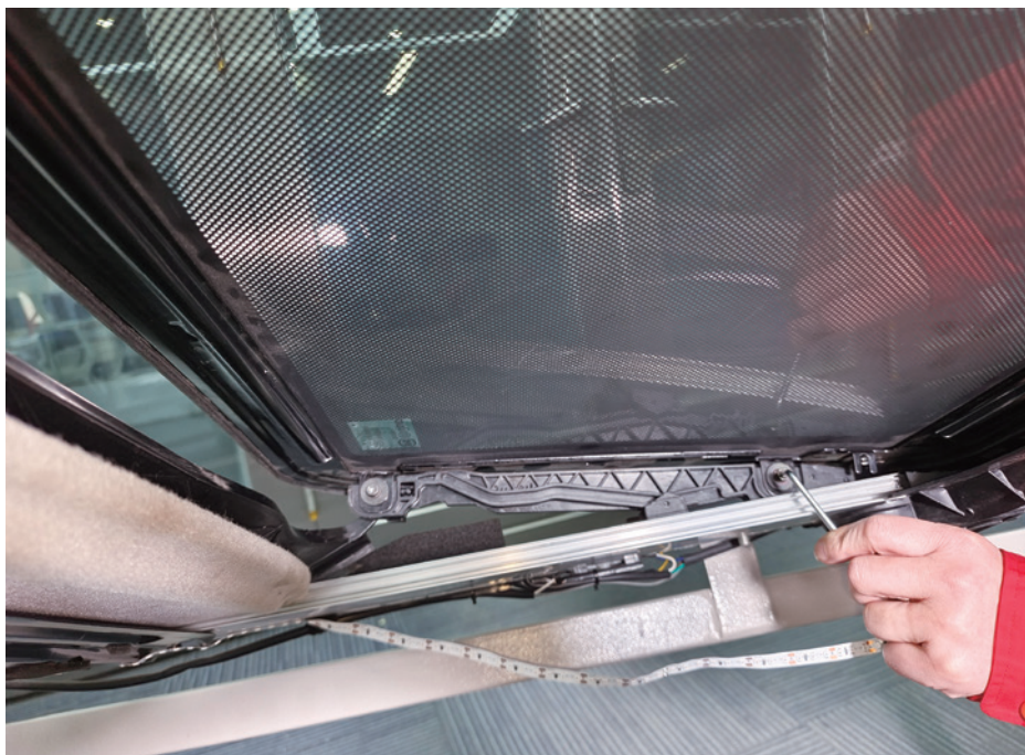
图 7-1-17 拆下左侧两条天窗固定螺丝
