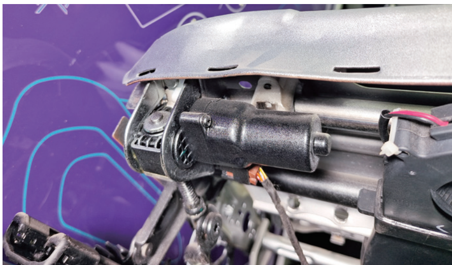
图 6-1-3 座椅前部上下调节机构
