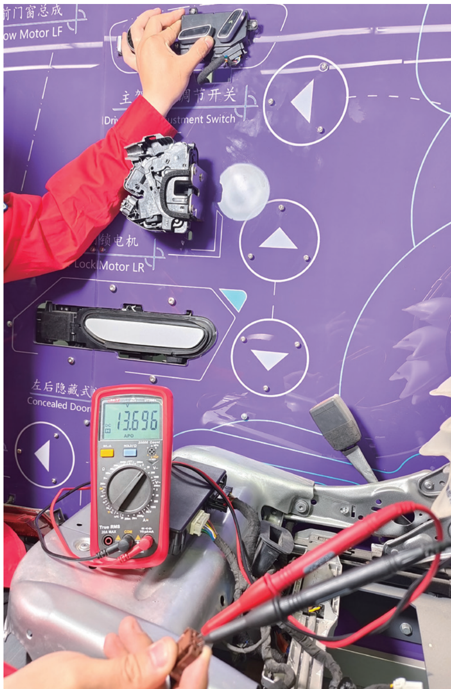
图 6-2-14 比亚迪汉座椅后部上下调整电机线路测量（座椅后部上升时）
