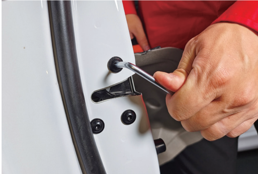
图 4-1-27 拆下锁块固定螺栓
