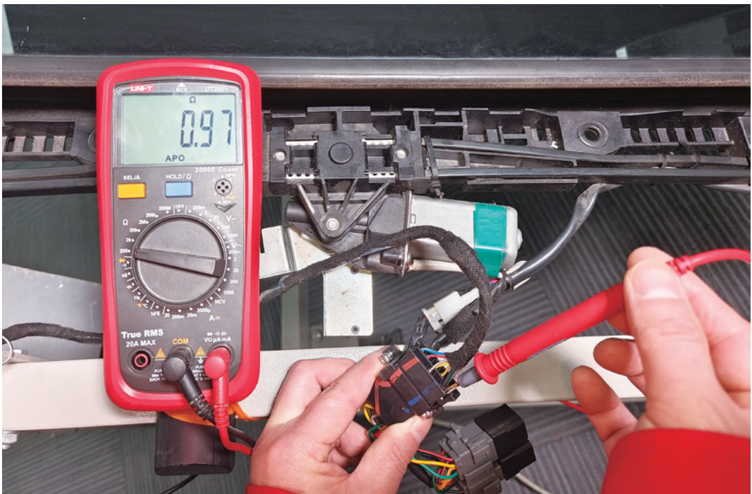
图 7-2-31 天窗电机 P05 插头的 10 号测量
