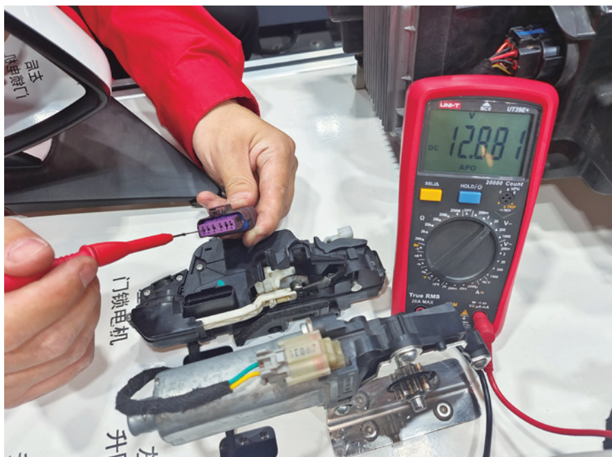
图 4-2-19 T06 插头 6 号端子电压测量
