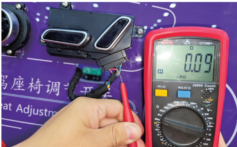
图 6-2-9 比亚迪汉座椅调整开关接地电阻的测量
