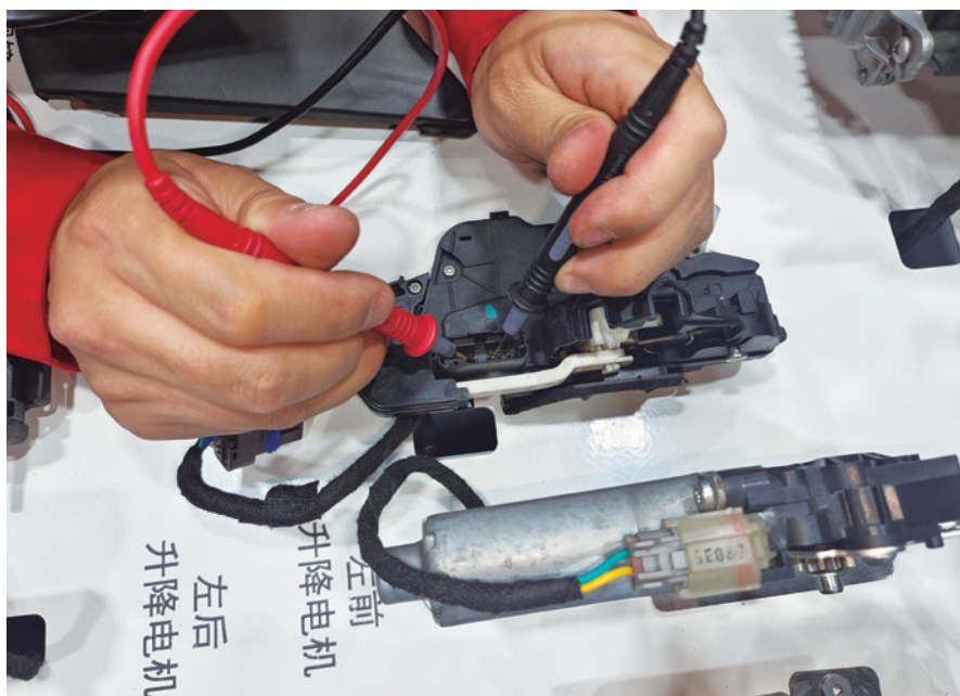
图 4-2-15 门锁电机供电检测（闭锁时）
