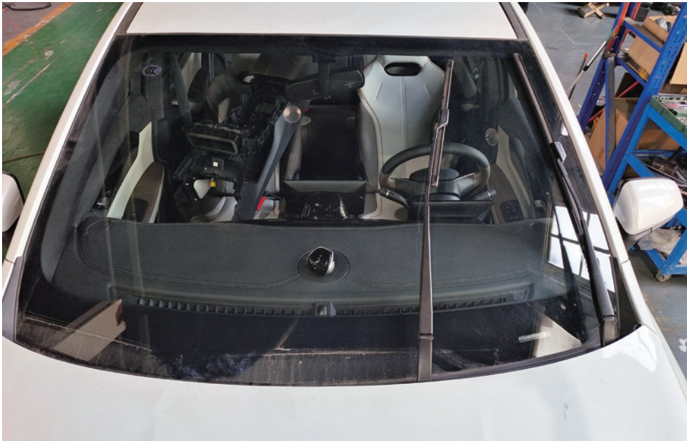
图 2-1-6 维修模式雨刷片位置 ( 比亚迪秦 EV )
