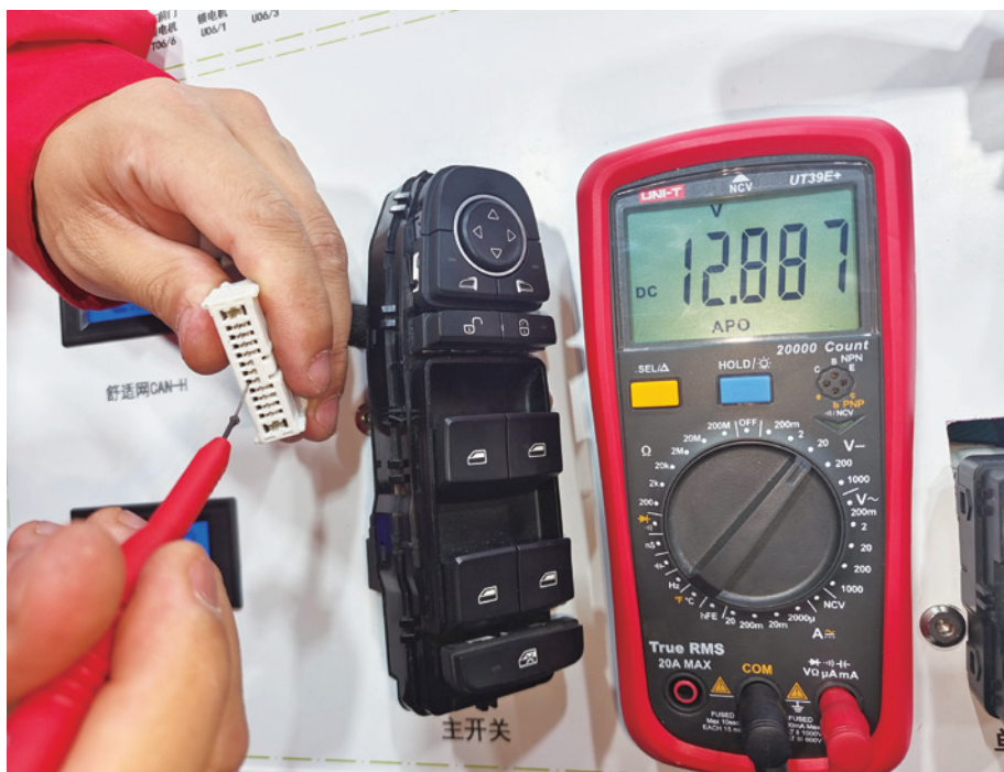
图 4-2-8 T05 (A) 线路端插头的 18 号端子电压测量
