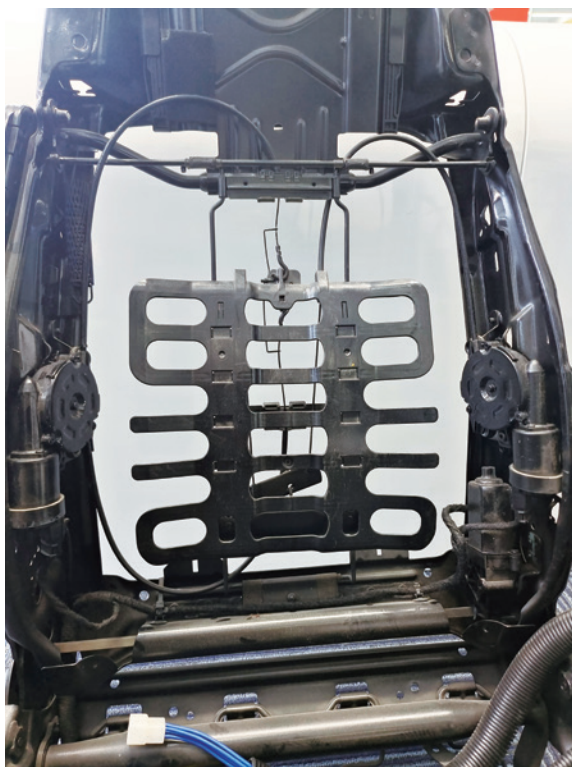
图 6-1-7 拉线式腰托调整机构
