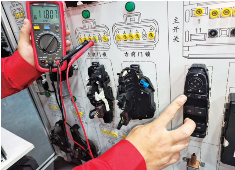
图 4-2-12 T06 线路端插头的 4、3 号端子端子测量（开锁瞬间）
