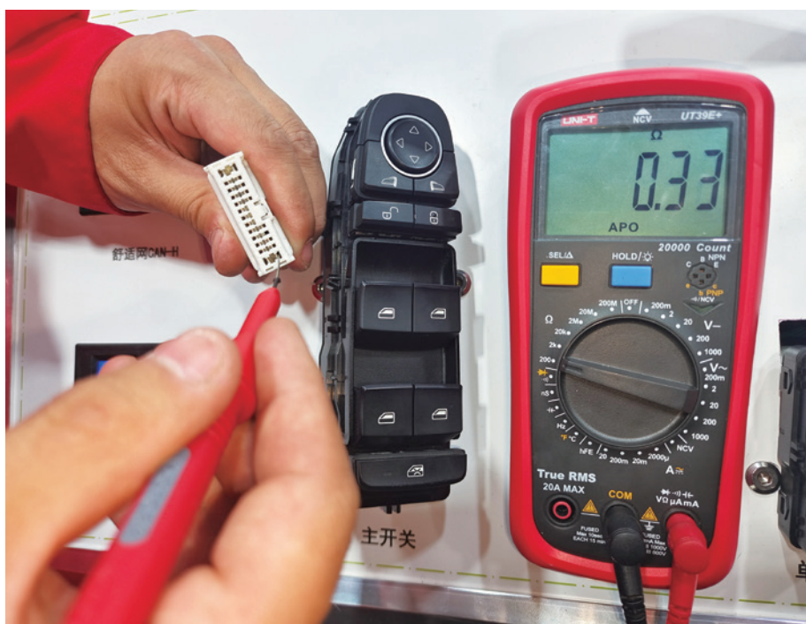
图 4-2-9 T05 (A) 插头的 10 号端子接地电阻测量
