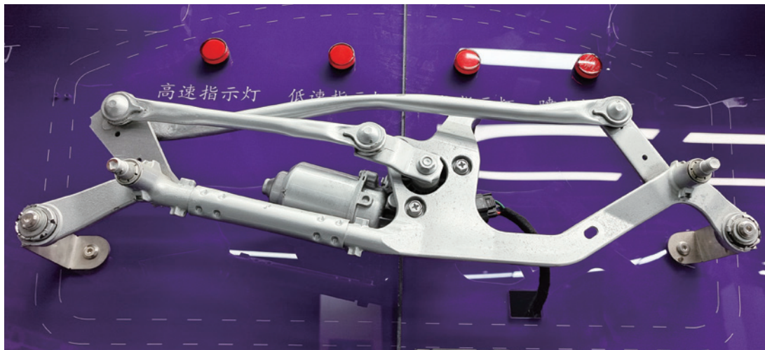
图 2-1-1 汽车雨刮器结构
