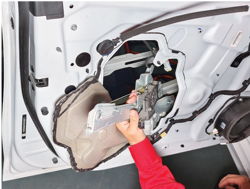
图 3-1-17 取下电动车窗支架
