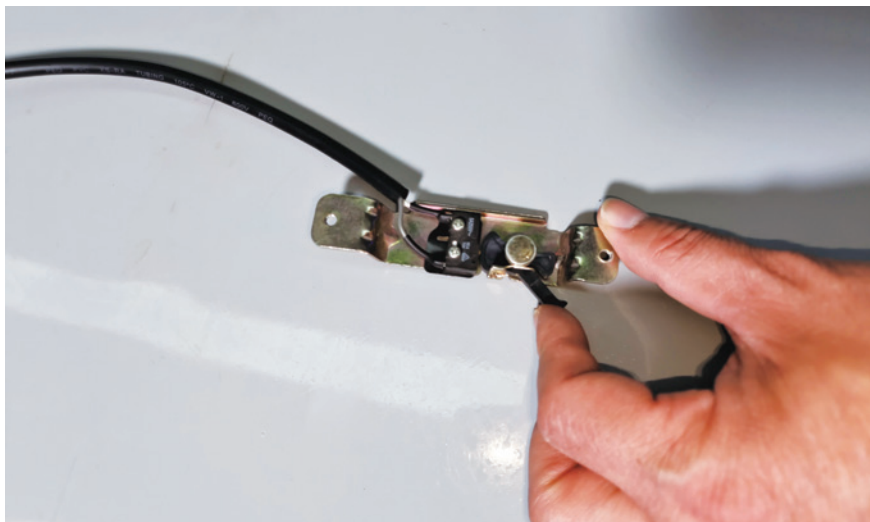
图 7-2-16 天窗滑动打开限位开关触发状态
