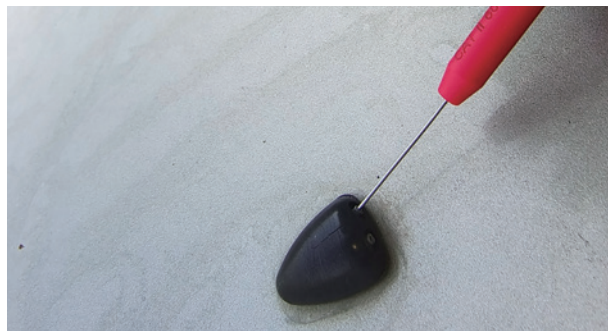
图 2-3-5 调整洗涤喷孔
