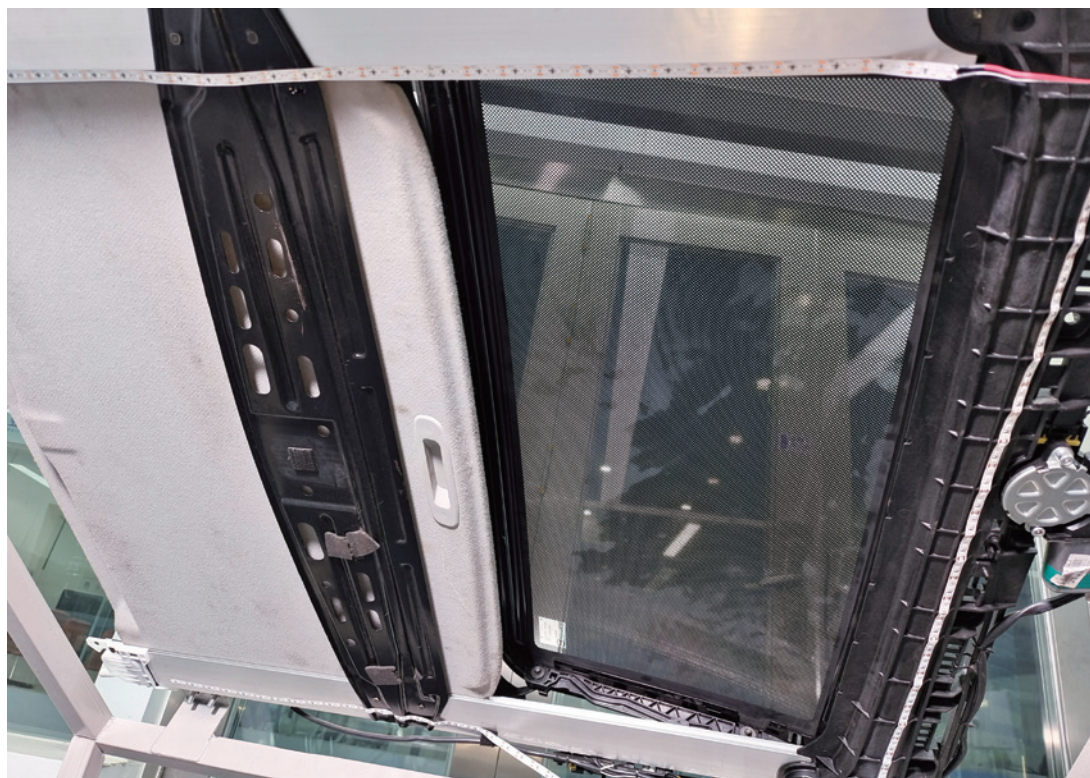
图 7-1-16 打开天窗遮阳板将天窗上倾
