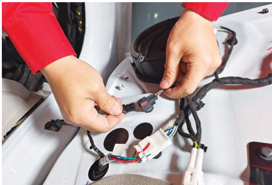
图 5-1-7 拆掉倒车镜连接插头
