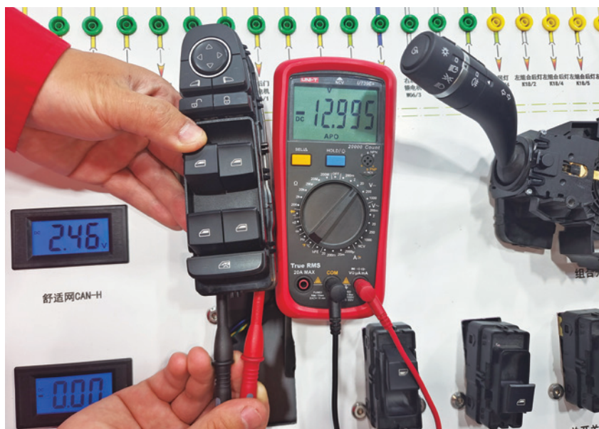
图 3-2-20 测量 T05 (A) 插头 23、11 号端子电压 (按下降按键时)
