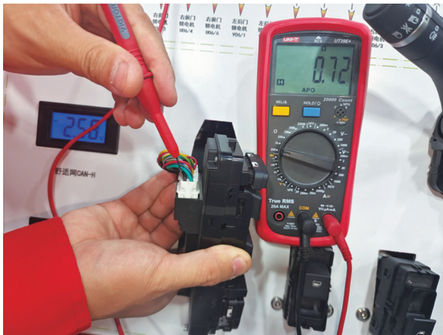
图 3-2-17 T05 (A) 插头的 10 号端子接地电阻测量
