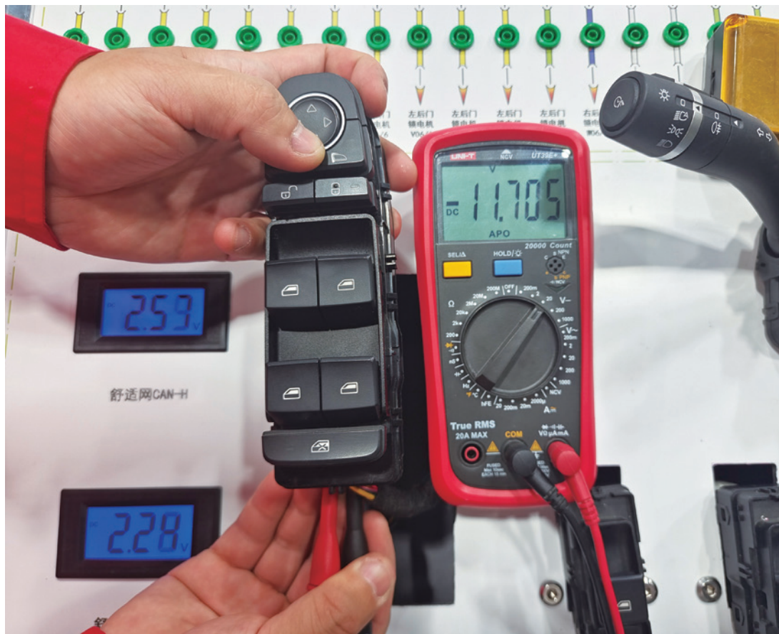
图 5-2-12 测量 T05 (A) 插头、号端子电压 (按左侧倒车镜下翻按键时)
