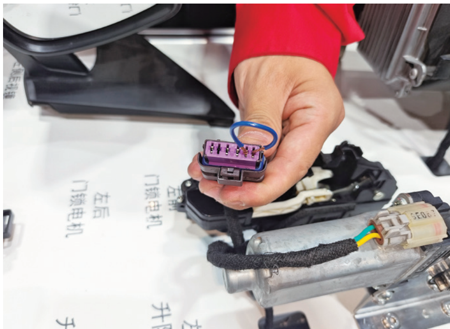
图 4-2-18 短接 T06 插头线路端的 5、6 号端子
