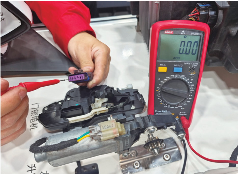
图 4-2-20 T06 插头 5 号端子接地电阻测量
