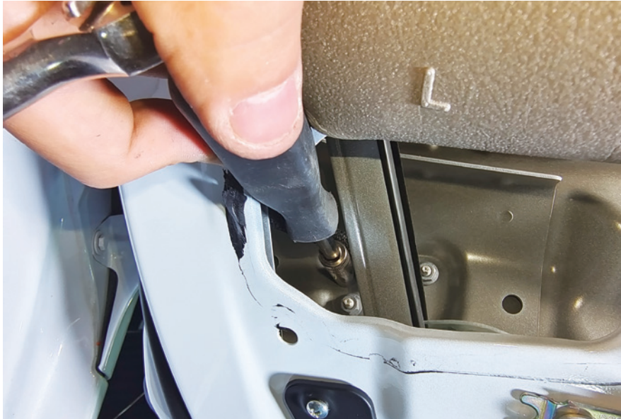
图 5-1-9 拆下倒车镜固定螺栓
