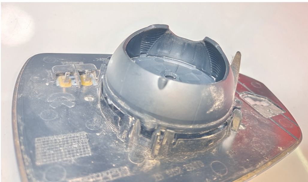
图 5-1-5 蔚来电动倒车镜调整器壳体
