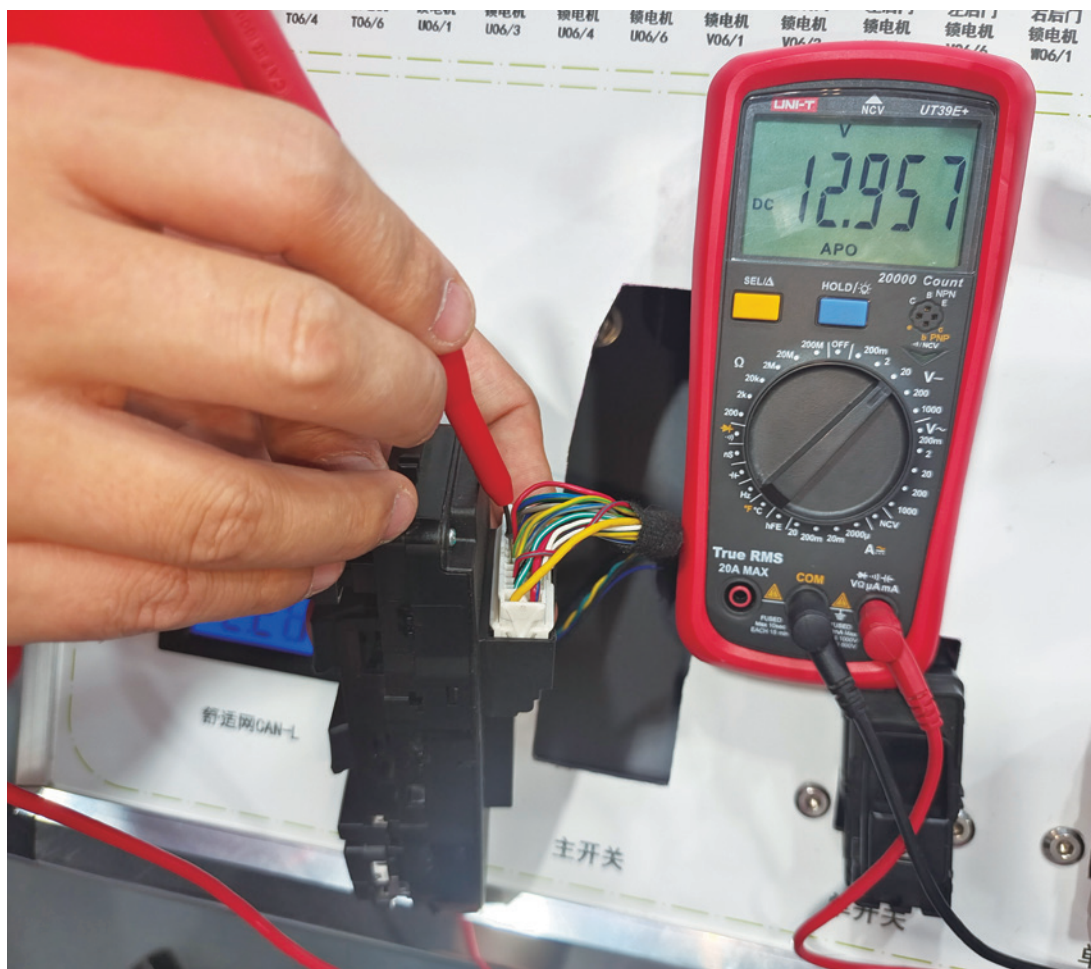
图 3-3-8 T05 (A) 插头的 16 号端子电压测量
