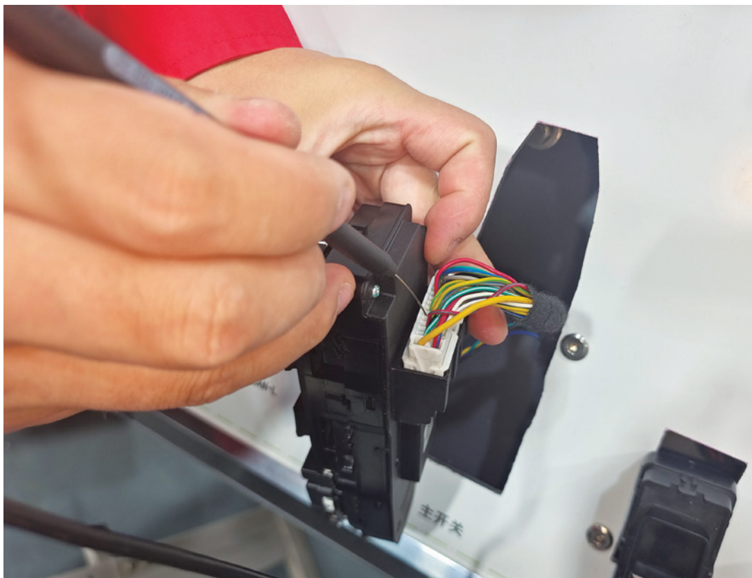
图 3-3-9 T05 (A) 插头的 16 号端子接地实验
