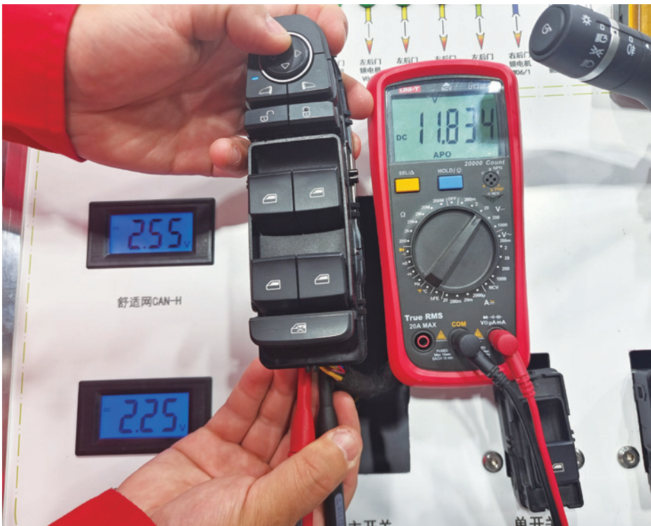
图 5-2-11 测量 T05 (A) 插头、号端子电压 (按左侧倒车镜上翻按键时)
