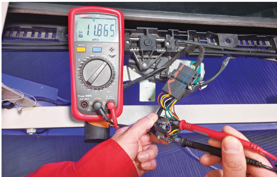
图 7-2-33 两继电器的电机端子
