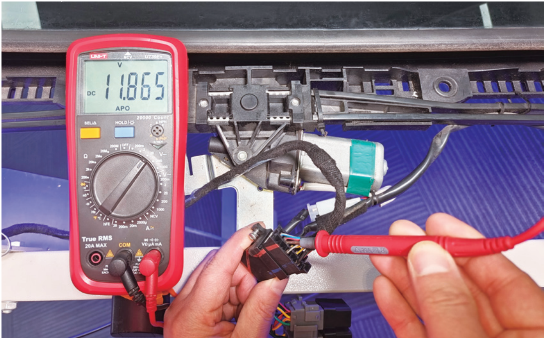
图 7-2-30 天窗电机 P05 插头的 3 号测量
