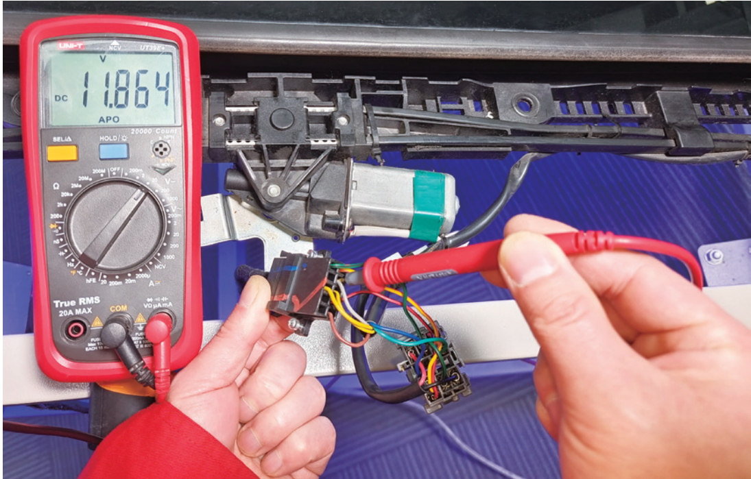
图 7-2-34 P05 插头 7 号端子的测量
