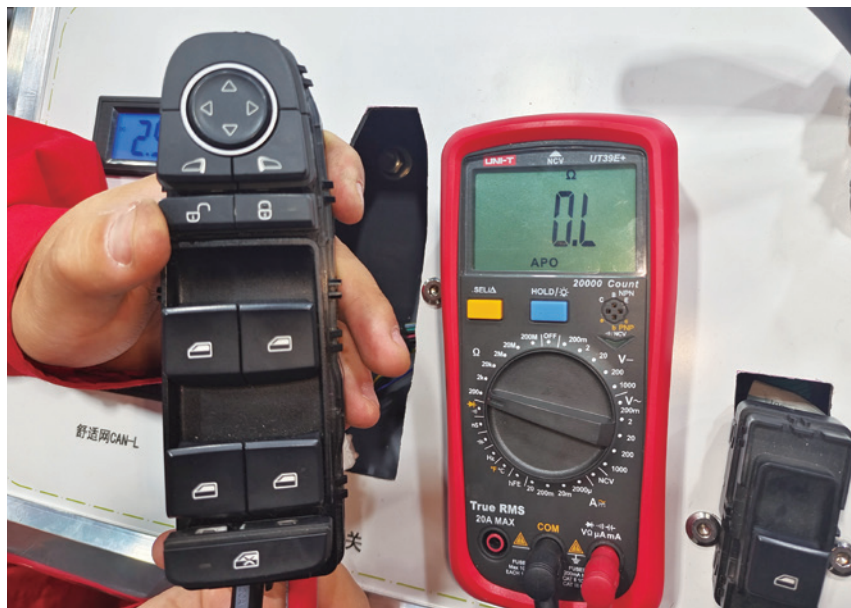
图 4-2-10 T05 (A) 开关端插头的 17、10 号端子电阻测量 (未按开关时)
