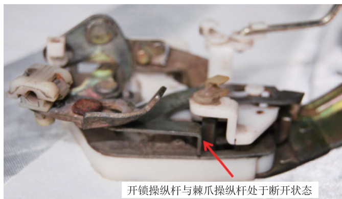
图 4-1-9 车门锁动作示意图
