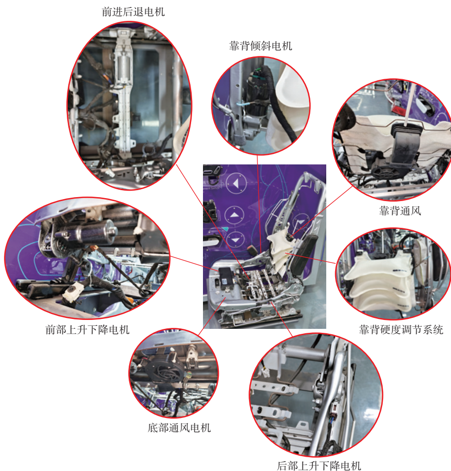
图 6-1-14 比亚迪汉座椅结构
