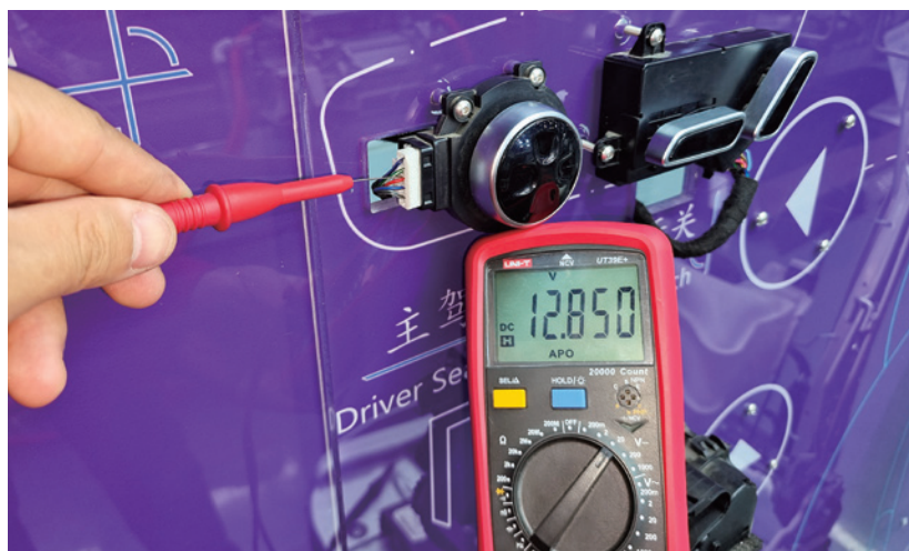
图 6-2-11 比亚迪汉腰垫开关电源测量
