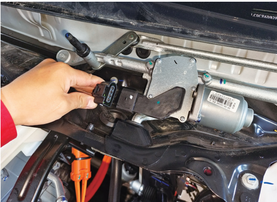
图 2-1-15 拔下雨刷电机插头
