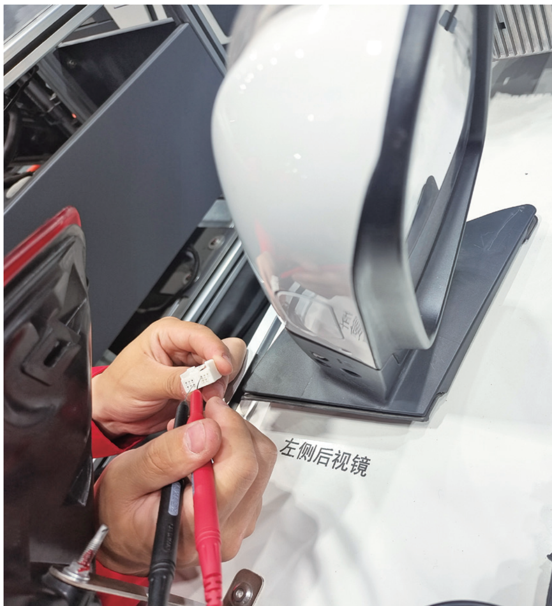
图 5-2-8 电动倒车镜上翻通电实验
