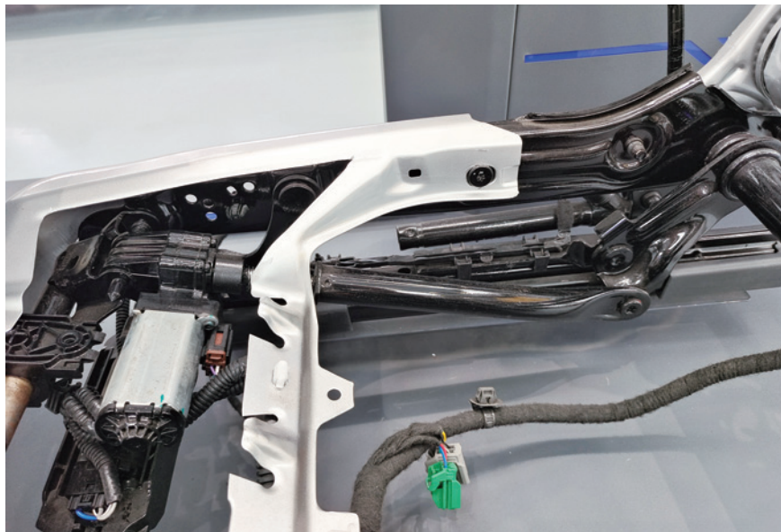
图 6-1-4 涡轮蜗杆式后部上下调节机构
