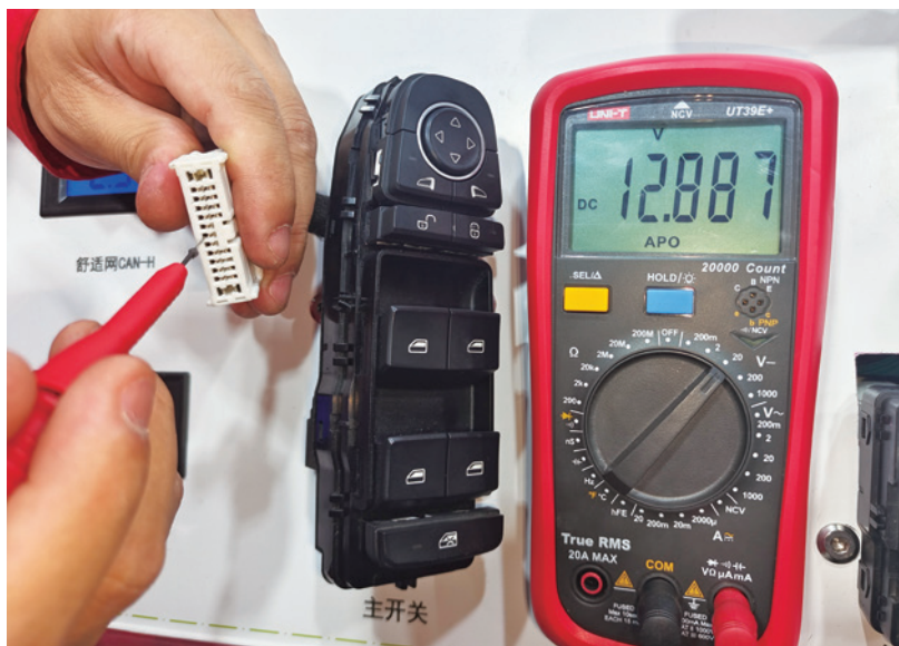
图 4-2-7 T05 (A) 线路端插头的 17 号端子电压测量
