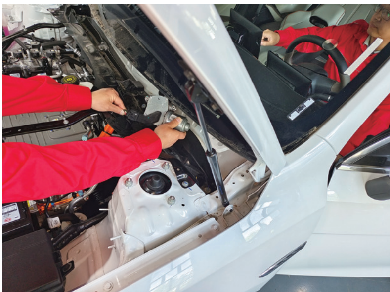
图 2-1-22 启动雨刷维修模式调整电机位置
