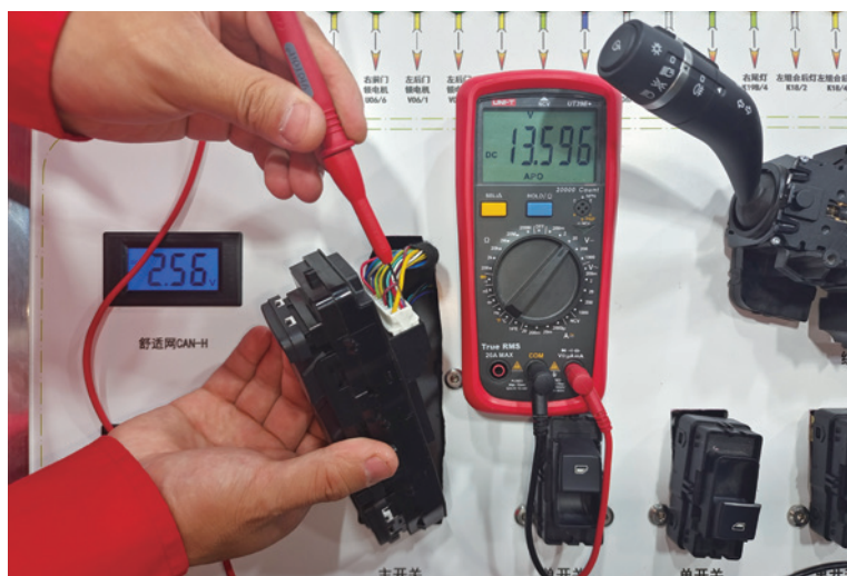
图 3-2-16 T05 (A) 插头的 1 号端子电压测量
