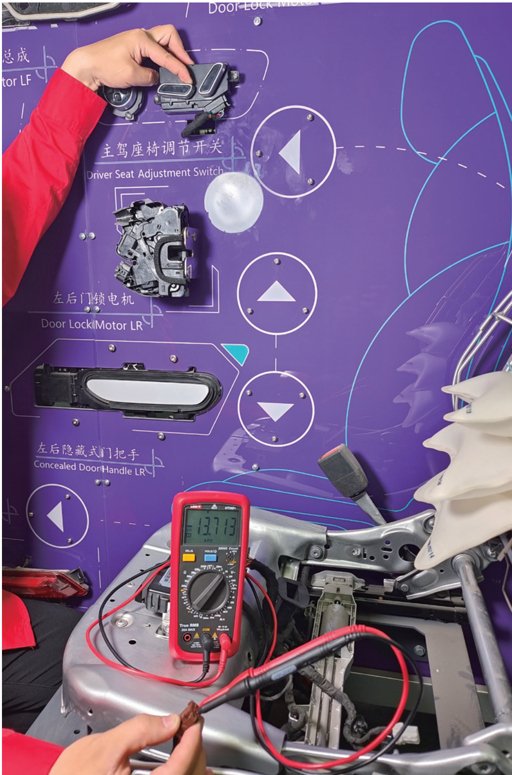
图 6-2-15 比亚迪汉座椅后部上下调整电机线路测量（座椅后部下降时）
