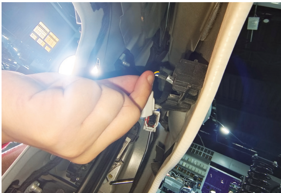
图 4-1-16 拆掉门把手导线插头
