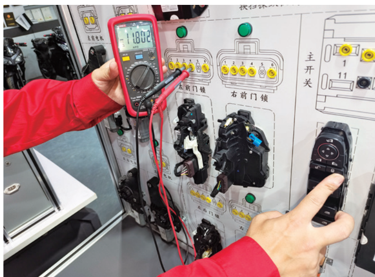
图 4-2-13 T06 线路端插头的 4、3 号端子端子测量（闭锁瞬间）
