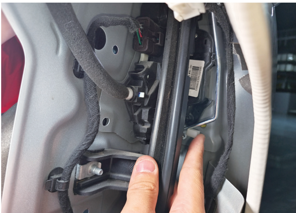
图 4-1-22 拆掉门把手与锁块的连接杆
