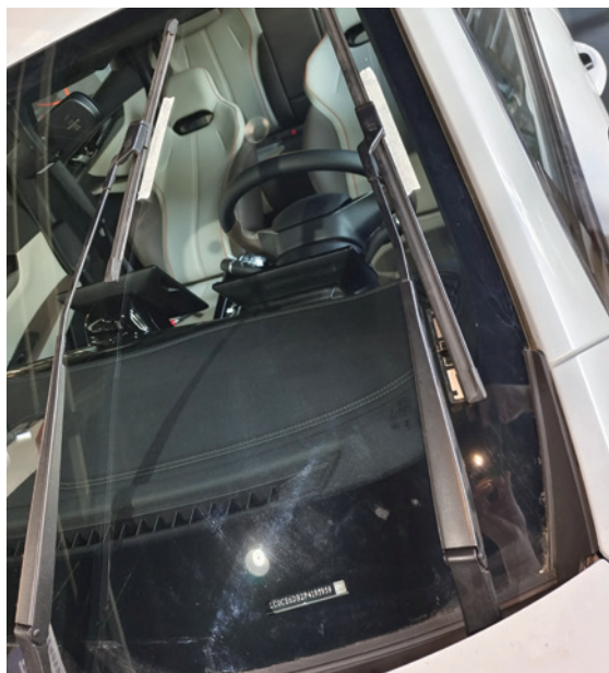
图 2-1-9 在挡风玻璃上做出雨刷片的位置标记
