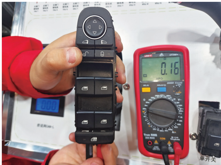
图 4-2-11 T05 (A) 开关端插头的 17、10 号端子电阻测量 (按下开关时)
