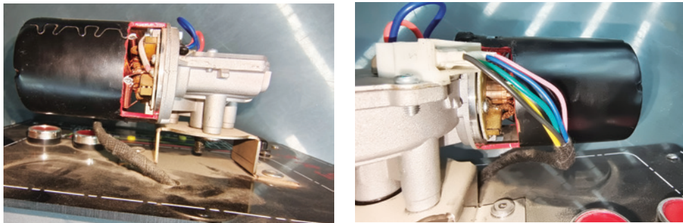
图 2-2-1 雨刷电机的碳刷布置
