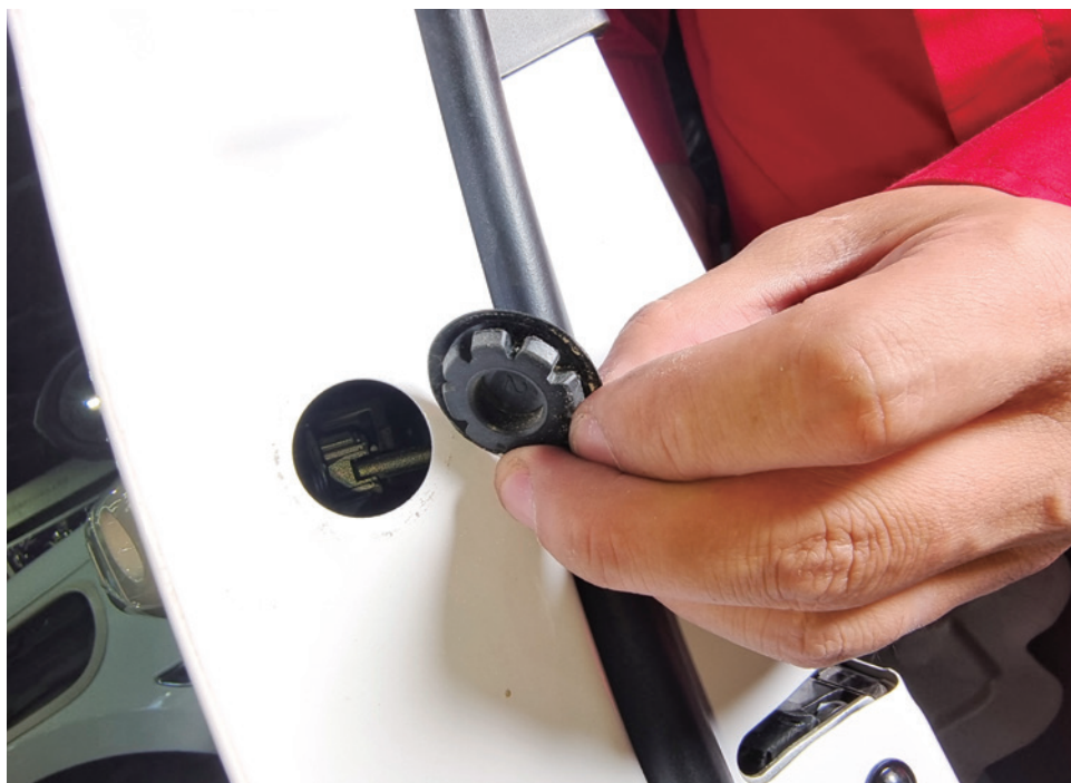
图 4-1-17 拆掉门把手固定螺丝防尘套
