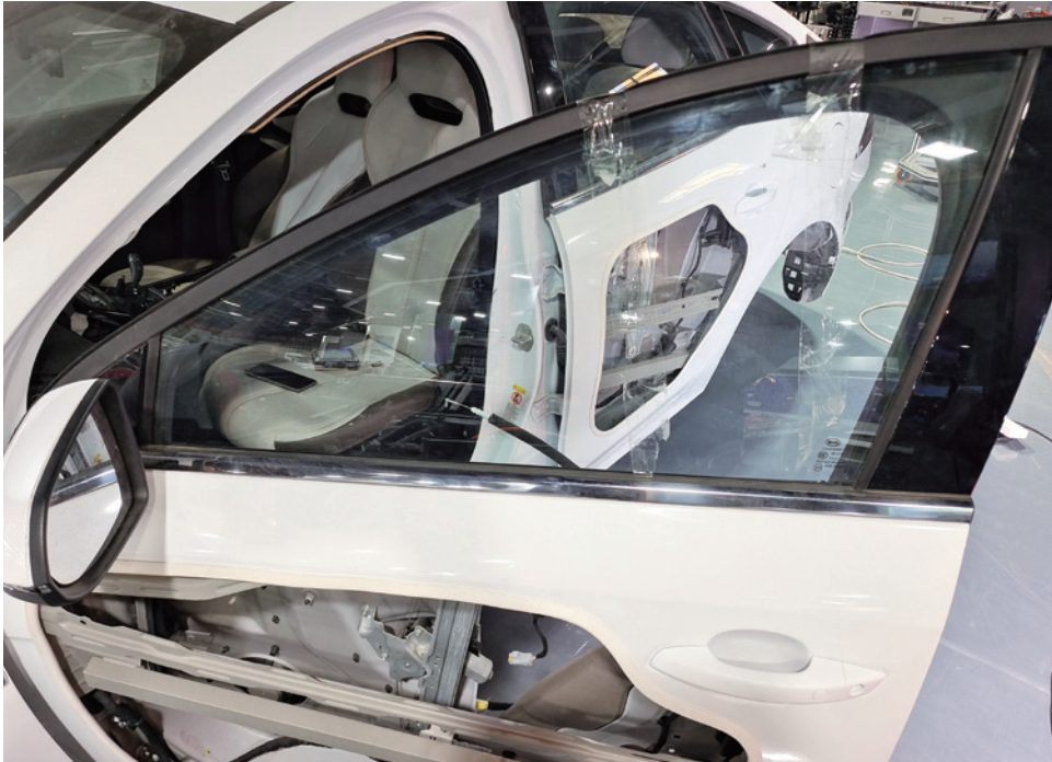
图 3-1-15 车窗玻璃托固定在顶部
