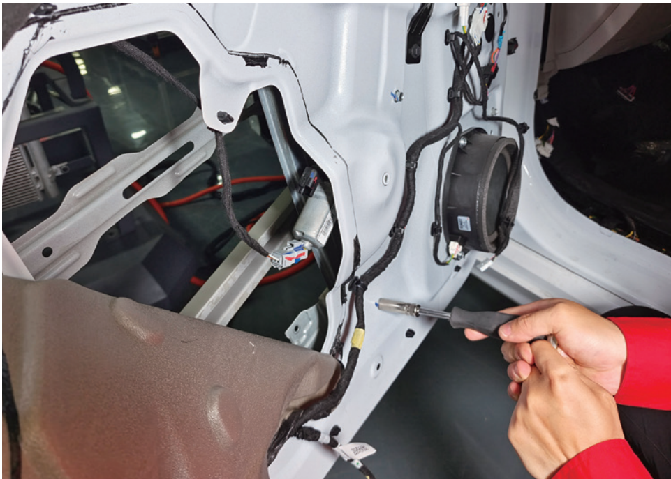
图 3-1-16 拆下电动车窗支架的 3 颗固定螺丝
