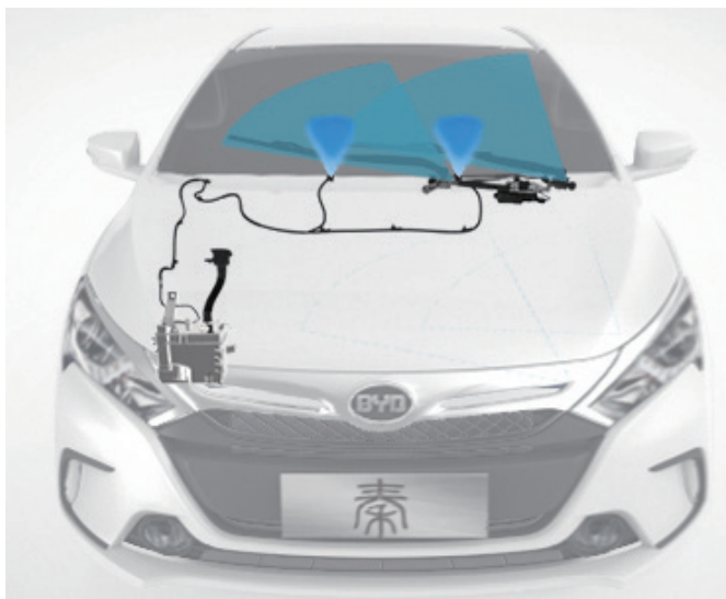
图 2-3-1 洗涤系统的组成
