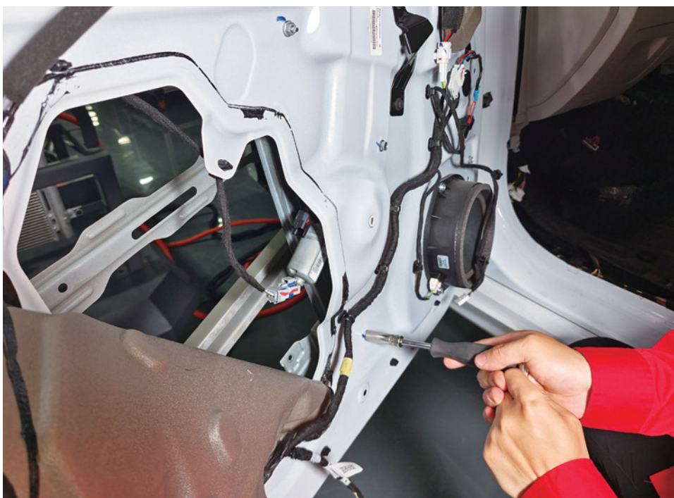
图 3-1-14 拆下电动车窗玻璃内侧固定螺栓
