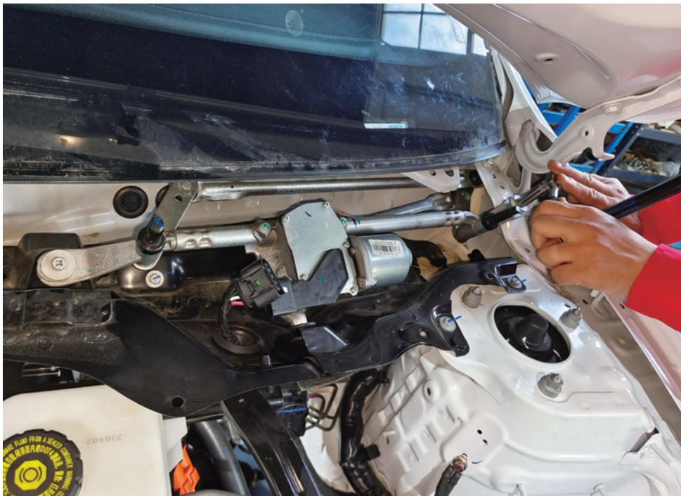
图 2-1-16 拆下雨刷支架固定螺丝
