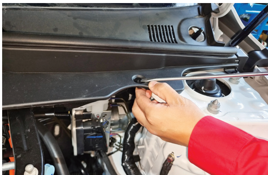
图 2-1-13 拆下挡水槽固定锁扣
