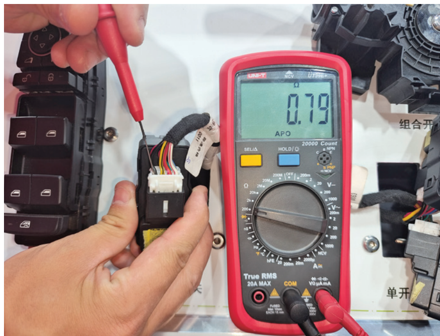
图 3-3-6 U05 插头的 1 号端子接地电阻测量
