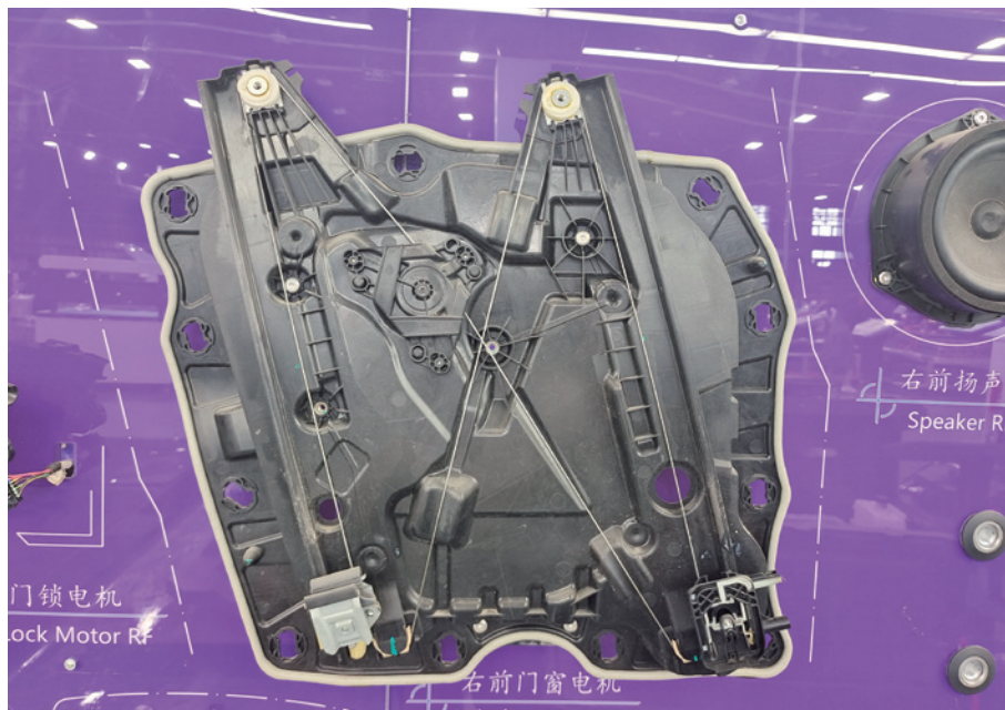
图 3-1-3 绳轮式玻璃升降器结构
