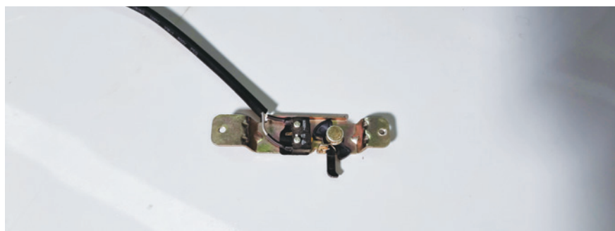
图 7-2-14 天窗滑动打开限位开关未触发状态
