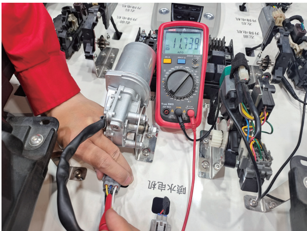
图 2-2-21 测量雨刷电机 B04 插头的 2 号端子电压
