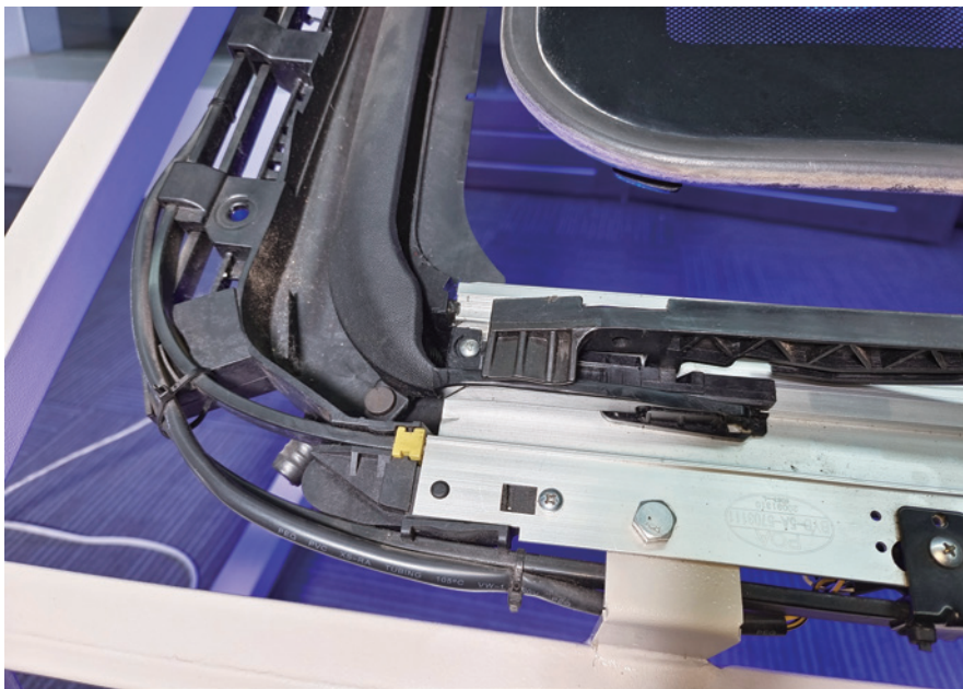
图 7-1-7 支架最前端顶到了车顶
