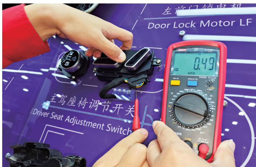
图 6-2-10 比亚迪汉座椅调整开关座椅前进触电的测量
