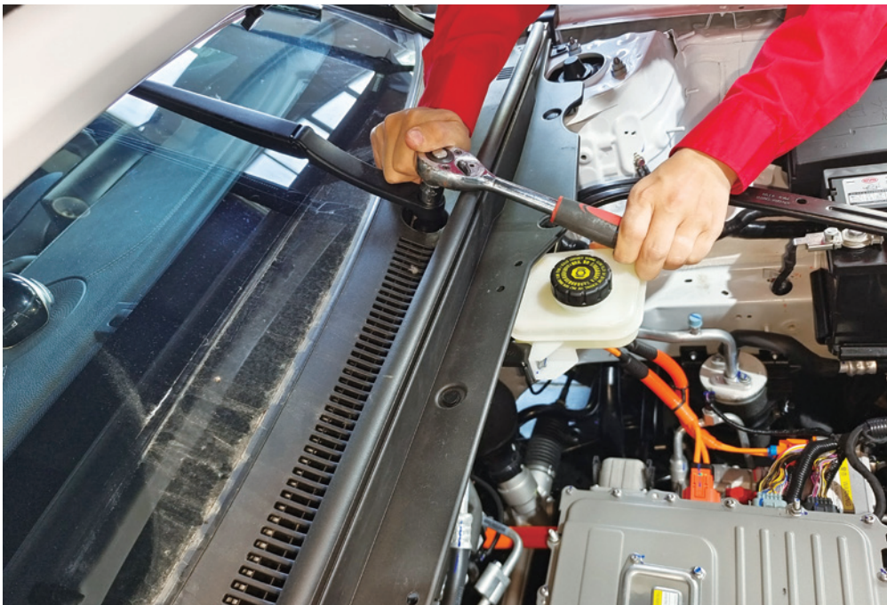
图 2-1-11 拆掉雨刷臂螺栓
