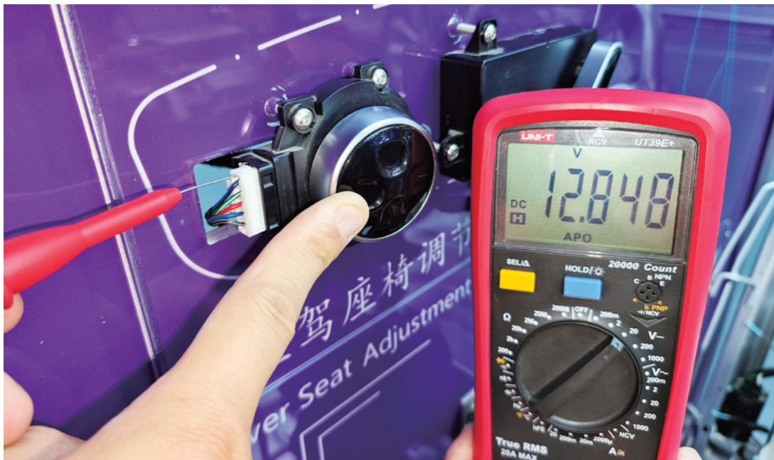
图 6-2-12 比亚迪汉腰垫开关前凸触电的测量
