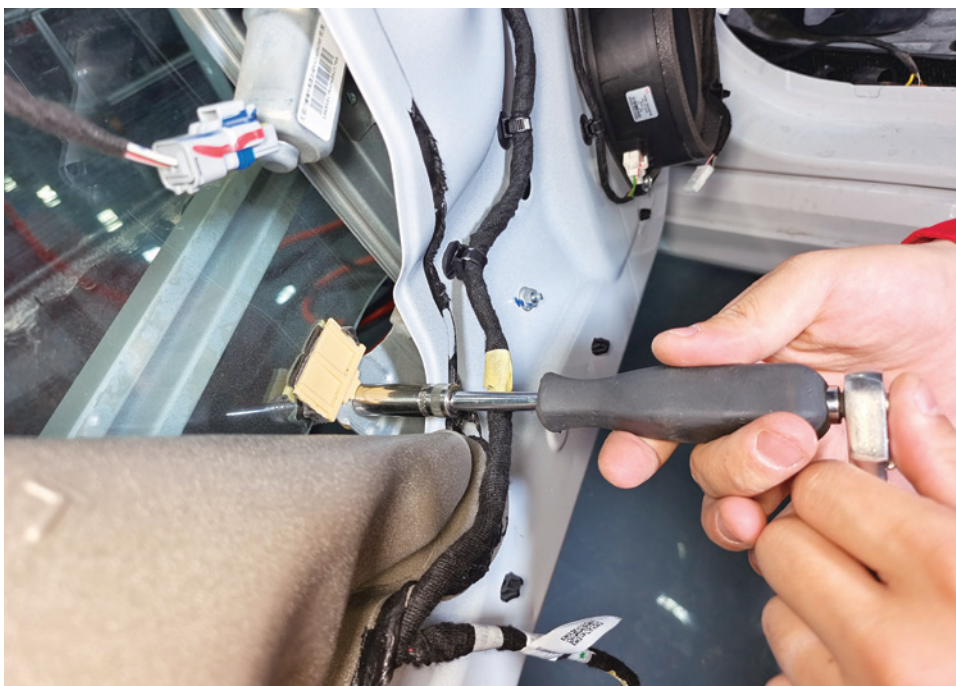
图 3-1-13 拆下电动车窗玻璃外侧固定螺栓
