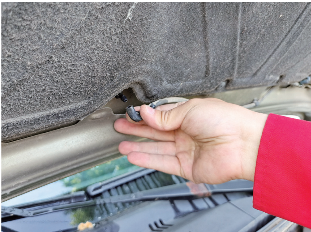
图 2-3-6 断开洗涤系统喷孔
