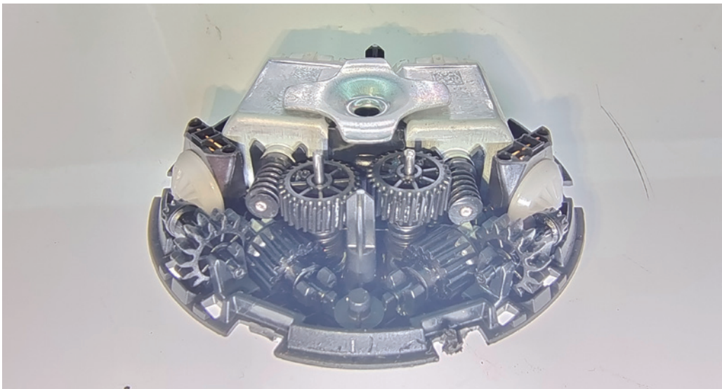
图 5-1-4 蔚来电动倒车镜操纵机构
