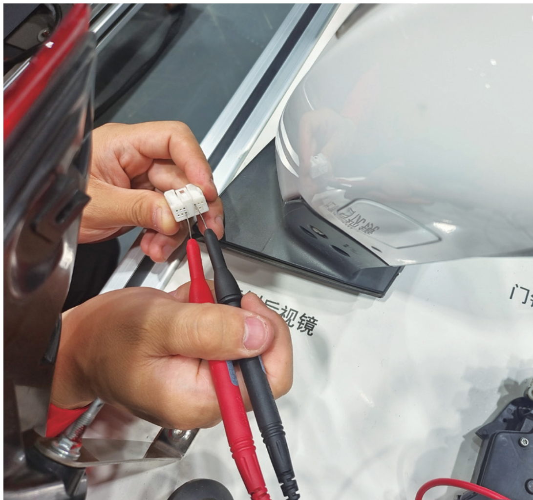
图 5-2-9 电动倒车镜下翻通电实验
