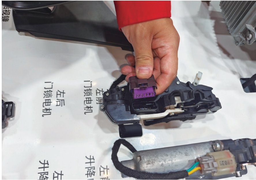
图 4-2-16 拔下左前门锁电机插头 T06
