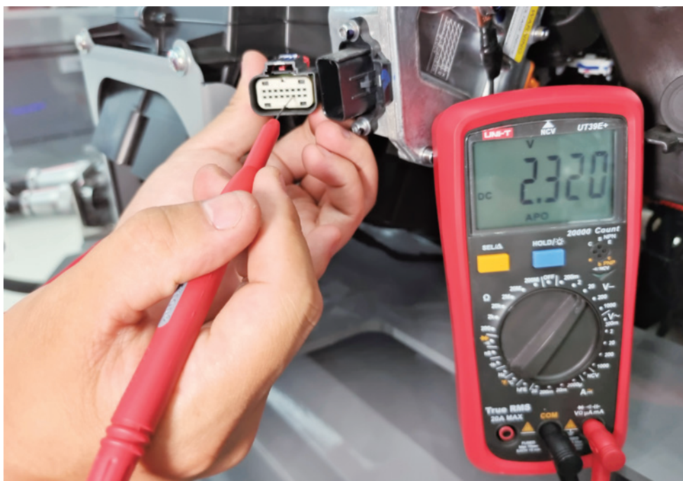
图 2-8-45 GB34 插头 14 号端子电压测量
