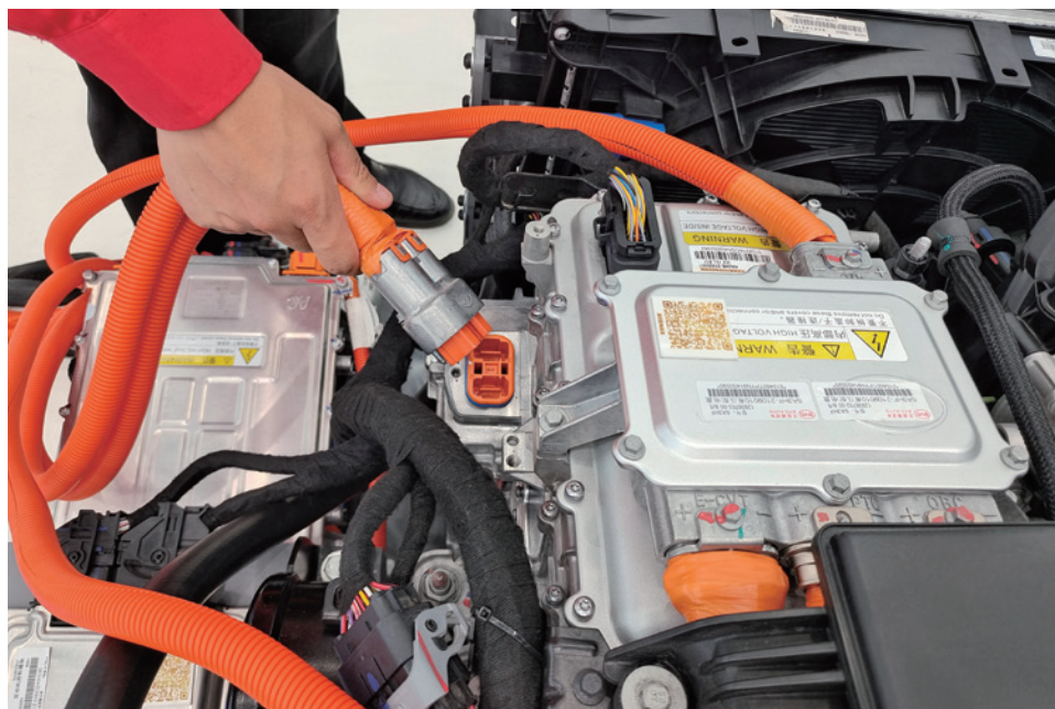
图 2-2-30 拔下双电控高压插头
