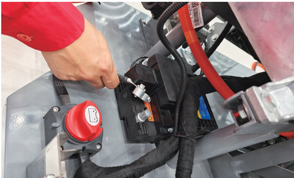
图 2-3-4 断开低压电池负极
