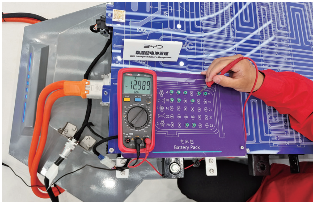
图 2-2-23 BK51 插头的 8 号端子电压测量
