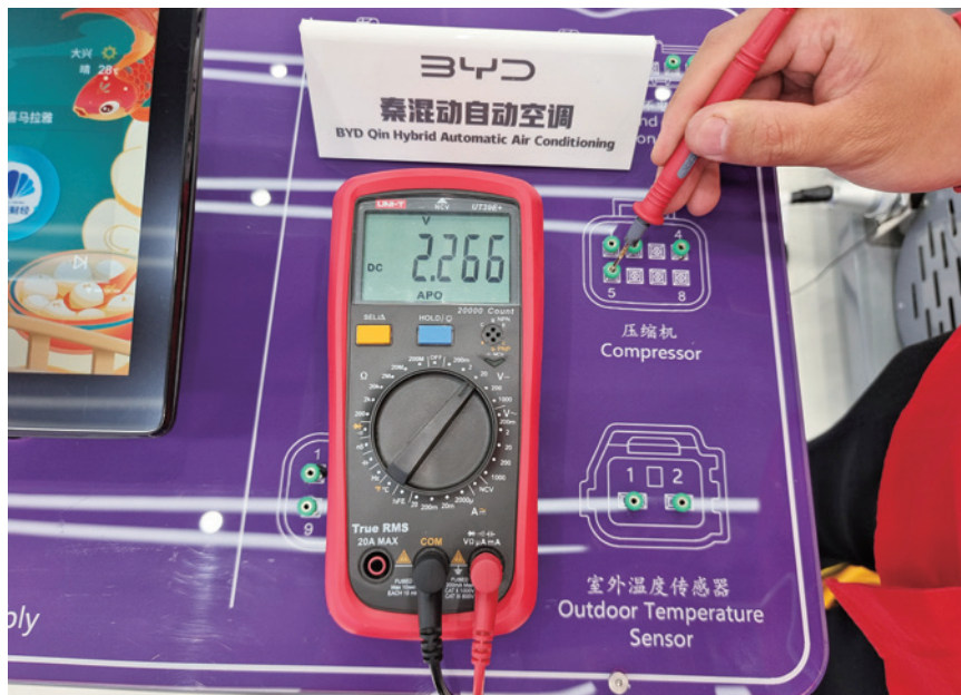
图 2-8-40 A17 插头 5 号端子电压测量
