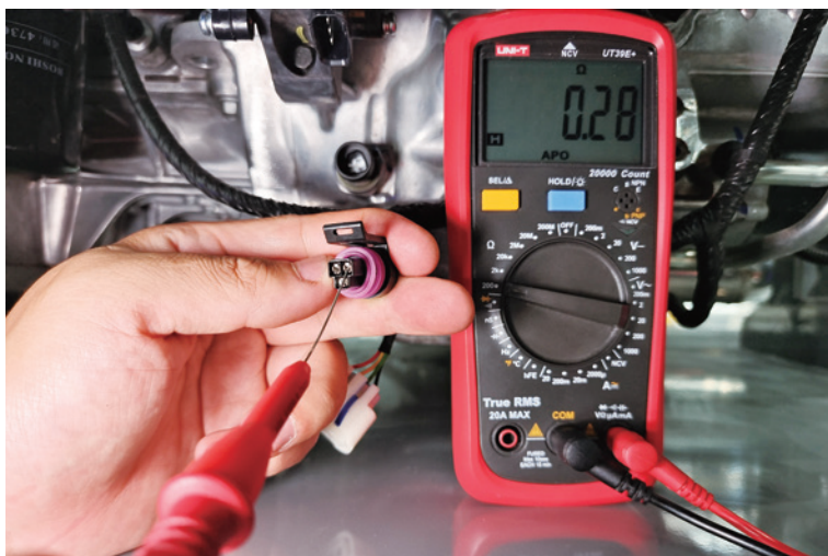
图 2-9-27 离合器压力传感器 2 号端子接地的测量
