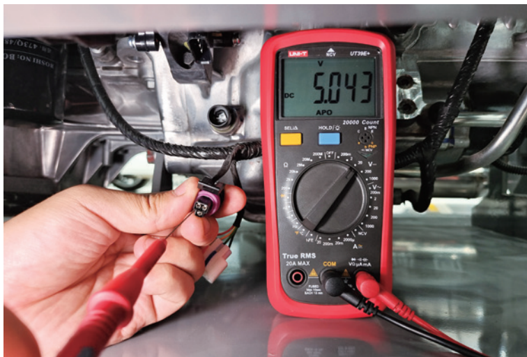
图 2-9-26 离合器压力传感器 1 号端子电压测量
