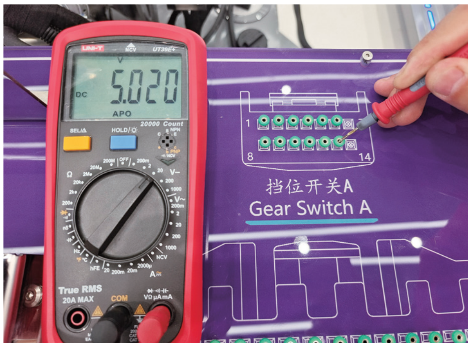
图 2-9-33 G39 插头的 13 号端子电压测量
