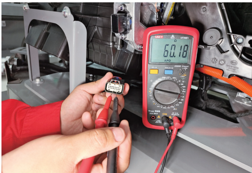
图 2-8-43 GB34 插头 13、14 号端子之间的阻值测量
