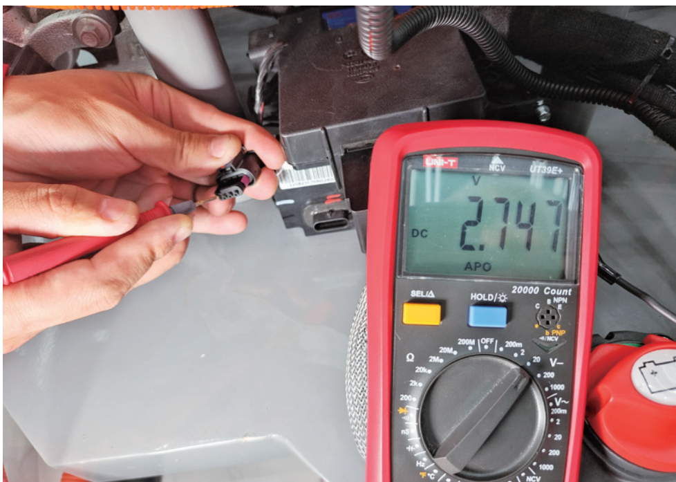
图 2-7-6 K50 插头 1 号端子电压测量
