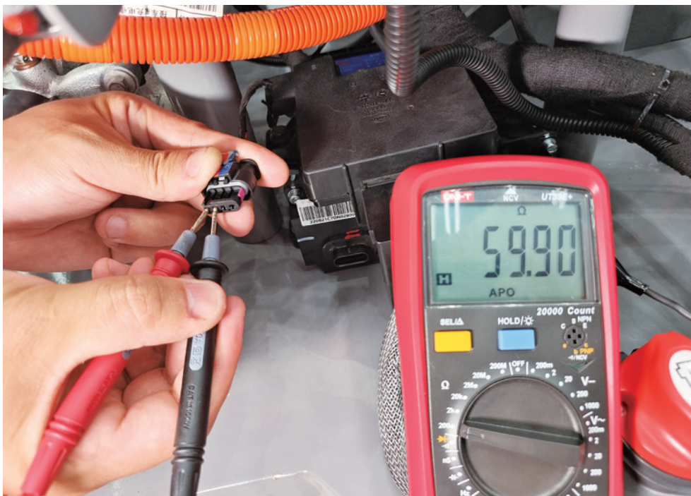
图 2-7-5 K50 插头 1、2 号端子之间阻值测量
