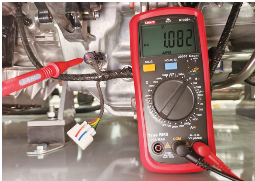
图 2-9-29 压力传感器 3 号端子电压 (结合时)
