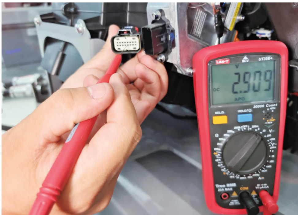
图 2-8-44 GB34 插头 13 号端子电压测量
