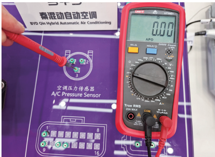
图 2-8-47 B13 插头的 2 号端子接地电阻测量
