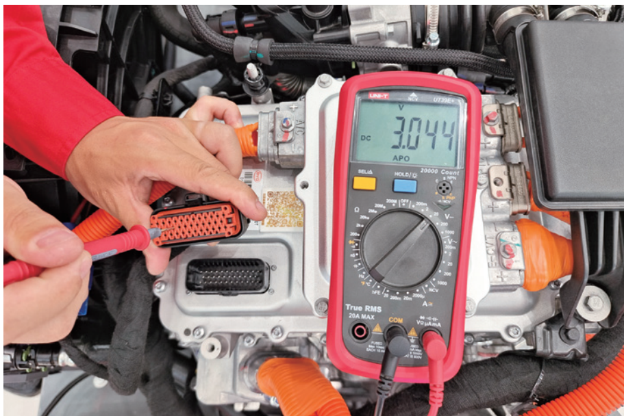
图 2-4-36 AB28 插头 21 号端子电压测量
