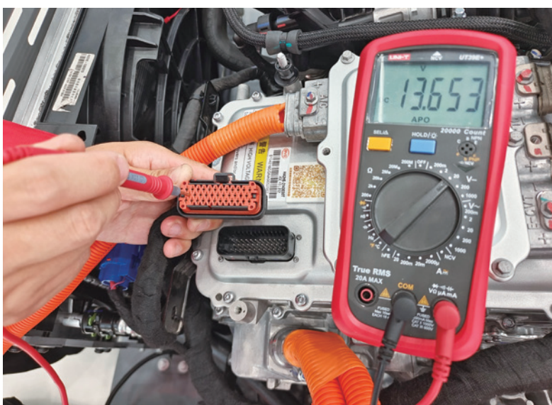
图 2-4-30 AB28 插头的 23 号端子电压测量
