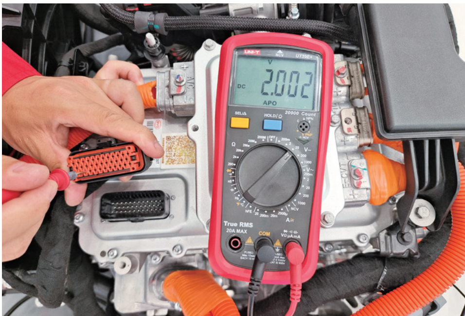
图 2-4-37 AB28 插头 33 号端子电压测量
