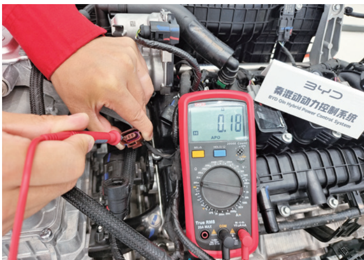
图 2-5-6 凸轮轴位置传感器接地的测量
