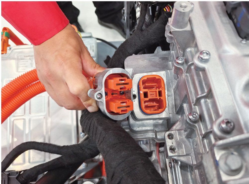
图 2-2-33 双电控高压线束上的互锁插片
