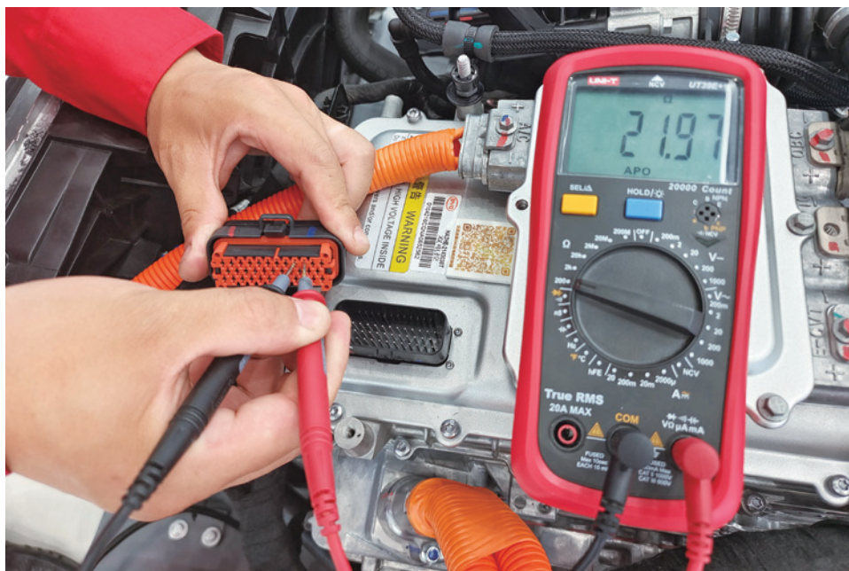
图 2-4-39 驱动电机旋变传感器正弦线圈电阻检测
