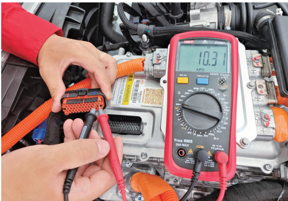
图 2-4-38 驱动电机旋变传感器励磁线圈电阻检测
