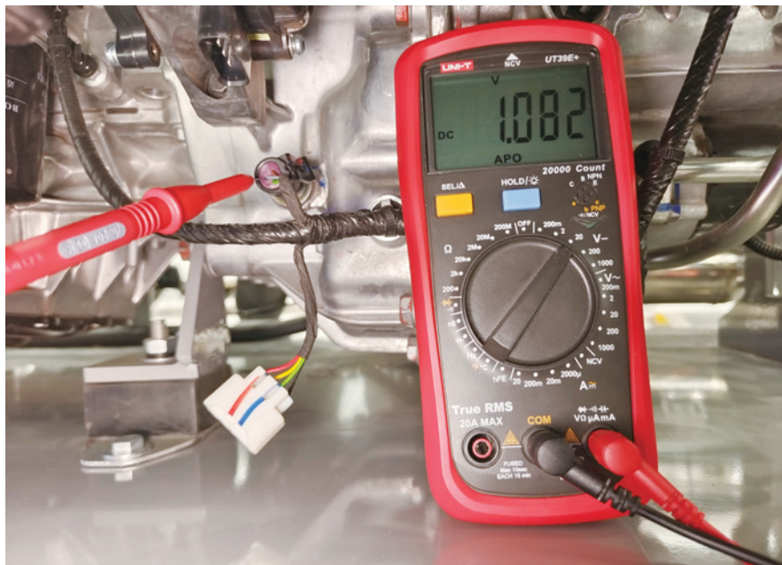
图 2-9-28 压力传感器 3 号端子电压 (未结合时)
