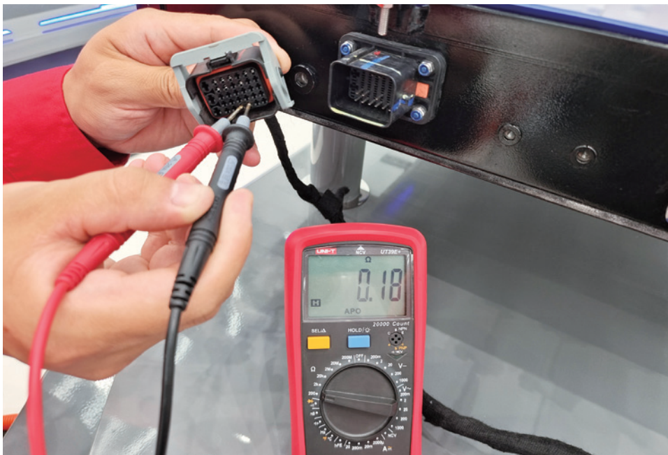
图 2-2-29 BK51 插头 30、31 号端子之间的阻值测量
