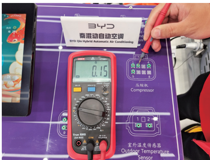
图 2-8-37 A17 插头的 2 号端子接地阻值测量
