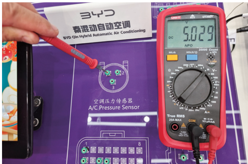
图 2-8-46 B13 插头的 1 号端子电压测量
