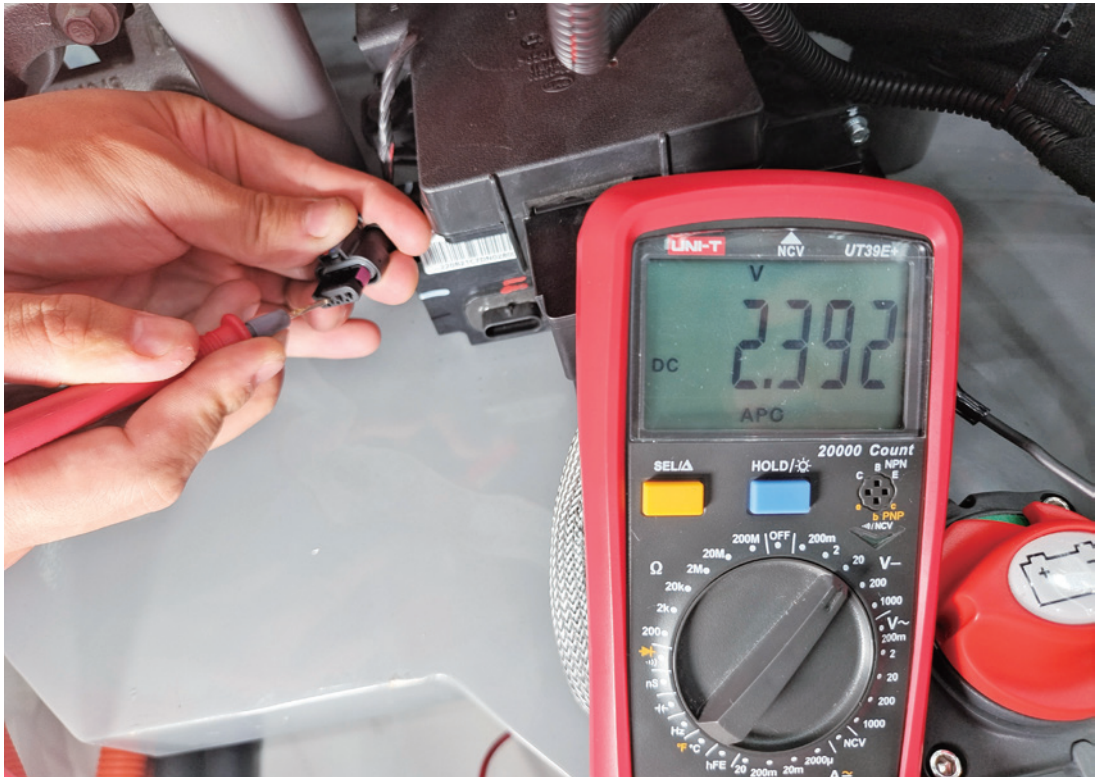
图 2-7-7 K50 插头 2 号端子电压测量
