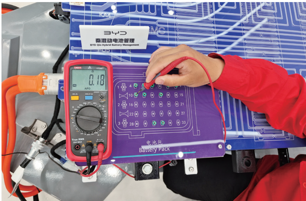
图 2-2-25 BK51 插头的 10 号端子接地阻值测量
