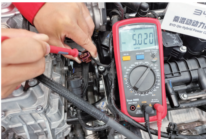
图 2-5-5 凸轮轴位置传感器电源电压的测量
