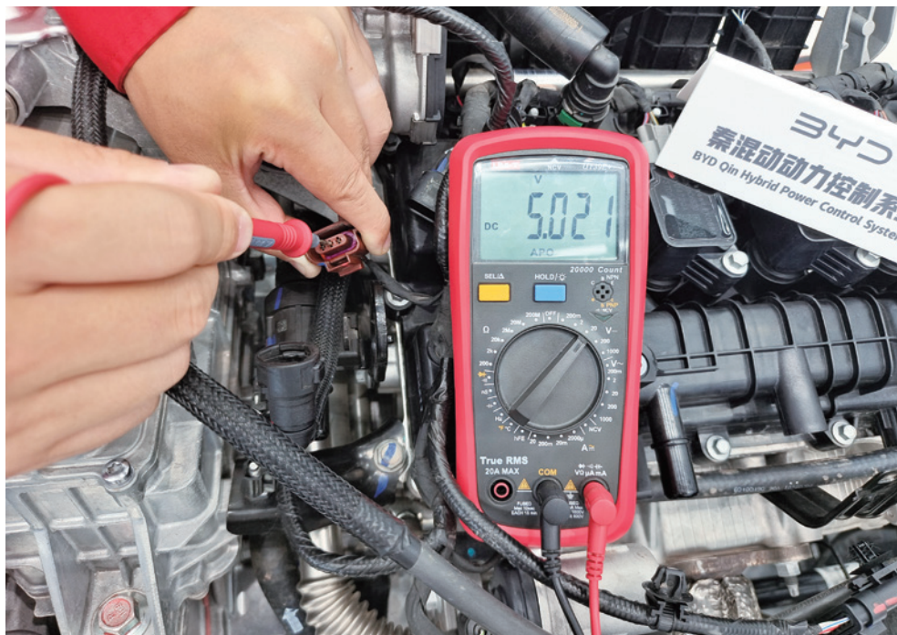
图 2-5-7 凸轮轴位置传感器电源电压的测量
