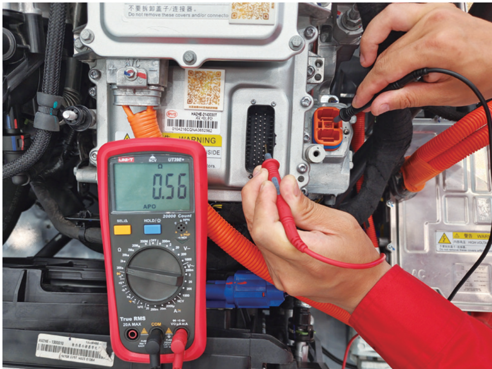
图 2-2-32 双电控高压插头与低压插头互锁端子导通性测量
