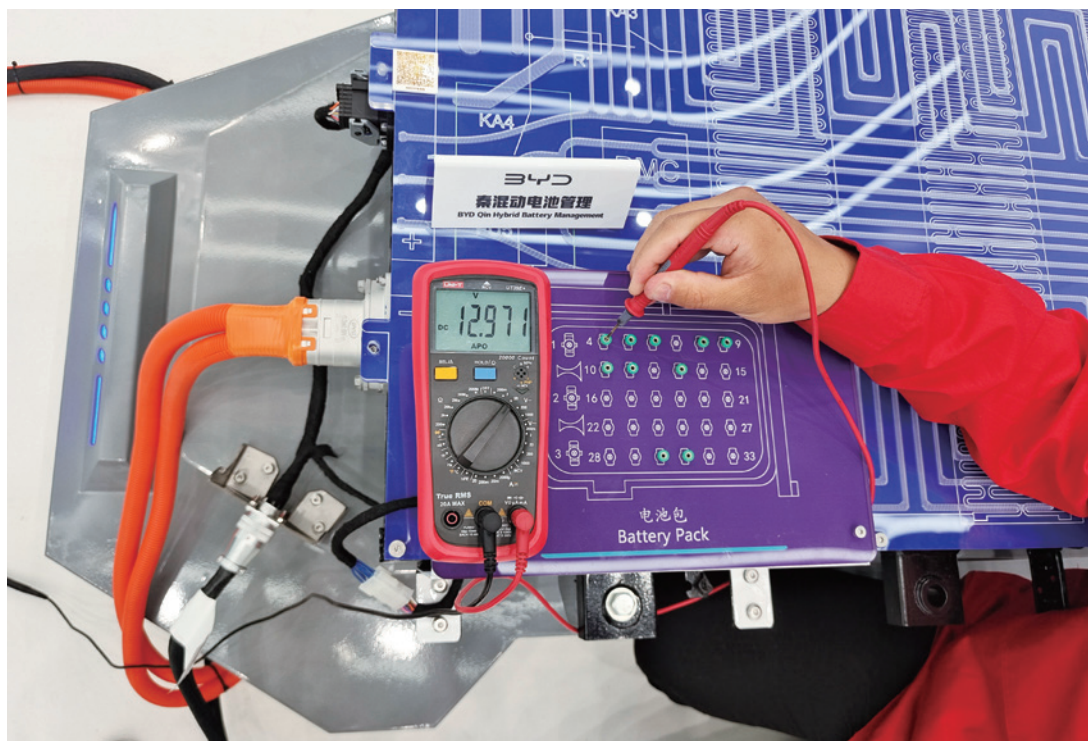
图 2-2-22 BK51 插头的 4 号端子电压测量
