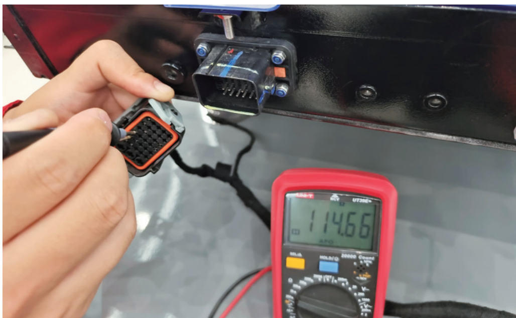
图 2-2-26 BK51 插头的 5、6 号端子之间的阻值测量
