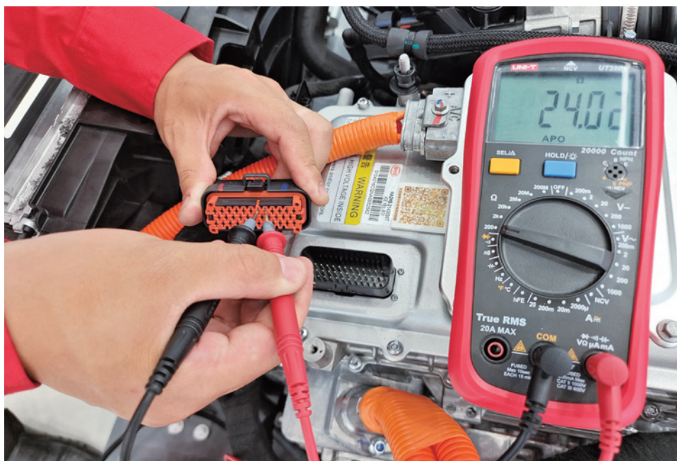
图 2-4-40 驱动电机旋变传感器余弦线圈电阻检测
