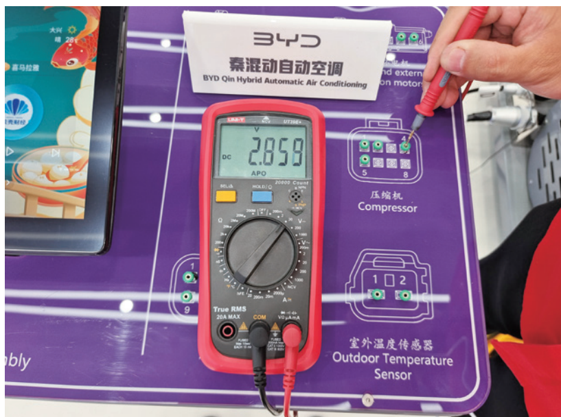
图 2-8-39 A17 插头 4 号端子电压测量
