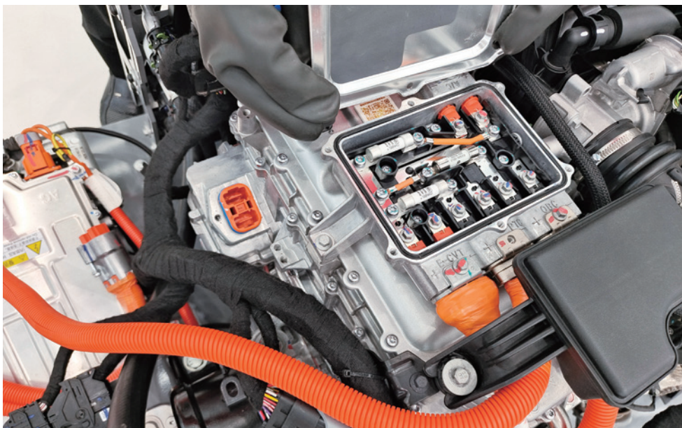
图 2-3-5 拆下高压配电箱上方谐振腔
