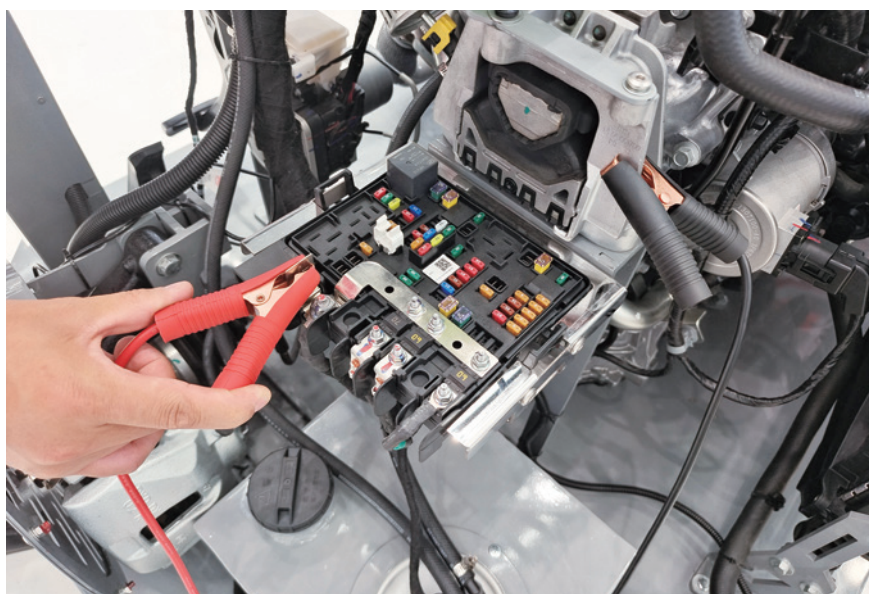
图 2-7-4 外接 12V 电源唤醒启动铁电池
