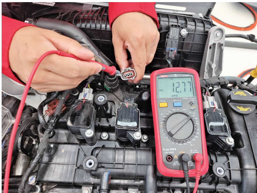
图 2-5-10 点火线圈电源电压的测量
