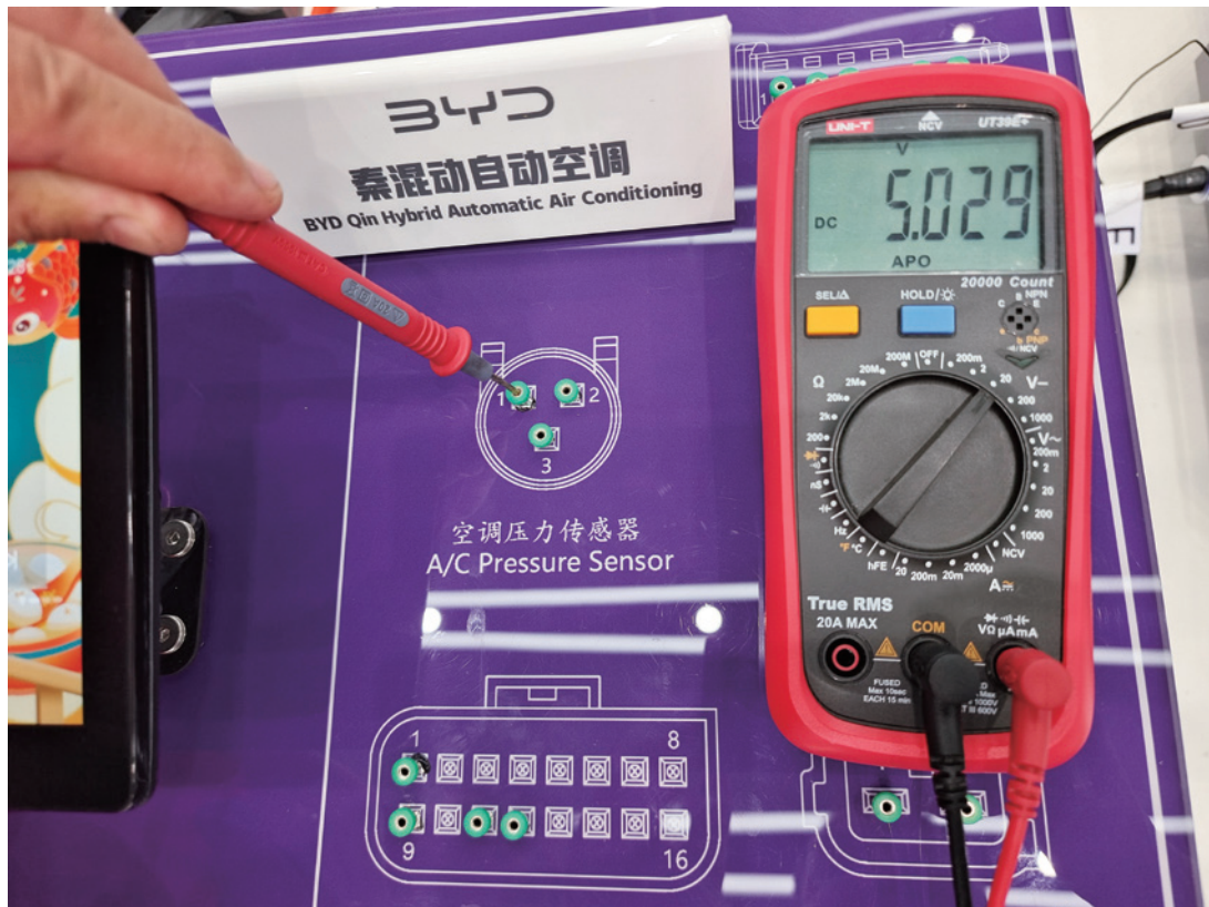
图 2-8-48 B13 插头的 3 号端子电压测量
