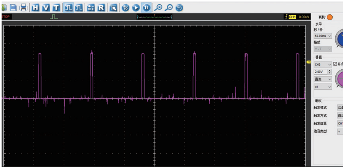
图 2-5-13 点火线圈信号波形
