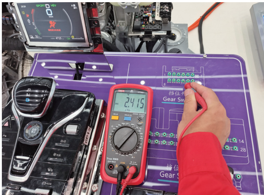
图 2-9-35 G39 插头 11 号端子电压测量（档杆置中时）
