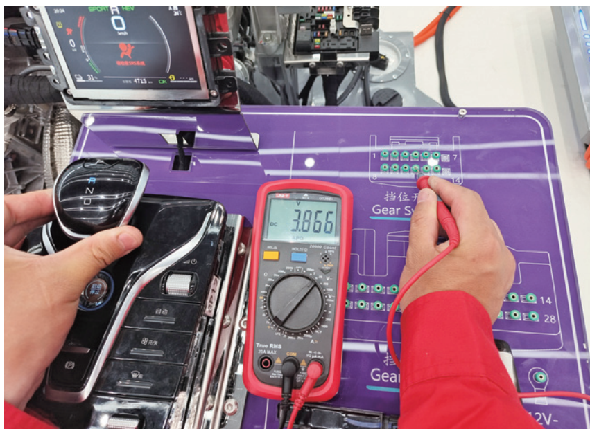
图 2-9-36 G39 插头 11 号端子电压测量（上推到顶时）
