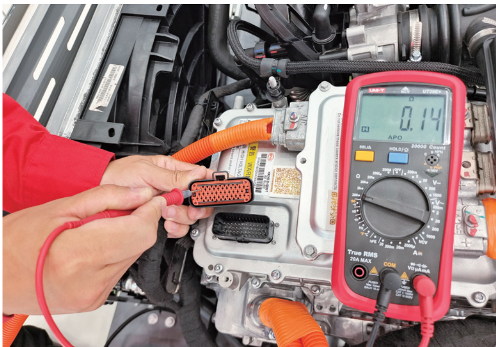
图 2-4-32 AB28 插头的 11 号端子接地阻值测量
