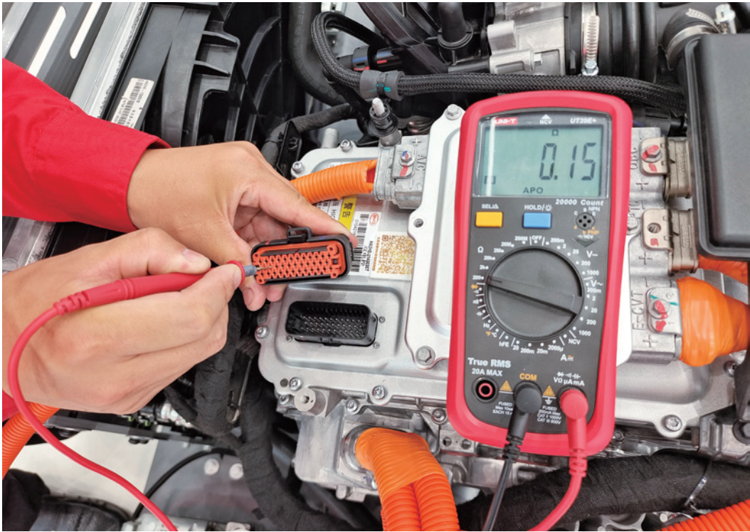
图 2-4-33 AB28 插头的 22 号端子接地阻值测量
