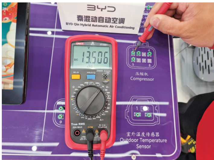
图 2-8-36 A17 插头的 1 号端子电压测量
