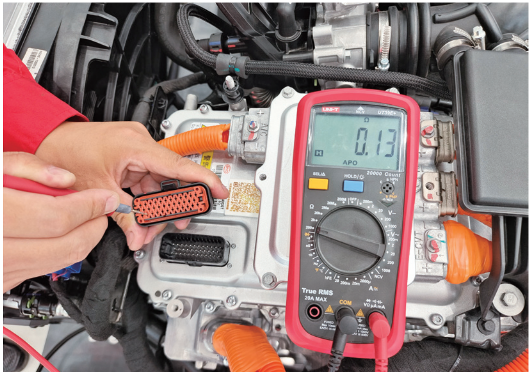
图 2-4-34 AB28 插头的 34 号端子接地阻值测量
