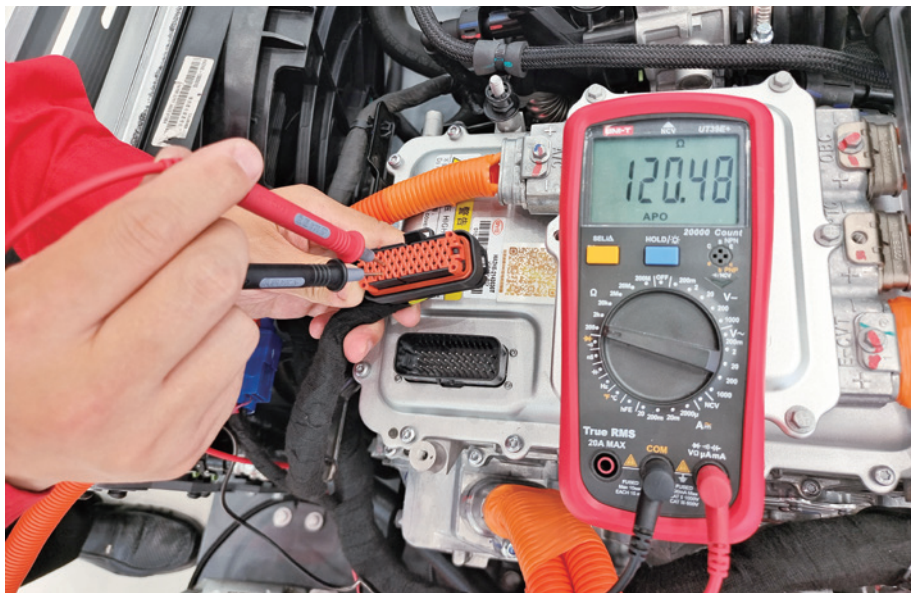
图 2-4-35 AB28 插头 21、33 号端子之间的阻值测量
