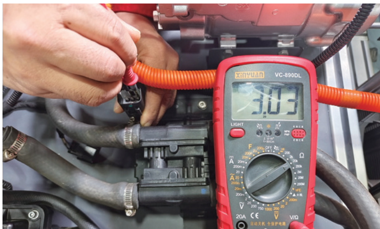
图 4-1-20 B56 插头 2、3 号端子之间阻值
