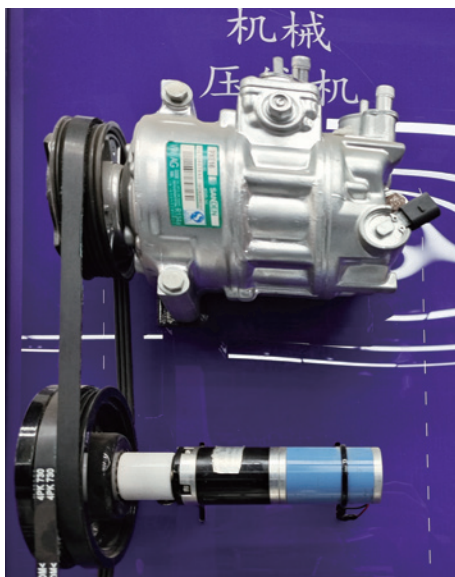
图 2-2-1 燃油车压缩机的驱动方式
