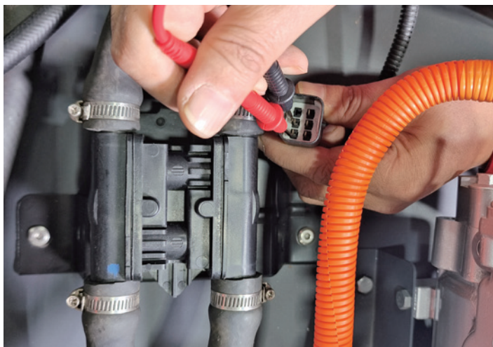
图 4-1-17 四通水阀供电实验
