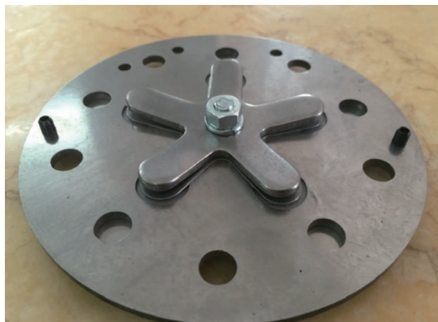
图 2-2-7 阀板上的吸气簧片和排气簧片
