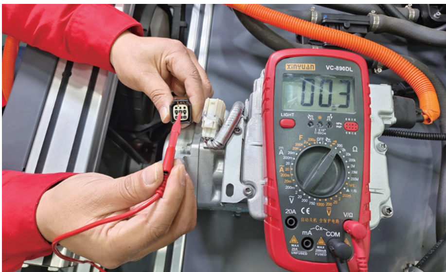
图 2-2-24 电动压缩机 BA17 插头的 2 号端子测量
