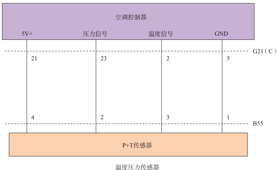
图 6-1-14 秦 EV 压力温度传感器电路
