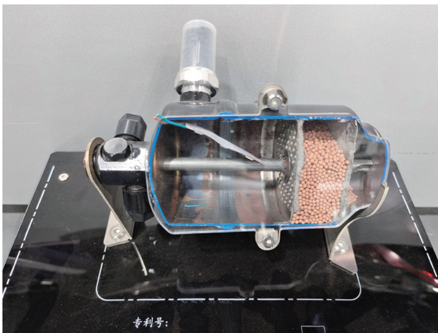
图 2-1-13 储液瓶干燥瓶
