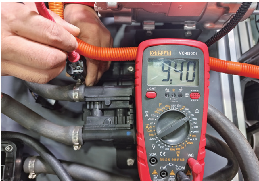
图 4-1-18 B56 插头 1、3 号端子之间阻值
