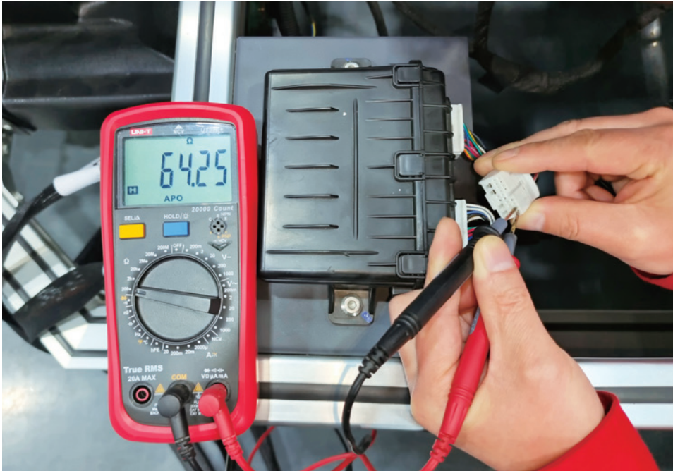
图 6-3-16 空调控制器 G21 (B) 插头的 18、17 号端子之间阻值测量
