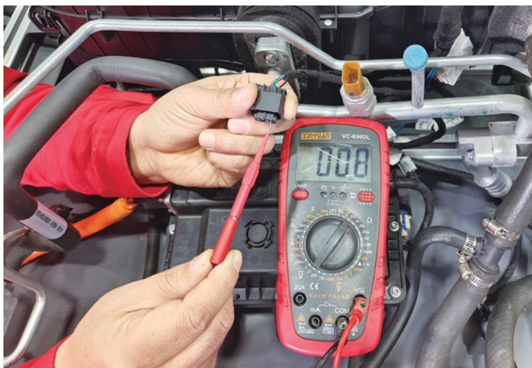
图 6-1-16 B55 插头的 1 号端子测量
