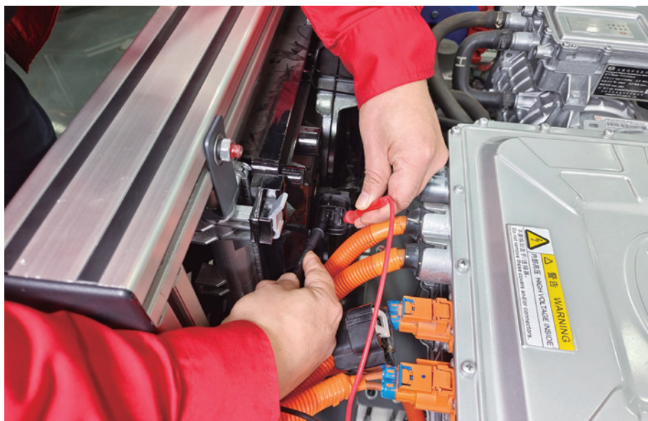
图 2-3-20 双速风扇高速供电测试
