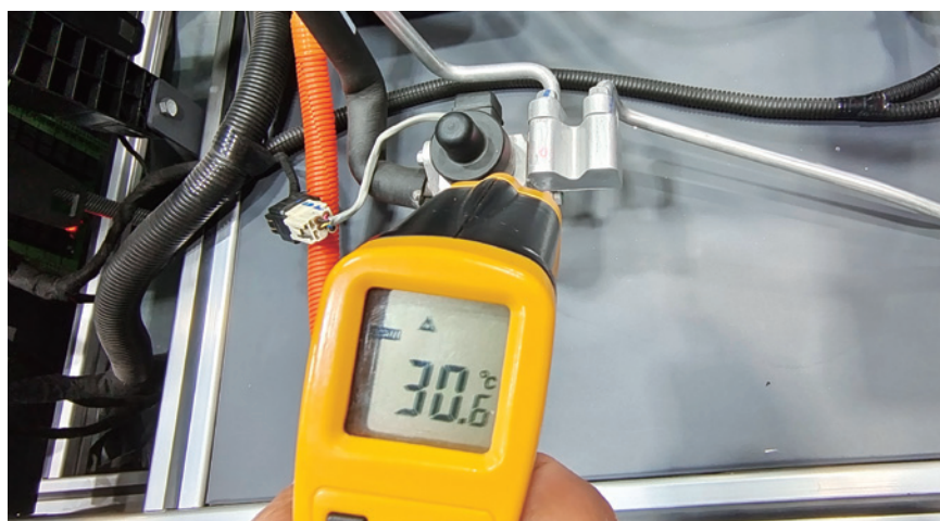
图 2-1-21 膨胀阀进口温度
