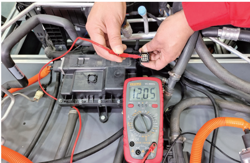
图 2-2-28 PTC 的 B34 插头的 1 号端子测量
