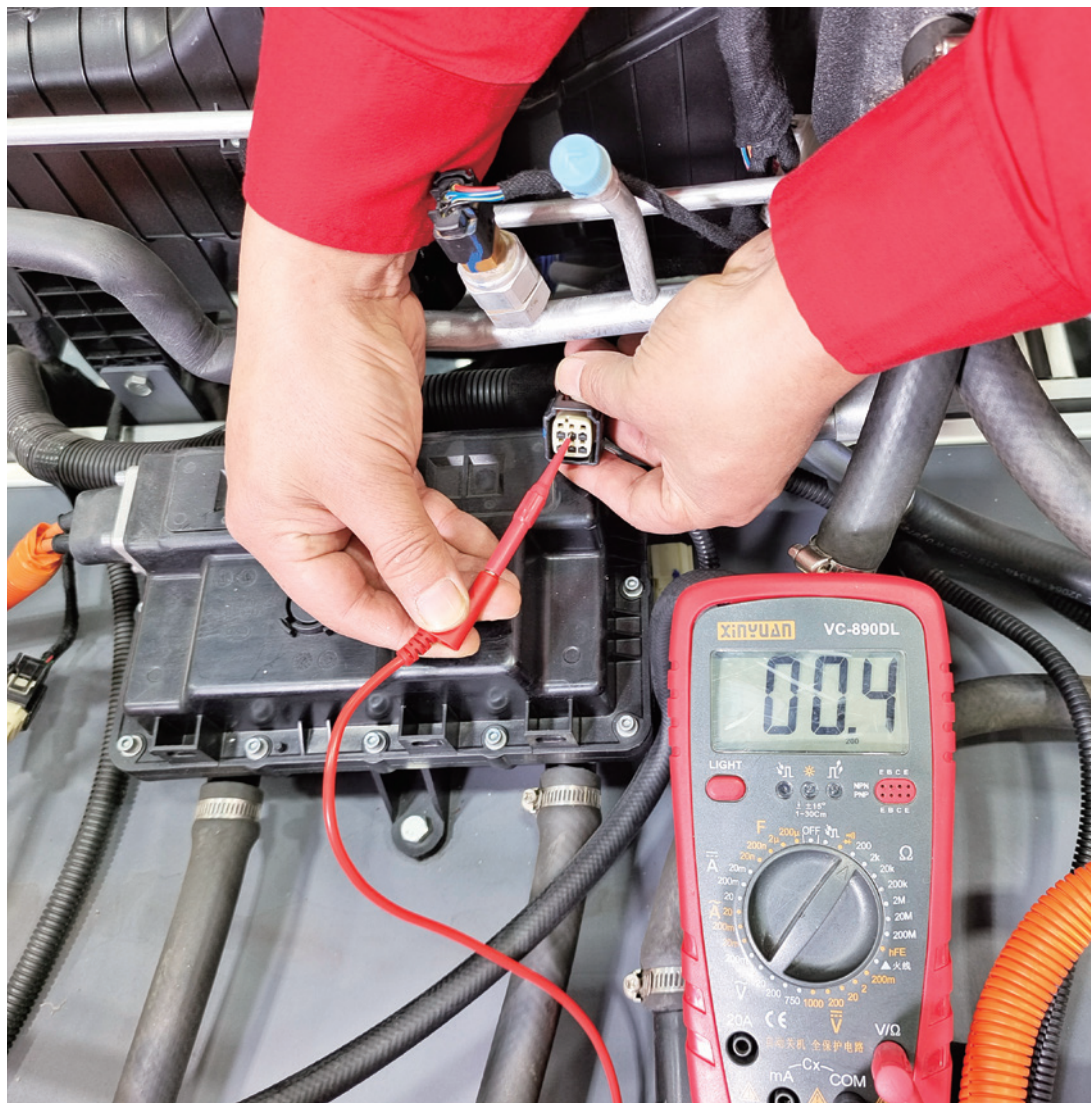
图 2-2-29 B34 插头的 2 号端子测量
