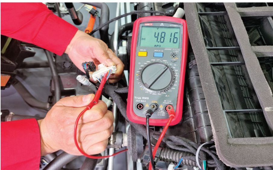
图 5-2-24 G22 插头 21 号端子电压测量
