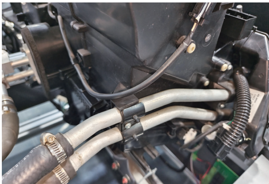
图 3-1-10 燃油车暖风水芯冷却液接口
