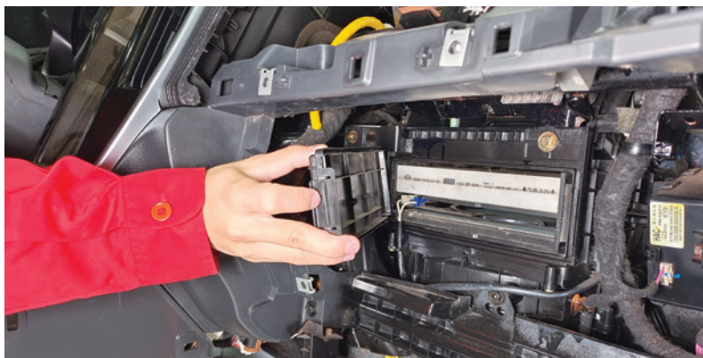
图 5-3-9 拆下空气滤芯盖
