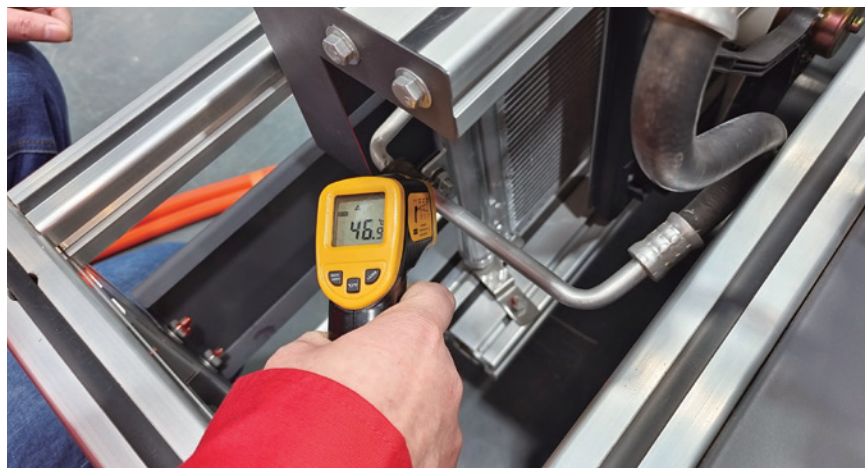
图 2-1-19 冷凝器进口温度
