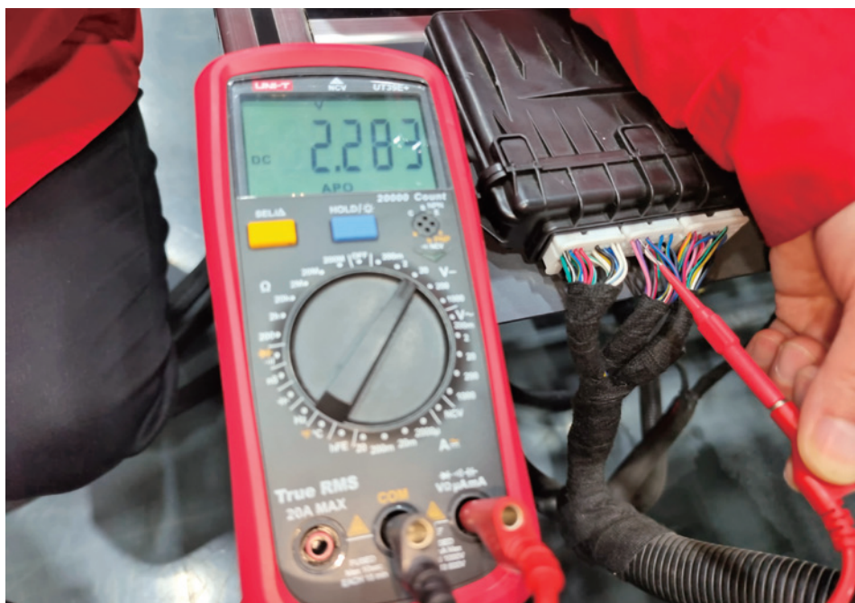
图 6-3-15 空调控制器 G21 (B) 插头的 17 号端子电压测量
