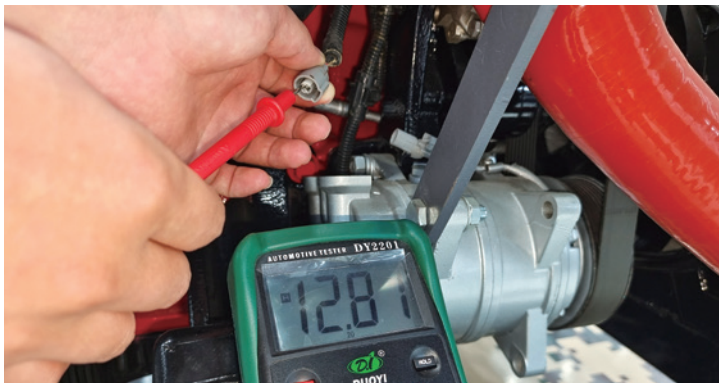
图 2-2-20 电磁离合器的电源端子测量
