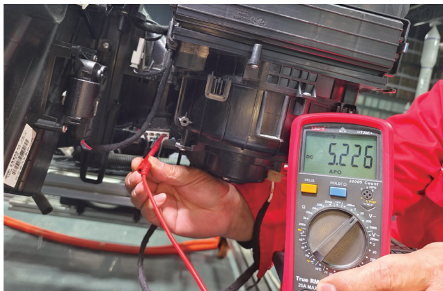
图 2-3-26 测量鼓风机调速模块 G24 插头的 4 号端子电压
