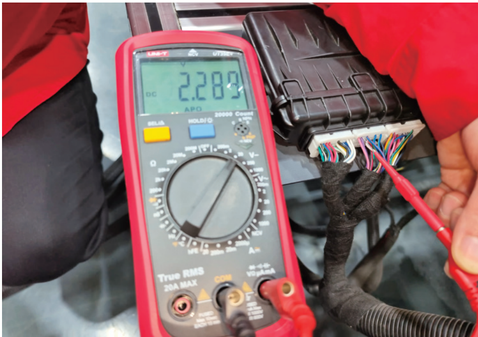
图 6-3-14 空调控制器 G21 (B) 插头的 18 号端子电压测量
