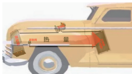
图 4-2-2 驾驶室制热原理
