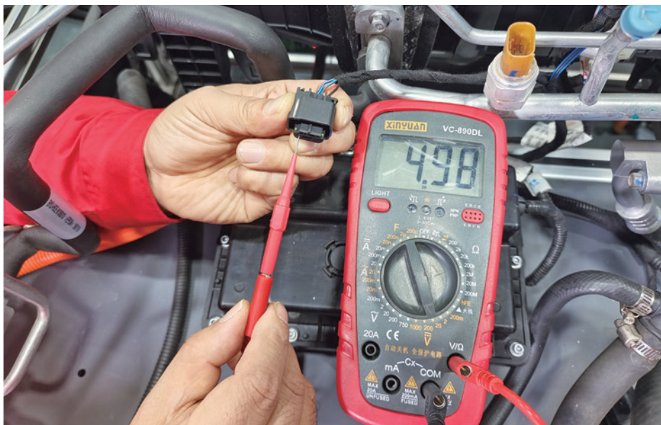
图 6-1-15 B55 插头的 4 号端子测量
