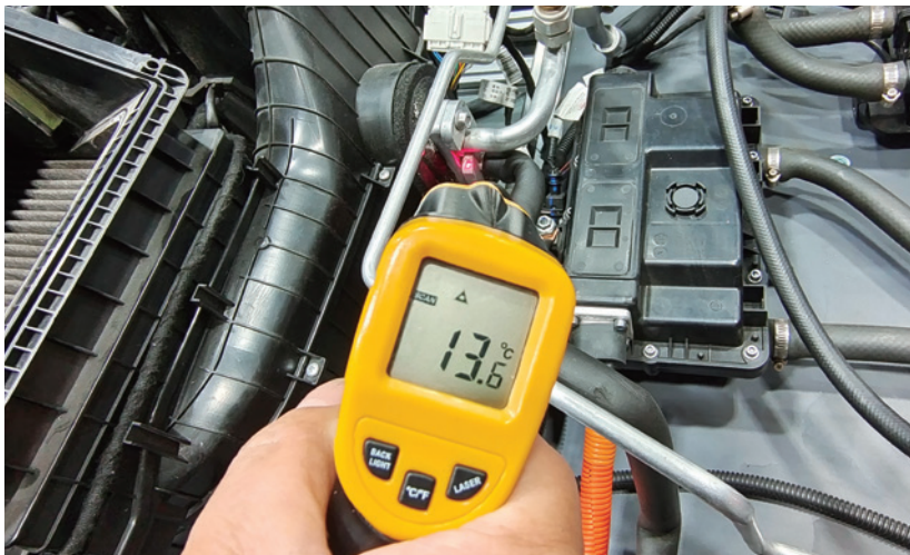
图 2-1-23 蒸发箱进口温度
