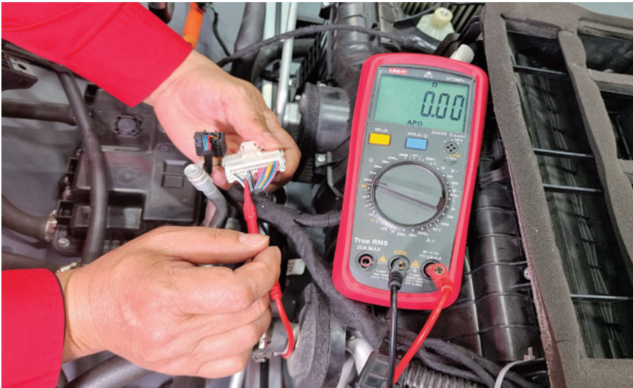
图 5-2-23 G22 插头 11 号端子接地测量
