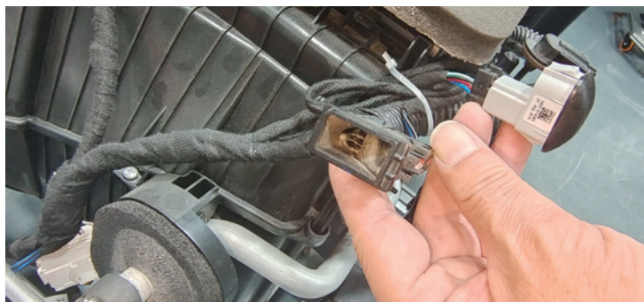
图 6-1-6 秦 EV 车外温度传感器
