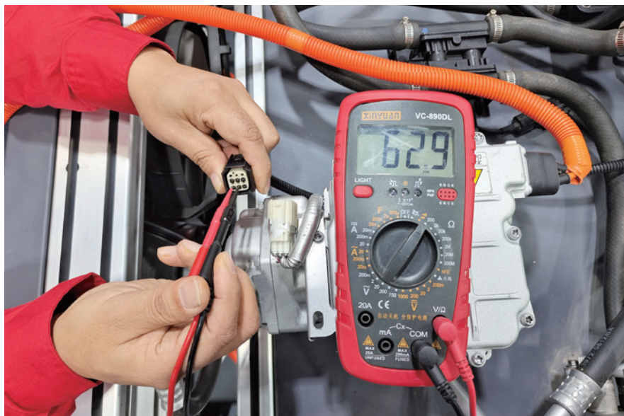
图 2-2-26 BA17 插头的 4、5 号端子测量
