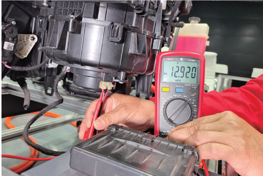
图 2-3-24 测量鼓风机电源 G23 插头的 2 号电压
