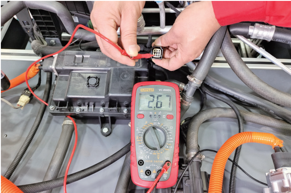
图 2-2-30 B34 插头的 4 号端子测量 3
