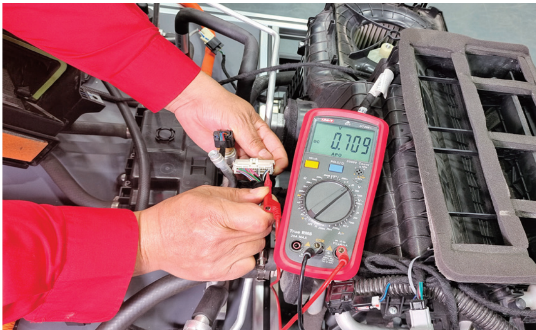
图 5-2-25 G22 插头 16 号端子电压测量
