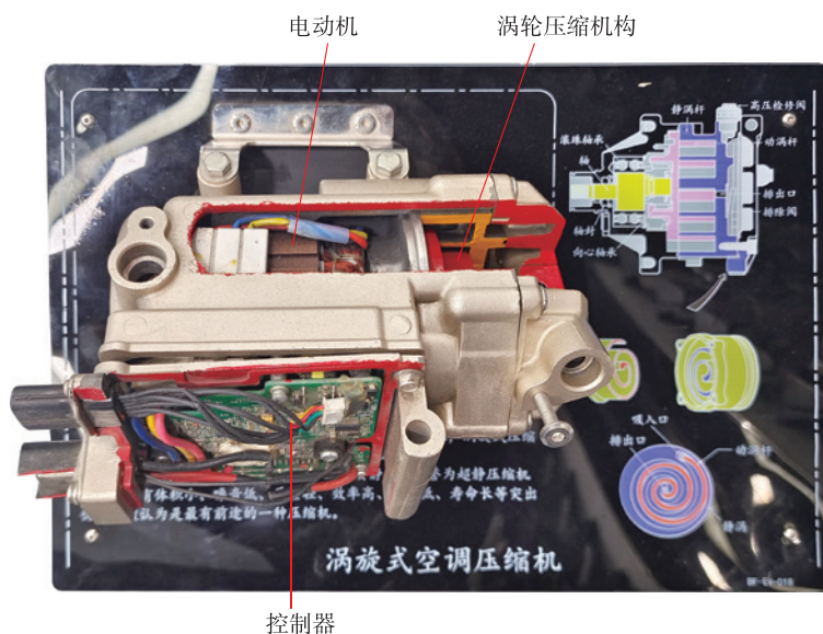
图 2-2-14 电动压缩机结构
