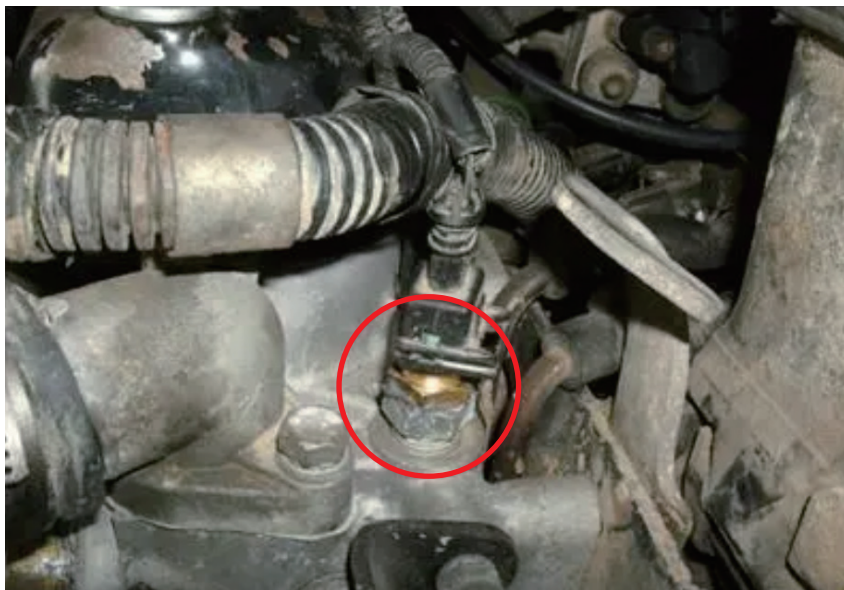
图 6-1-9 燃油车冷却液温度传感器
