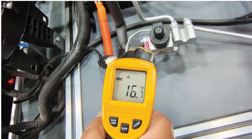
图 2-1-22 膨胀阀出口温度
