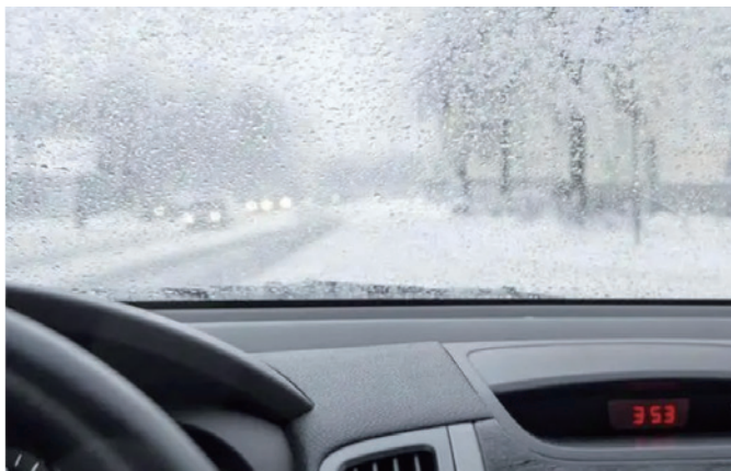
图 3-1-2 汽车玻璃的雾霜
