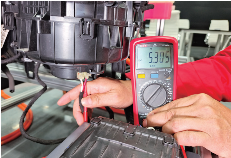
图 2-3-25 测量鼓风机电源 G23 插头的 1 号电压
