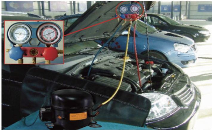
图 2-5-11 打压实验（表组及打压泵空调系统连接图）
