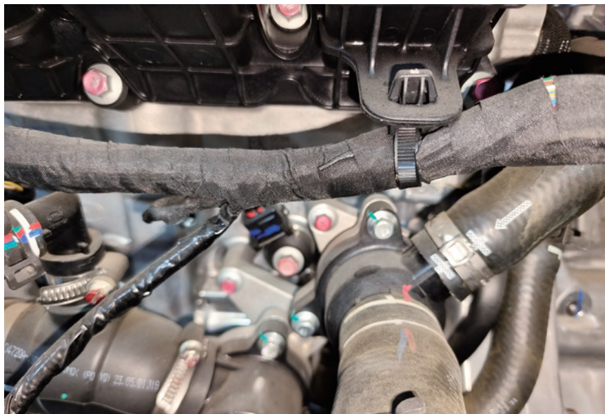
图 3-1-9 暖风水管与发动机的接口
