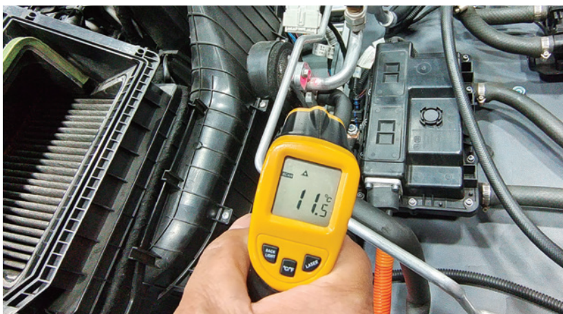
图 2-1-24 蒸发箱出口温度
