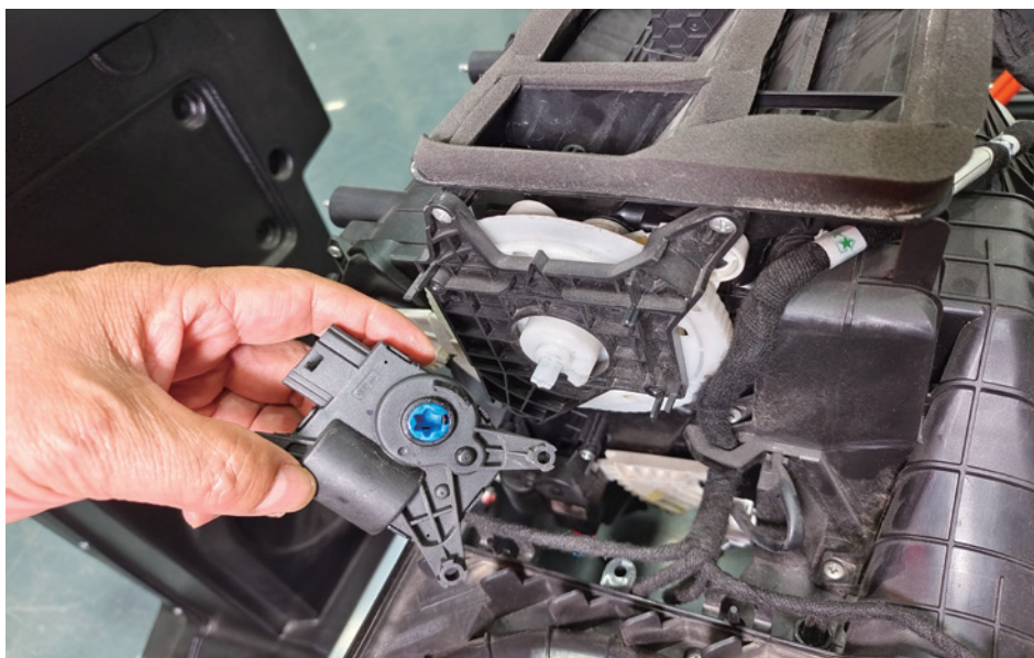
图 5-2-18 拆下伺服电机
