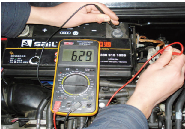
图 6-3-5 电流表串接在负极电缆中检测
