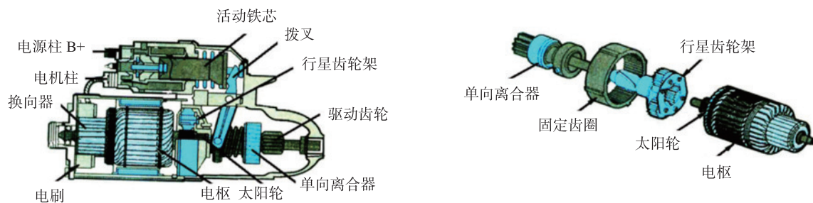
图 7-3-3 行星齿轮减速起动机剖面图
