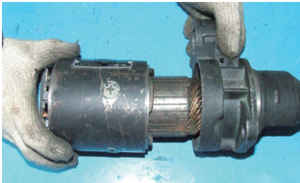
图 7-2-22 拆卸电刷架及定子线圈
