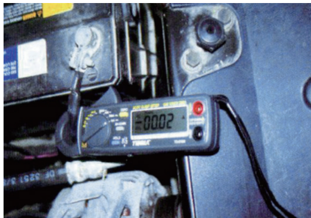
图 6-3-6 钳式电流表卡在负极电缆上检测
