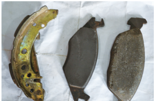
图 5-4-8 拆下前、后制动摩擦片
