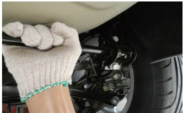
图 3-6-4 后稳定杆的检查
