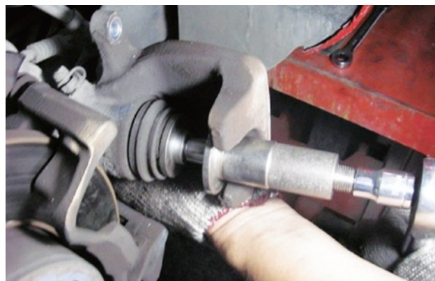
图 5-4-3 制动分泵的回位处理
