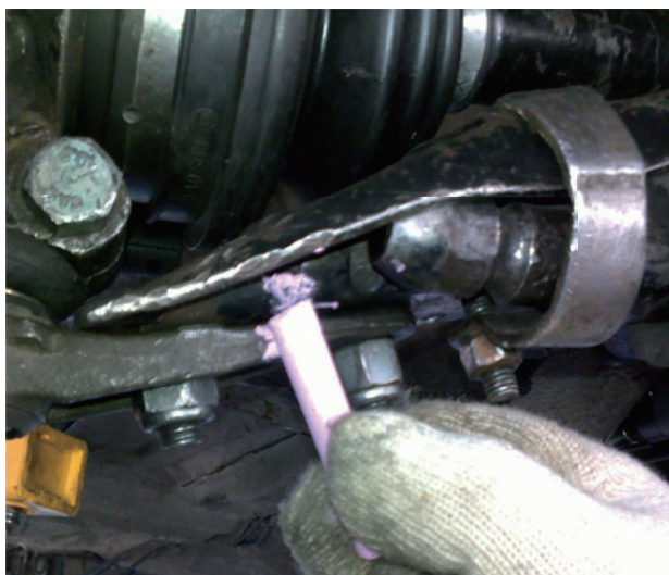
图 2-6-8 摆臂与球接头连接处做安装位置标记
