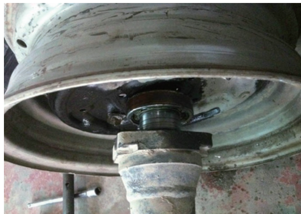
图 2-6-24 将车轮重新装回并紧固轮胎螺丝
