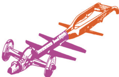
图3-2-5 综合式车架示意图
