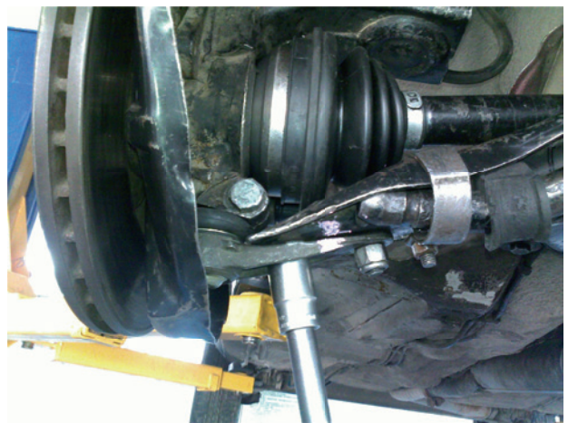
图 2-6-9 拆下锁板的两个紧固螺母
