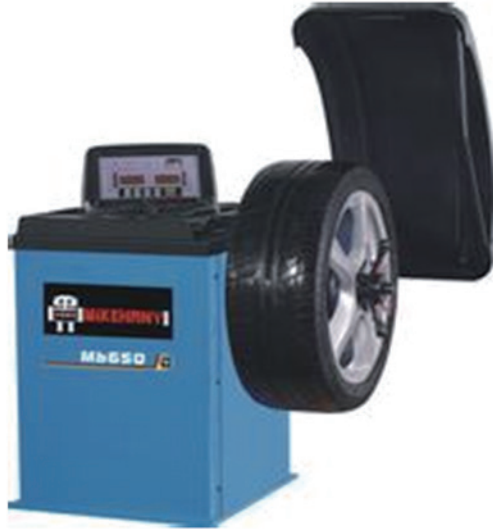
图 3-6-9 将车轮固定在平衡机主轴上
