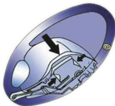
图 4-3-2 吸能式转向盘变形示意图
