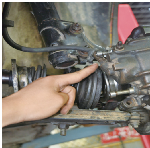
图 5-4-4 制动分泵管路的检查
