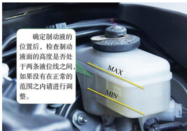
图 2-6-2 制动液面位置检查
