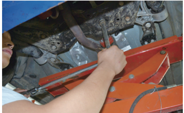
图 3-6-2 车桥与托架的紧固状况
