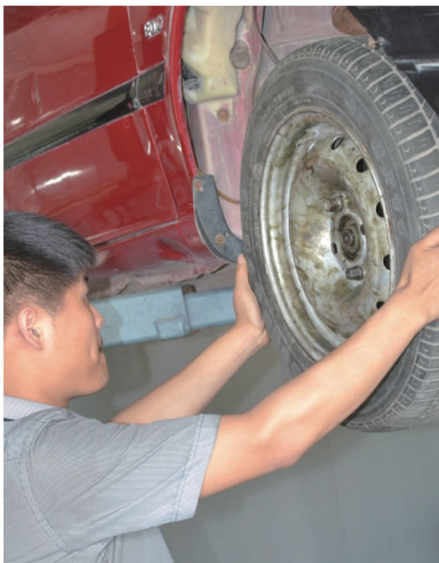
图 3-6-7 轮毂轴承间隙的检查
