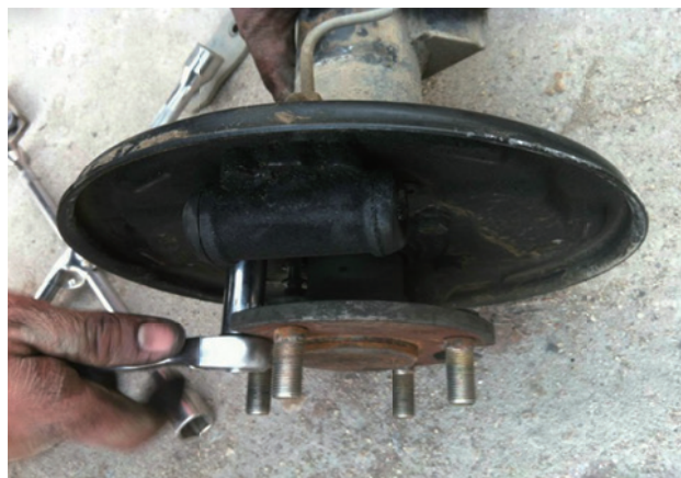
图 2-6-23 拆除后固定板固定螺丝
