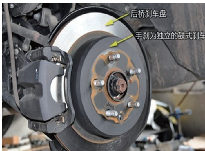
图 5-4-5 带有鼓型驻车制动系统的后盘式制动器的拆卸操作
