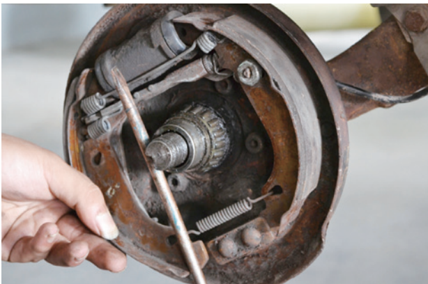
图 5-4-7 鼓式制动器的拆下
