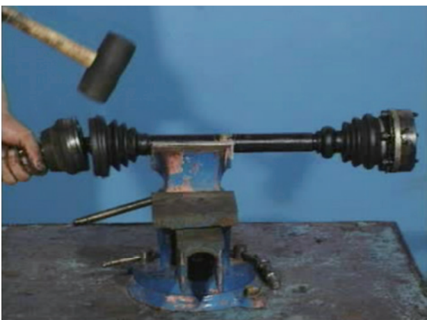
图 2-6-14 拆下外球笼防尘罩卡子
