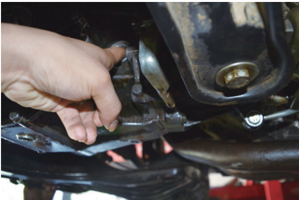
图 2-6-4 将手指插入加油口能探到油面
