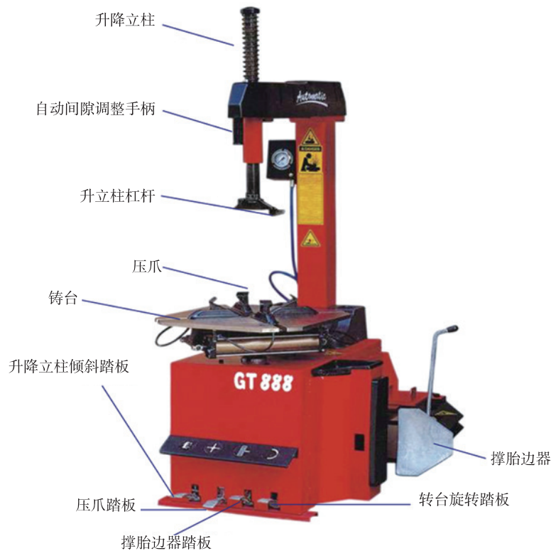
图 3-6-8 换胎机的结构
