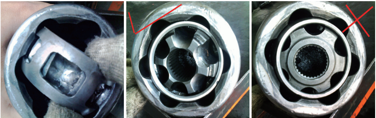
图 2-6-19 外球笼的内星轮的安装
