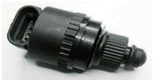
图 3-2-7 四线步进电机怠速控制阀
