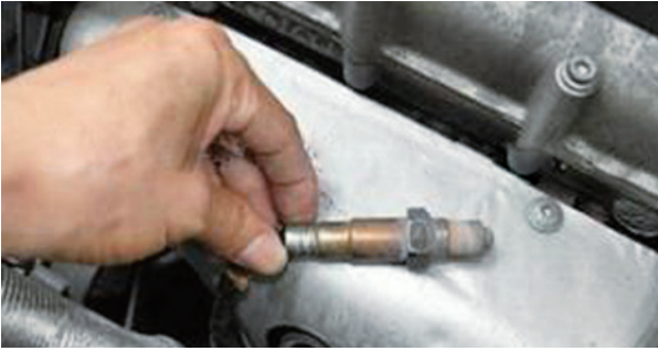
图 3-3-43 正常氧传感器颜色
