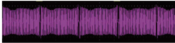
图 2-3-9 60-2 齿曲轴位置传感器波形
