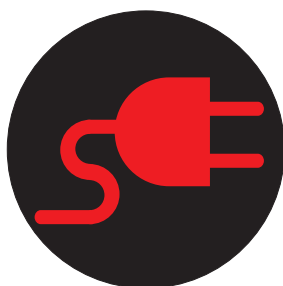
图 10-1-7 充电线连接指示灯
