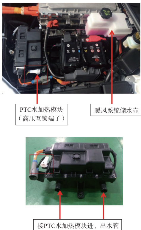
图 8-2-16 PTC 水加热模块和供暖系统储水壶
