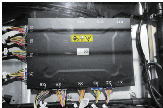
图 3-5-3 电池控制单元
