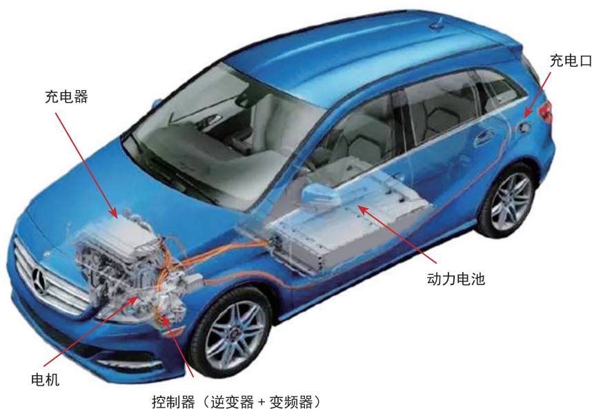
图 1-1-2 纯电动汽车高压驱动系统
