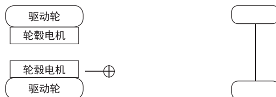
图 1-2-12 轮毂电机前驱动布置形式
