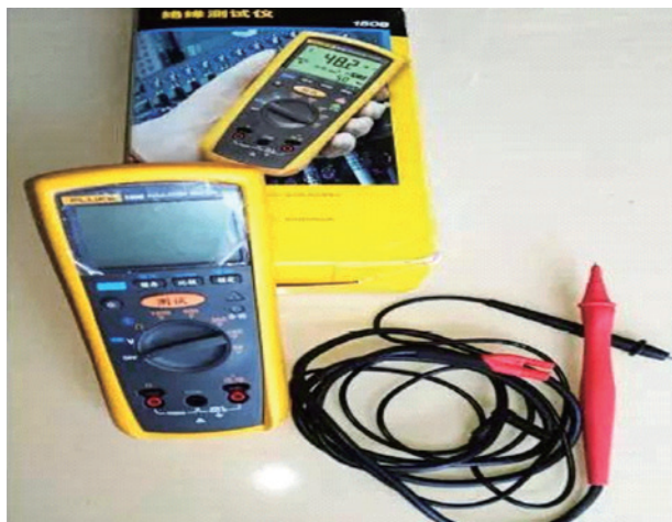
图 2-1-9 FLUKE1587C 型兆欧表
