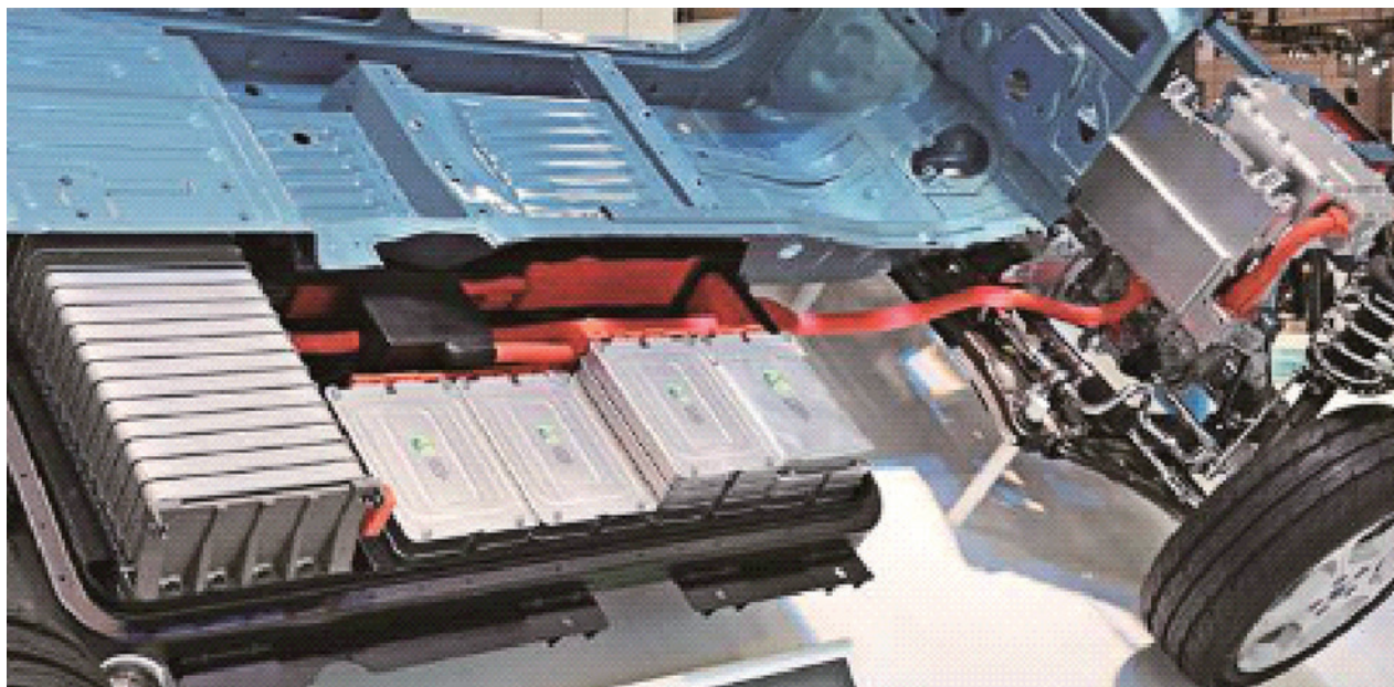
图 2-2-9 电动汽车的高压线路连接
