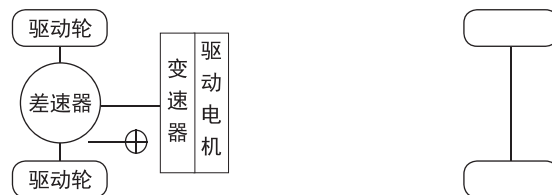
图 1-2-10 电机 - 变速器一体化前驱动布置形式
