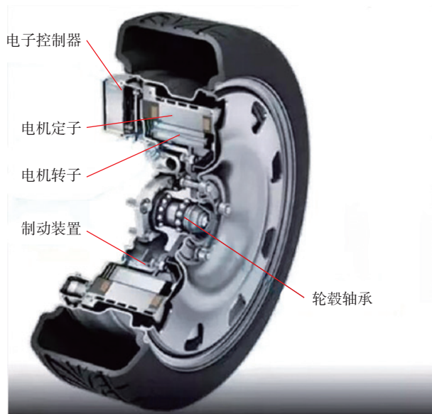
图 4-7-3 内转子式轮毂电机结构
