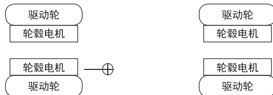
图 1-2-14 轮毂电机四轮驱动布置形式
