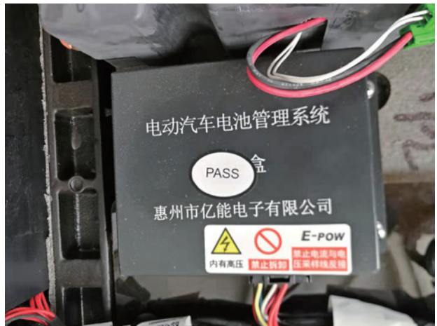
图 2-3-11 北汽分体式高压系统电池管理系统模块
