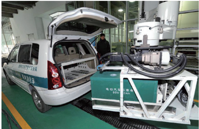
图 6-1-9 利用换电机器人为电动汽车更换电池
