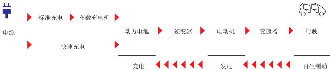
图 9-1-1 电动汽车能量转换图
