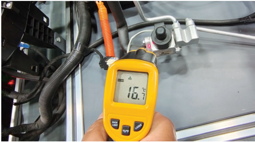
图 2-1-22 膨胀阀出口温度
