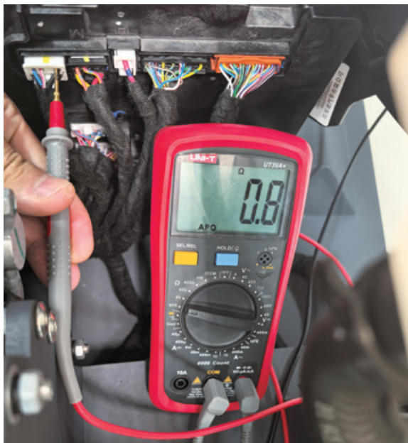
图 5-3-12 集成式控制器搭铁测量
