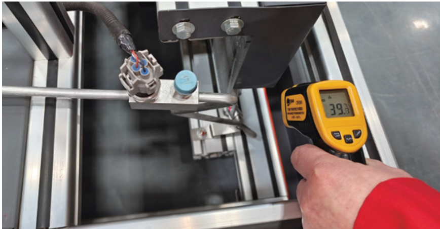
图 2-1-20 冷凝器出口温度
