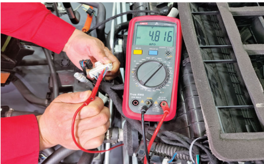
图 4-2-24 G22 插头 21 号端子电压测量
