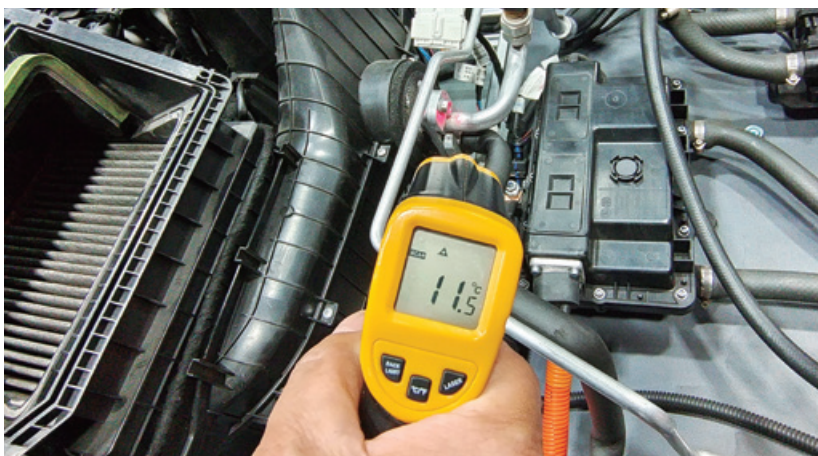
图 2-1-24 蒸发箱出口温度
