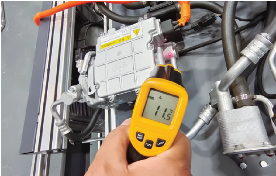
图 2-1-17 压缩机进口处温度
