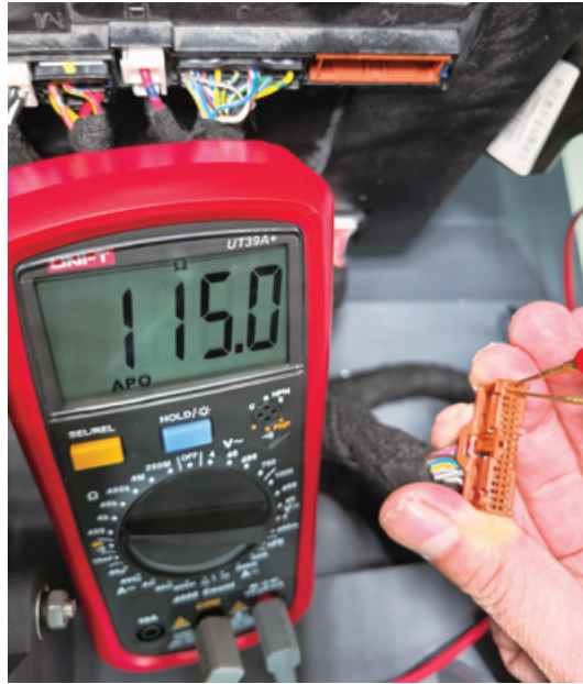
图 5-3-14 通信端子阻值测量
