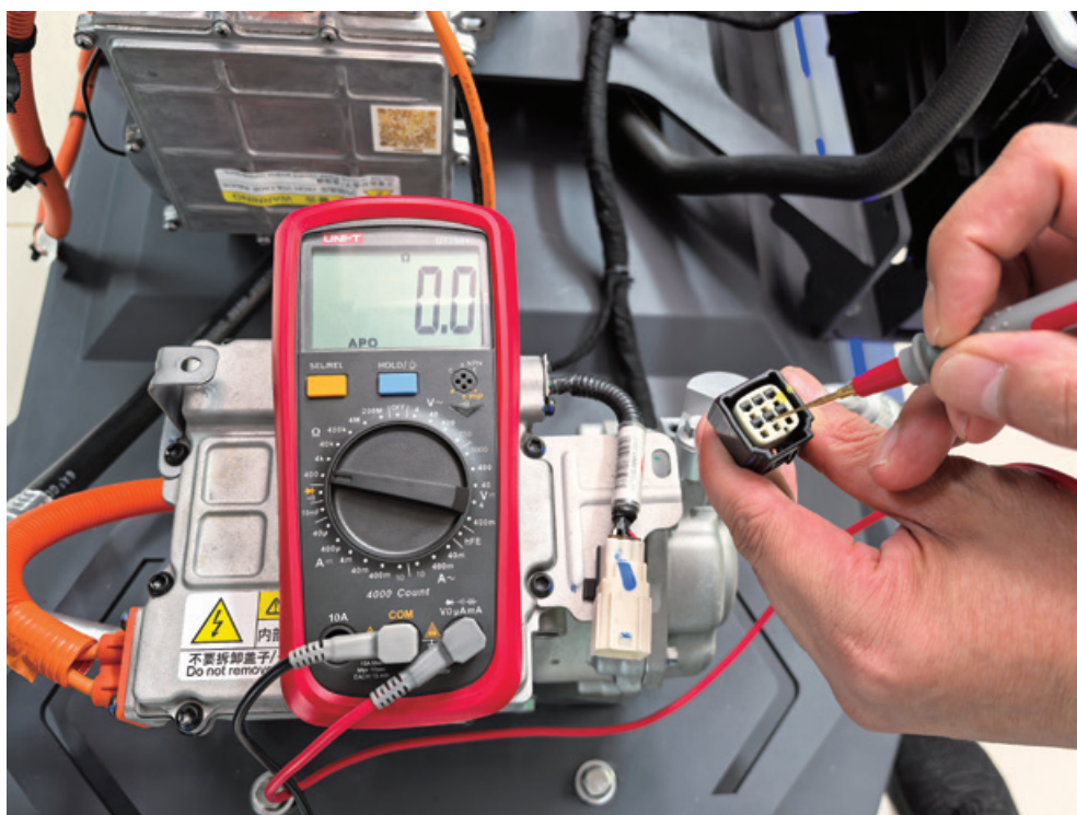
图 2-2-10 电动压缩机搭铁检测
