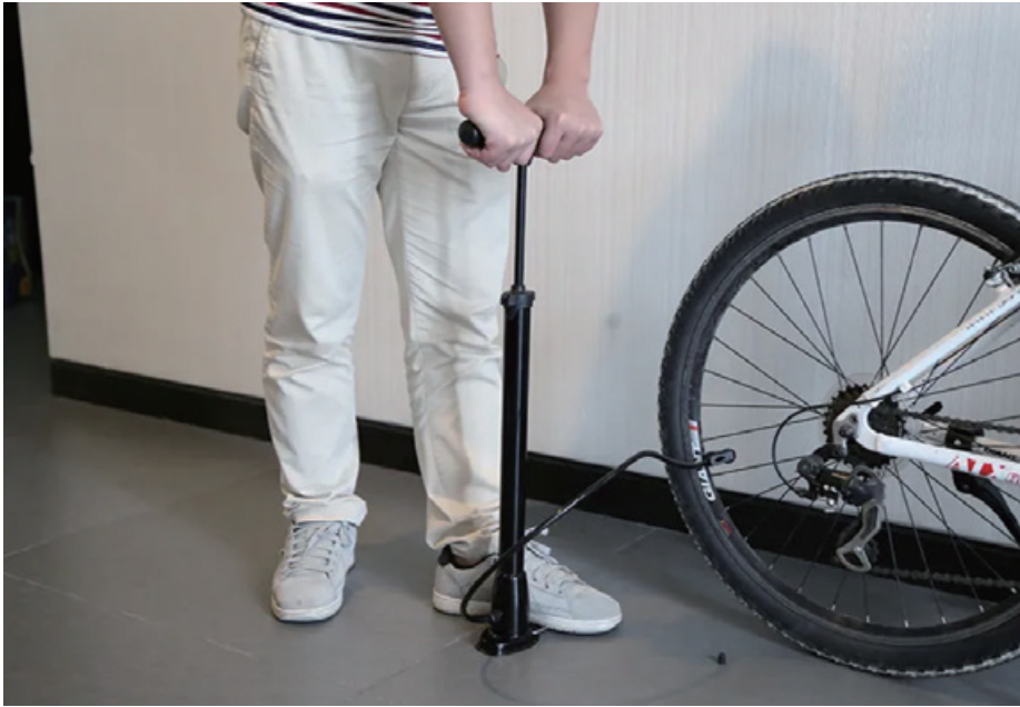
图 2-1-4 使用打气筒打气时其底部温度升高
