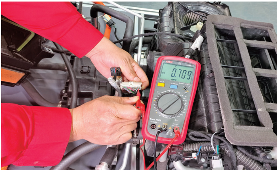
图 4-2-25 G22 插头 16 号端子电压测量
