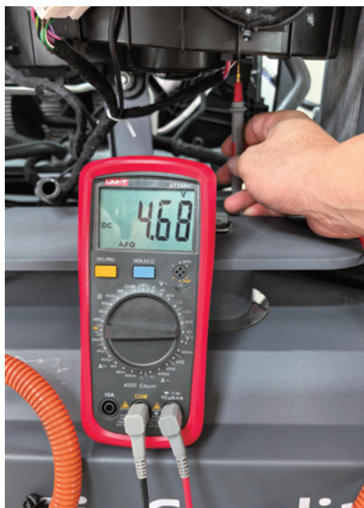
测量鼓风机调速模块 G24 插头的 3 号端子电压（高速）
