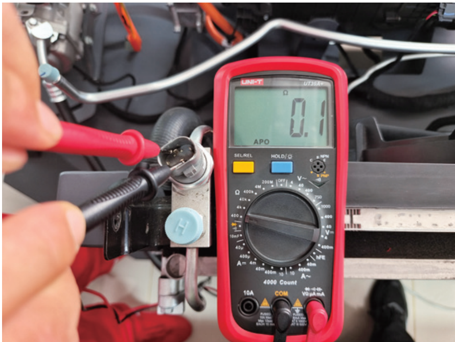
图 5-1-13 空调开关 1、4 号端子之间的阻值测量
