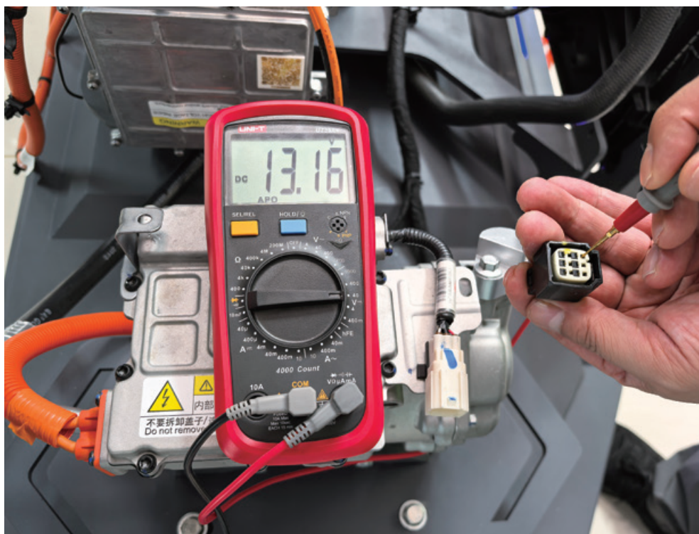
图 2-2-9 电动压缩机电源端子测量
