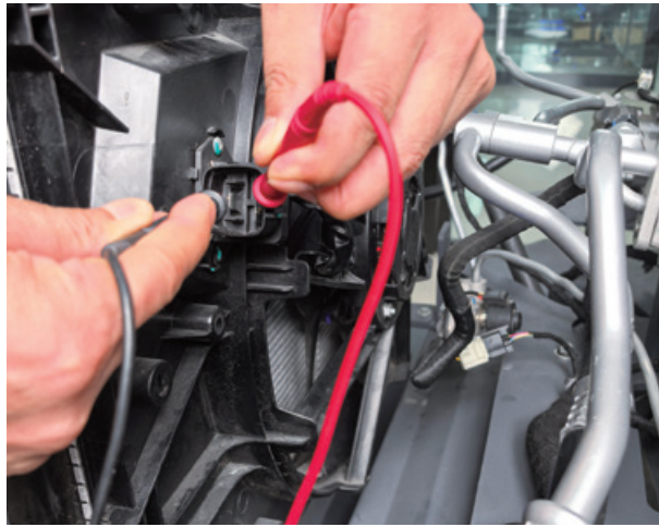
图 2-3-29 双速风扇低速供电测试
