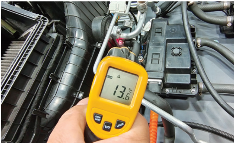
图 2-1-23 蒸发箱进口温度
