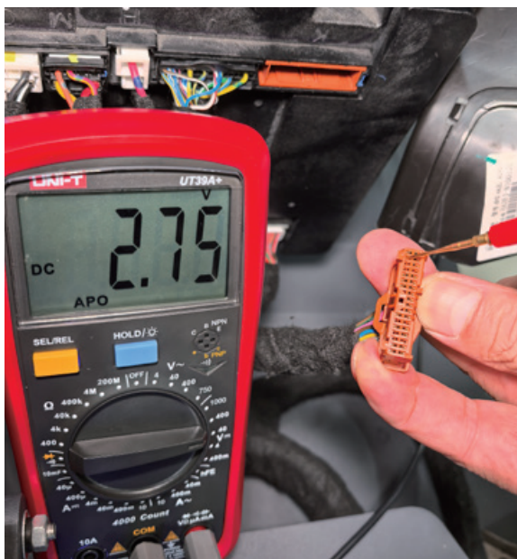
图 5-3-13 集成式控制器数舒适网通信测量
