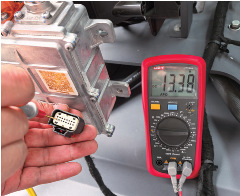
图 3-1-12 PTC 驱动器的电源测量
