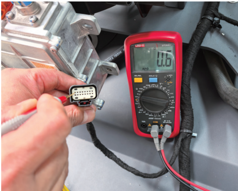
图 3-1-13 PTC 驱动器地线测量
