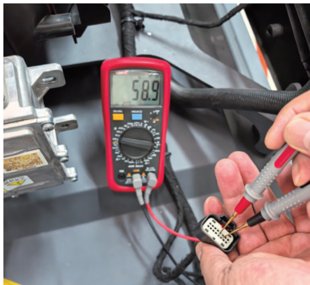
图 3-1-15 PTC CAN 线通信测量
