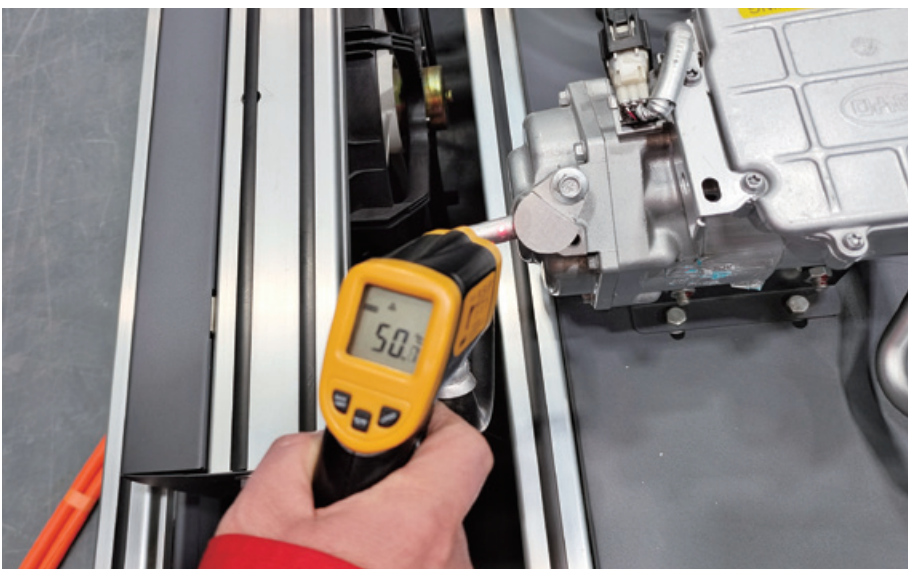
图 2-1-18 压缩机出口处温度
