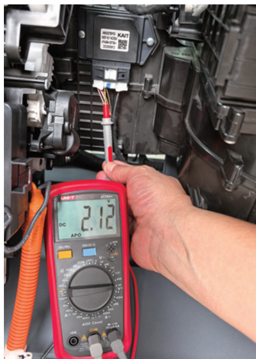
测量鼓风机调速模块 G24 插头的 3 号端子电压
