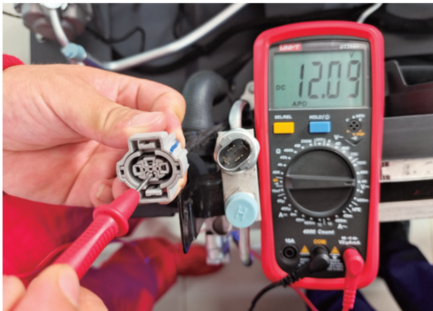
图 5-1-15 空调压力开关电源电压测量
