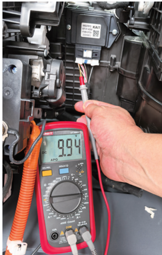
测量鼓风机调速模块 G24 插头的 4 号端子电压
