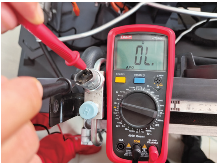
图 5-1-14 空调开关 2、3 号端子之间的阻值测量
