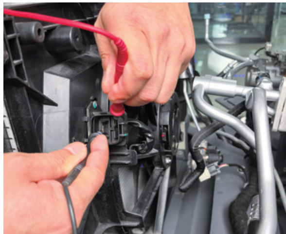
双速风扇高速供电测试
