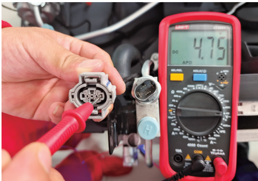
图 5-1-16 空调压力开关接地测量
