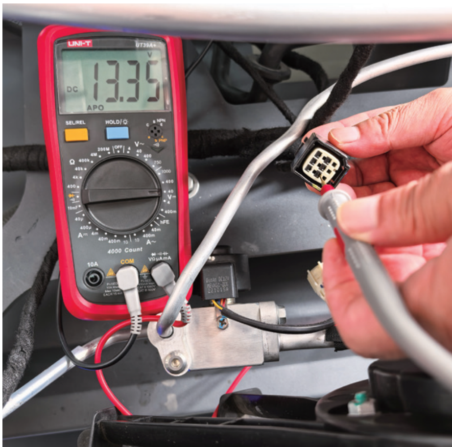
图 2-4-17 B54 (A) 插头的 3 号端子测量
