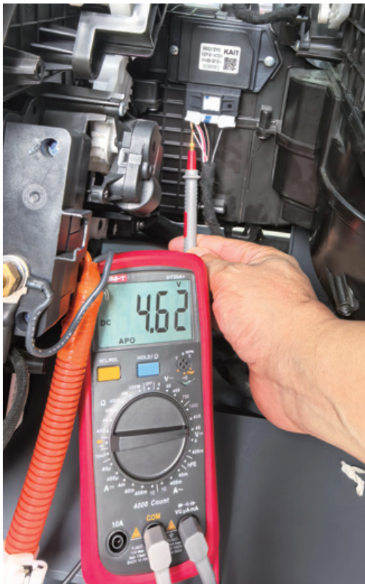
测量鼓风机调速模块 G24 插头的 4 号端子电压（高速）
