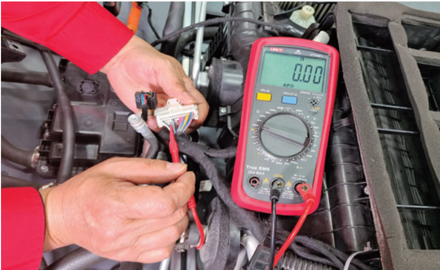
图 4-2-23 G22 插头 11 号端子接地测量
