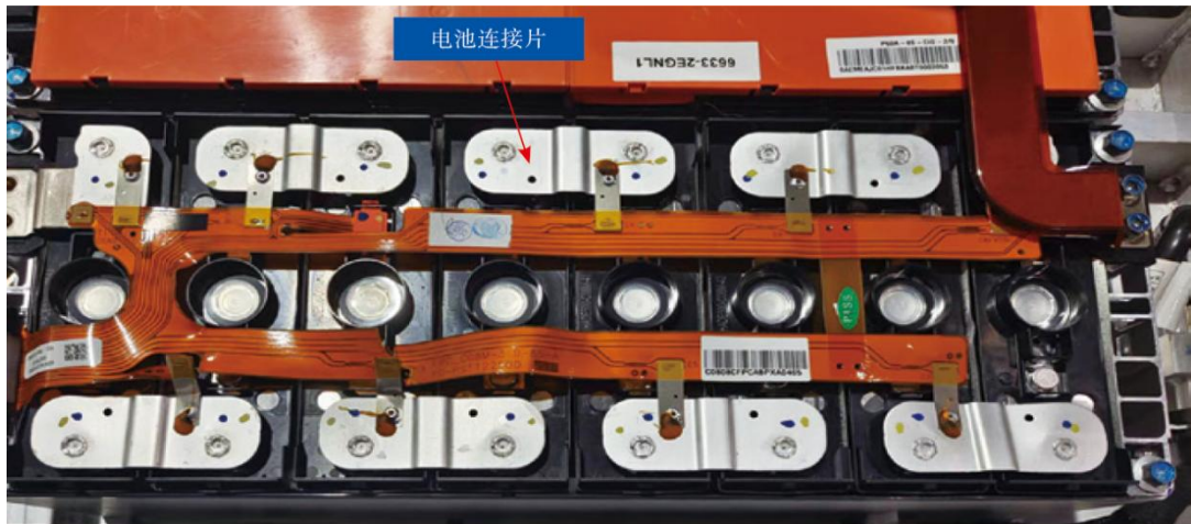
图1-29 单电池串联的蓄电池模组
