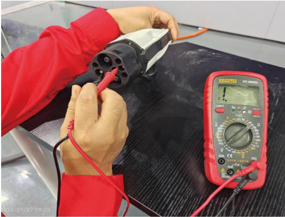
图4-35 CC1和PE之间的阻值（按下开关）
