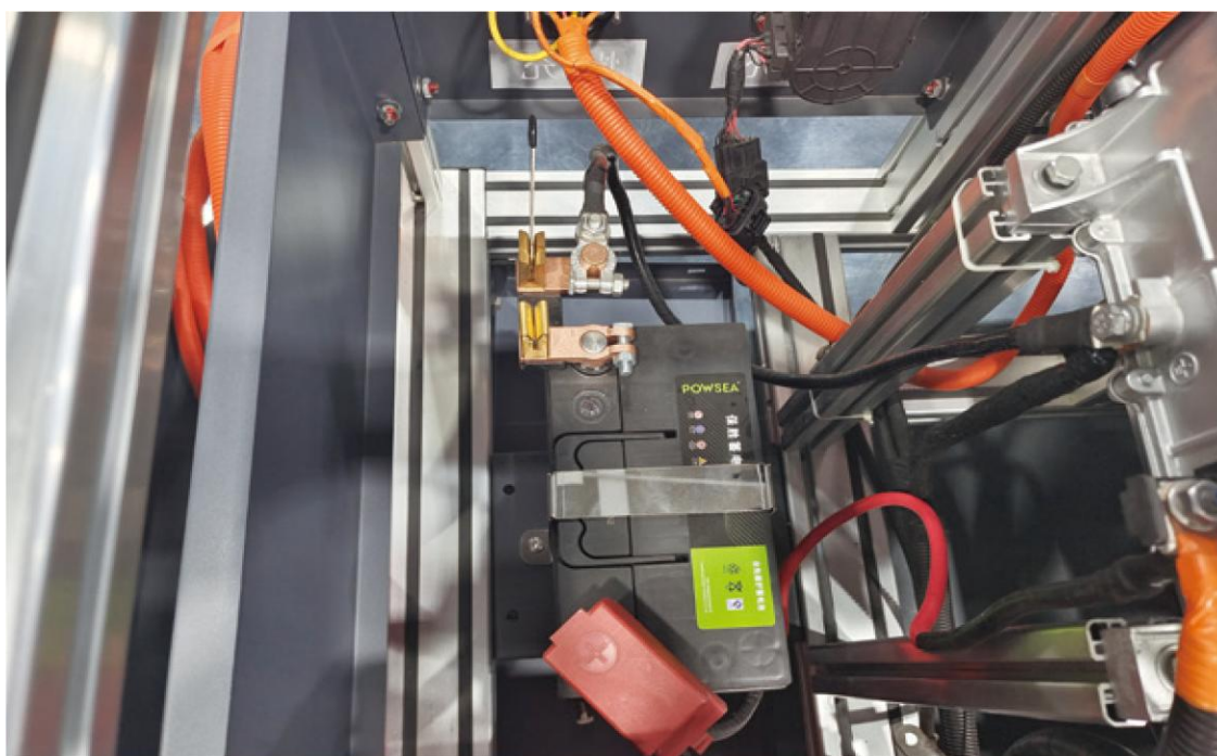
图2-17 断开低压蓄电池电源
