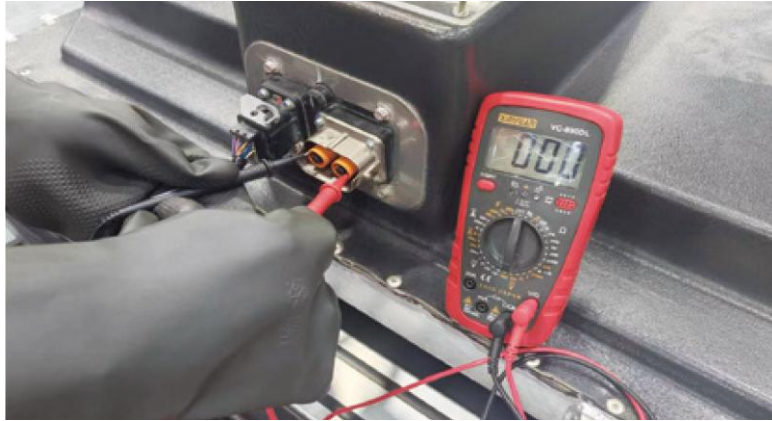
图2-32 互锁线路断开无高压输出（动力蓄电池侧）
