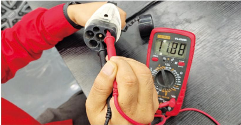
图4-19 测量车端充电枪CP与PE之间的电压
