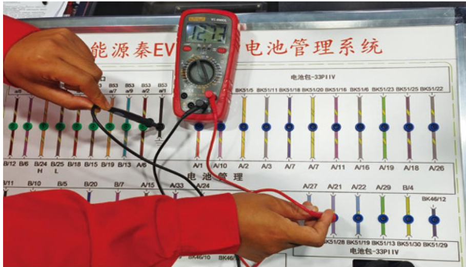
图1-66 上电后BK45A插头22号端子电压故障电压
