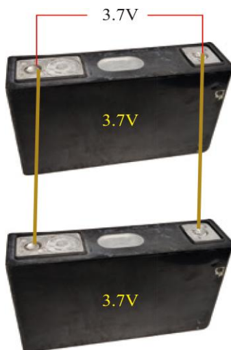
图1-3 单体蓄电池并联电压
