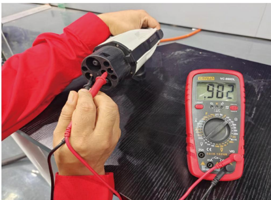
图4-34 CC1和PE之间的阻值（未按开关）
