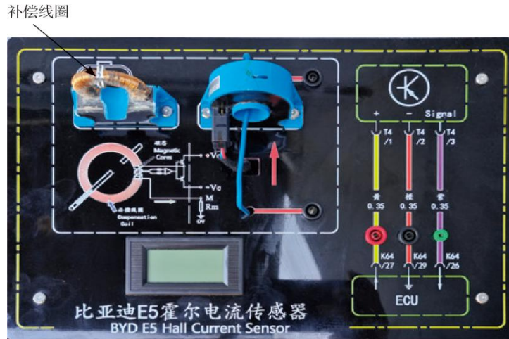
图3-17 霍尔式电流传感器
