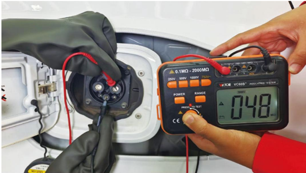
图4-39 测量快充口DC+绝缘电阻
