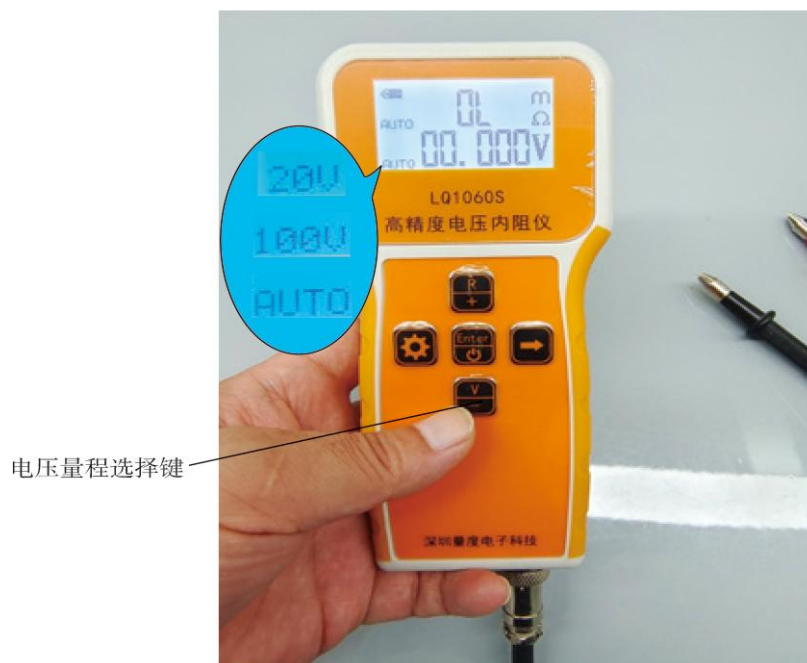
图1-10 电压量程的选择
