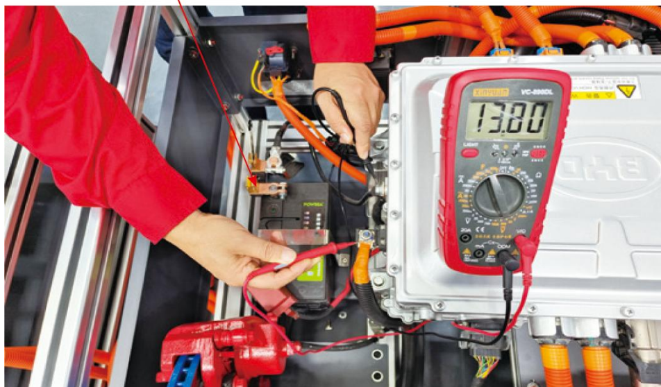
图4-55 上电后DC/DC变换器电压测量
