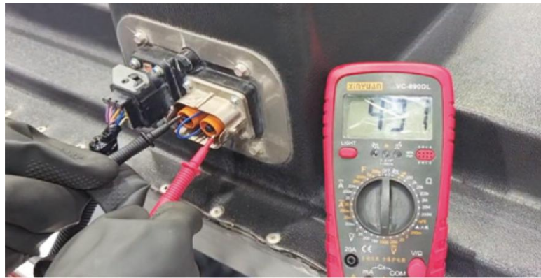
图2-33 模拟互锁线路联通有瞬间高压输出（动力蓄电池侧）
