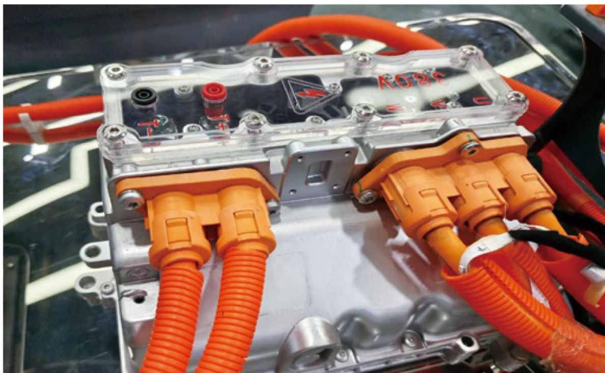
图2-16 螺栓固定插头
