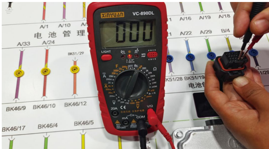
图2-36 BK45 (B) 插头4、5号端子连通性测量
