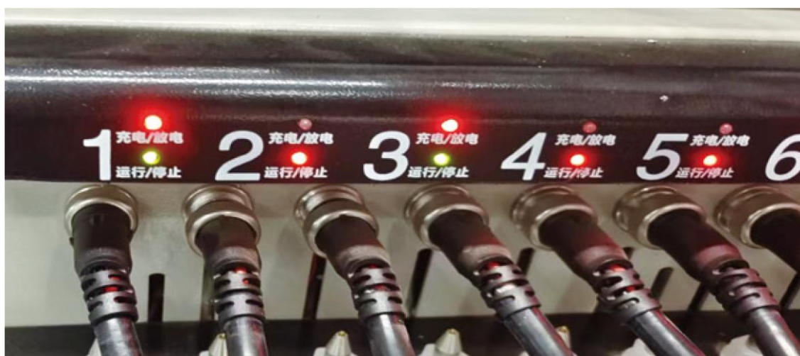
图1-20 充电和截止屏幕显示指示灯显示
