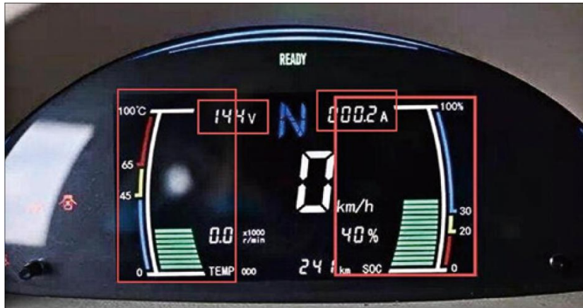
图3-36 实时电压、电流、温度信息、蓄电池剩余电量信息的显示
