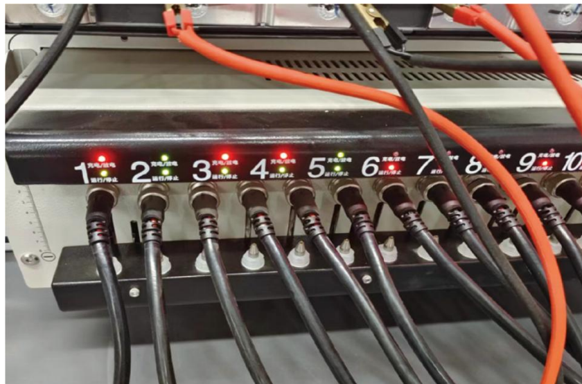
图3-33 均衡过程中仪器屏幕显示和指示灯状态
