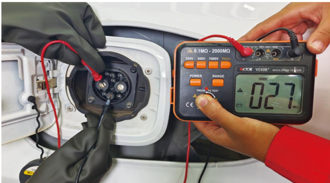
图4-40 测量快充口DC-绝缘电阻
