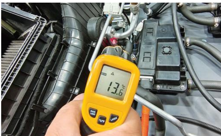
(8) 蒸发箱出口温度测量
