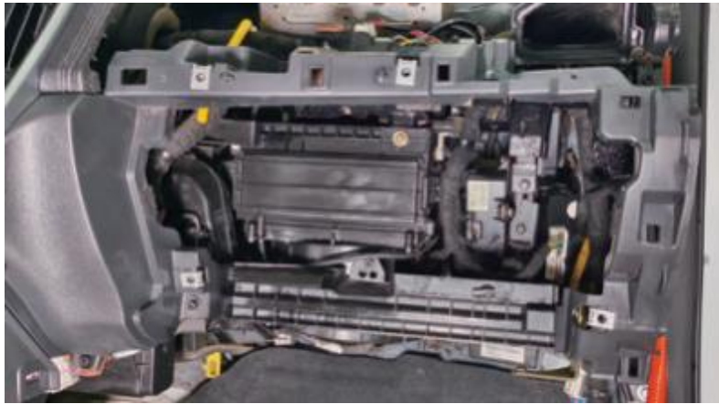
(2) 拆下滤芯盖板
